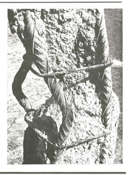
Ensayo de pilares a compresión centrada
