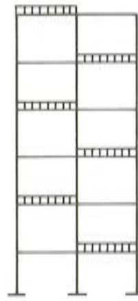
Fig. 5.2. Edificio A, carga alternada
