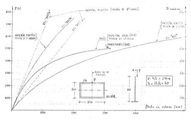
Fig. 16. Confrontación de resultados del método propuesto en este estudio y del análisis elástico.
