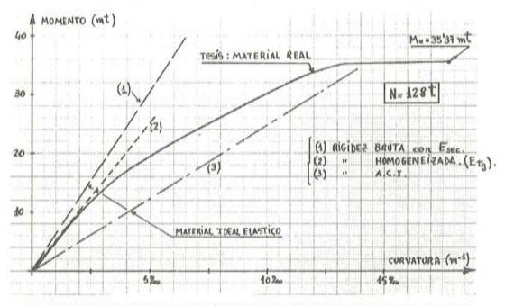
Fig. 3. Relación que liga el momento actuante de la sección de hormigón armado con la curvatura que ésta adopta.
