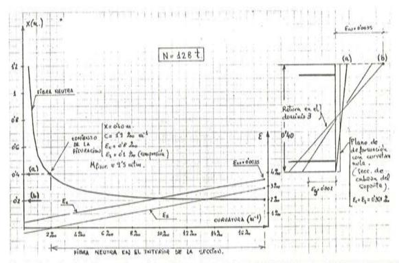
Fig. 5. Variación de la fibra neutra y de las deformaciones en la armadura más traccionada y en la fibra más comprimida del hormigón al crecer hasta rotura las curvaturas, para un axil constante prefijado.
