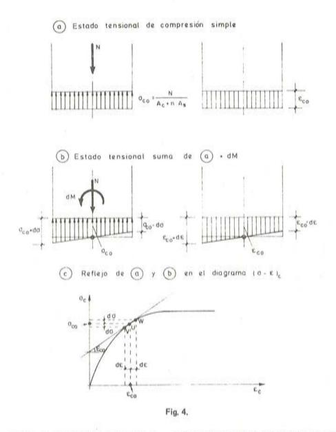
La aparición de un flector elemental,  $d_M$ , conduce a un plano de deformaciones (figura 4-b), caracterizado por los valores en las fibras extremas ( $\epsilon_{c0} + d\epsilon$ ,  $\epsilon_{c0} - d\epsilon$ ) y una ley de tensiones con valores extremos ( $\sigma_{c0} + d\sigma$ ,  $\sigma_{c0} - d\sigma$ ). Los puntos U, V y W representan (figura 4-c) los estados de tensión-deformación de las tres fibras: Directriz, extremo más comprimido y extremo menos comprimido.
