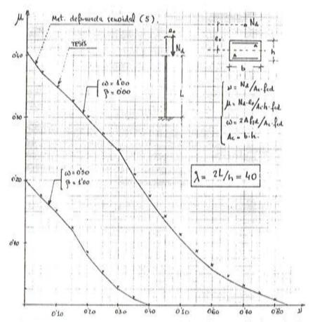
Fig. 17. Diagramas de interacción para soportes esbeltos. Comparación de resultados que proporciona el método de la deformada senoidal y el propuesto en este estudio.
