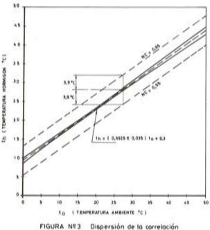
La correlación hallada implica que a 0°C el hormigón tiene una temperatura muy superior a ésta, lo que debe atribuirse a que los componentes están almacenados con temperaturas apreciablemente mayores que las supuestas en el ejemplo inicial (t<sub>C</sub> = 30°C, t<sub>A</sub> = 0°C y  $t_W = 10^{\circ}C$ ).
