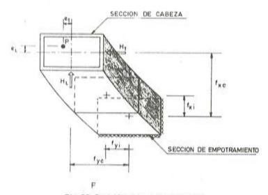
Fig. 20. Posición deformada de la pila.
