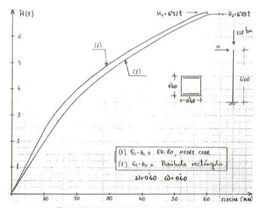
Fig. 10. Intluencia del diagrama ( $\sigma_{\mathrm{c}} - \epsilon_{\mathrm{c}}$ ) del hormigón.
