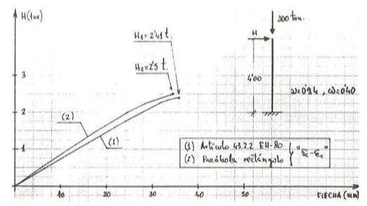
Fig. 11. Influencia del diagrama ( $\sigma_{\mathrm{c}} - \epsilon_{\mathrm{c}}$ ) adoptado para el hormigón.
