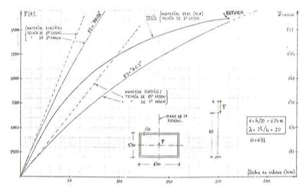
Fig. 15. Confrontación de resultados del método propuesto en este estudio y del análisis elástico.
