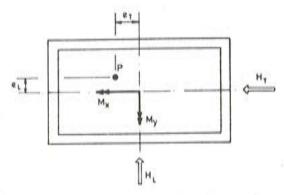
Fig. 19. Cargas actuantes en la sección de cabeza de la pila: una fuerza vertical P, con excentridades  ${\bf e_T}$  y  ${\bf e_L}$  y unas fuerzas horizontales  ${\bf H_T}$  y  ${\bf H_L}$
