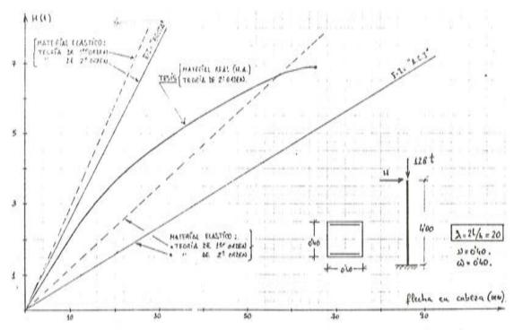
Fig. 14. Controntación de resultados del método propuesto en este estudio y del análisis elástico.
