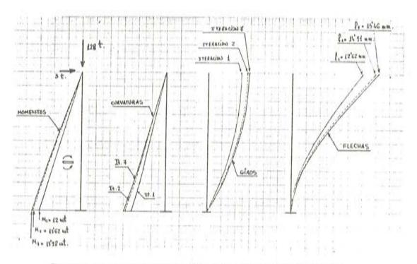
Fig. 6. Proceso iterativo de obtención de la deformada de una pila en ménsula.
