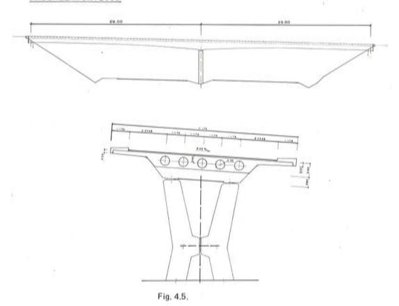
En el caso del puente del enlace de la Magdalena las condiciones funcionales son más estrictas por el hecho de estar el puente ubicado en desmonte y contar con la presencia de una vía lateral de acceso situada junto a la autopista. Este hecho determina una falta de definición armónica de las luces que hemos intentado resolver realizando un dintel con muy poca variación de canto. Figura 4.2, 4.3.
