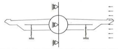
g ) SUSPENSION DE FLEXION (1GRADO DE LIBERTAD - DESPLAZAMIENTO VERTICAL)
