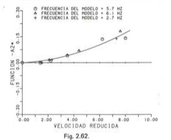
En los ensayos de torsión se observó que la frecuencia de vibración en presencia de viento coincidía prácticamente con la frecuencia natural del modelo, pero no se pudo medir esa diferencia. Dado que la función A<sub>3</sub> es
