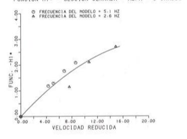
FUNCION HI\* - SECCION ABIERTA - ALFA = -5 GRADOS
