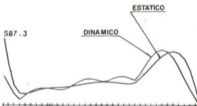
Fig. 2.76. Leyes de momentos flectores máximos estáticos y dinámicos para la mitad Norte del dintel.
