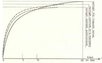
nes y temperaturas prefijadas y establecidas en el tablero de comando, produce en el pastón cementicio, una elevación de temperatura que puede llevar a la mezcla en preparación hasta los 80°C. Esta elevación de la temperatura no produce ningún efecto nocivo en el hormigón, beneficiándolo con una mayor resistencia final, en comparación con un hormigón curado a vapor, que puede ascender hasta un 7% más.
