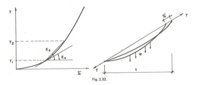
La relación entre carga T y desplazamiento  $\delta$  de un tirante, Figura 2.32, es una curva que sólo es lineal para valores altos de la carga T. La expresión del módulo de elasticidad virtual a un determinado nivel de carga T, viene dado por la fórmula de Ernst.
