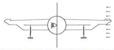
c ) SUSPENSION DEL MOVIMIENTO ACOPLADO FLEXION-TORSION (2 GRADOS DE LIBERTAD = DESPLAZAMIENTO VERTICAL + GIRO)
