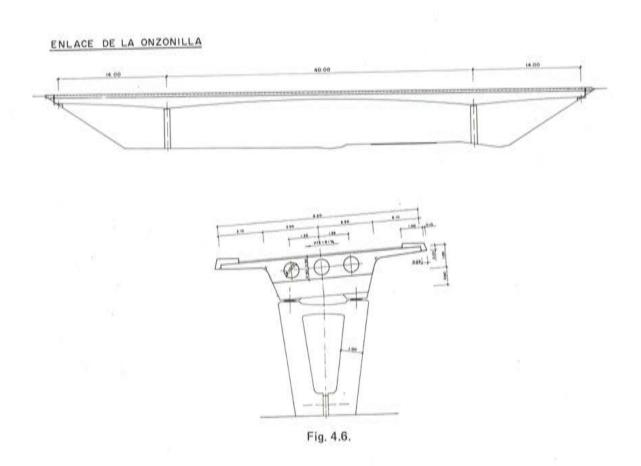
Para los primeros hemos adoptado una forma de "H" con ramas inclinadas. En los otros dos, una pila trapecial con aligeramiento interior.
