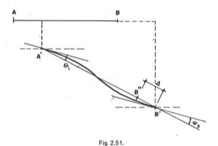
Sea AB la posición de la barra antes de la deformación de la estructura y A' B' la situación de la barra deformada. Podemos hacer una traslación sin deformación de la barra AB a A' B" y obtenemos los corrimientos  $\Delta_1$ ,  $\theta_1$ , y  $\theta_2$  que nos proporcionan, por los procedimientos habituales, los esfuerzos en los nudos al pasar la barra de A'B" a A'B'.
