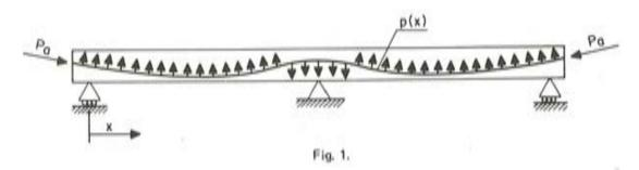
Este sistema tiene la propiedad de que es autoequilibrado. Para calcularlo se precisa establecer, en las coordenadas intrínsecas de la curva correspondiente al trazado, la relación entre la fuerza de pretensado P de la armadura y las componentes unitarias tangencial t y normal n de la fuerza repartida p.
