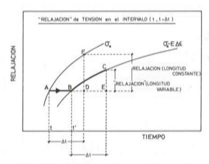
Fig. 1. Predicción de la "relajación" en el intervalo (t, t  $\pm \Delta$ t), cuando la longitud del tendón varía  $\Delta e$  en el instante t. Método del tiempo equivalente (5).
