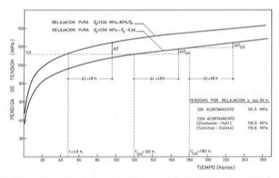
Fig. 3. Cálculo de las pérdidas por "relajación" a las 96 horas cuando a las 48 horas el tendón se acorta  $\Delta \epsilon = 0.00019$ .
