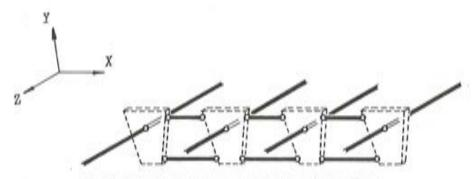
Fig. 25. Esquema de un plano vertical de arriostramiento.
