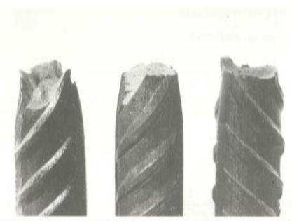
Fotograf îa 1, Tipos de rotura de probetas corrugadas de acero AEH-400N a temperatura ambiente, -80° y -165°C.
