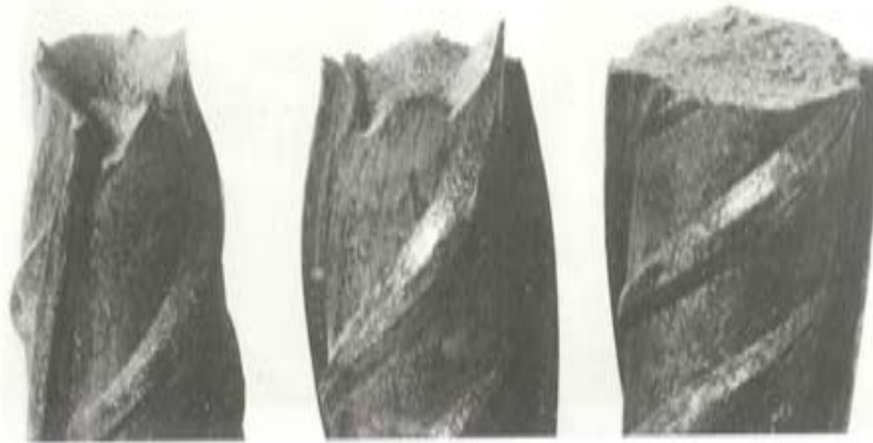
Fotografía 4. Tipos de rotura de probetas corrugadas de acero AEH-400F a temperatura ambiente, -80^{\circ}\text{C} y -165^{\circ}\text{C} .
