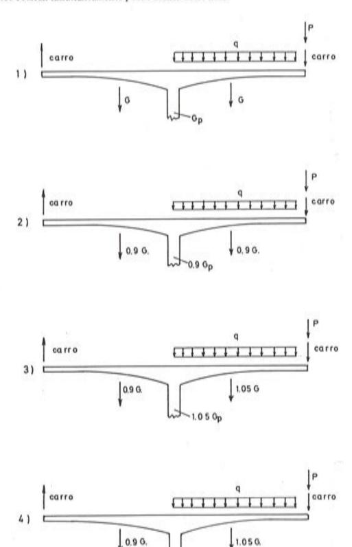
Fig. 4. Hipótesis excepcional de caída de un carro de avance,  $\gamma_t = 1,00$ . Diferentes posibilidades,
