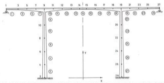
Fig. 14. Discretización del viaducto definido en la figura 5 para su análisis elástico con el programa RETPLAN.
