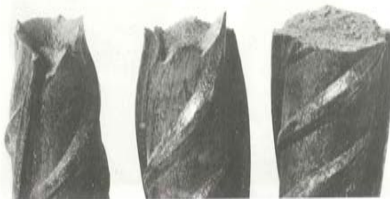
Fotografía 4. Tipos de rotura de probetas corrugadas de acero AEH-400F a temperatura ambiente, -80^{\circ}\text{C} y -165^{\circ}\text{C} .
