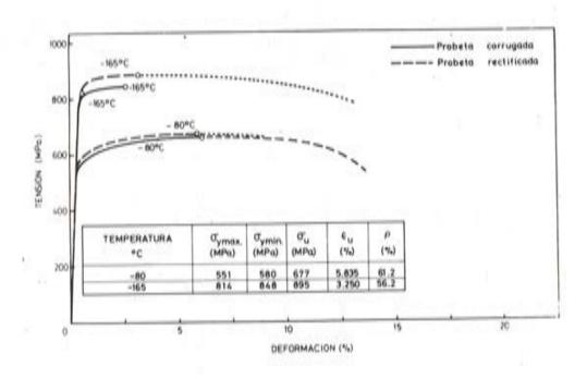
Fig. 7. Curvas tensión-deformación de probetas rectificadas de acero AEH-400F a  $-80^{\rm o}$ C y  $165^{\rm o}$ C.
