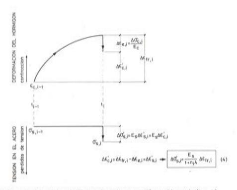
Fig. 5. Cálculo esquemático de las pérdidas por fluencia y retracción en el intervalo (t<sub>j. 1</sub>, t<sub>i</sub>).
