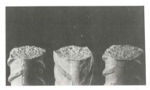
Fotografía 3. Tipos de rotura de probetas entalladas de acero AEH-400N a -165°C.
