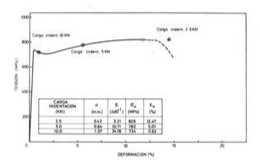
Fig. 5. Comportamiento de probetas entalladas de acero AEH-400N a - 165°C.
