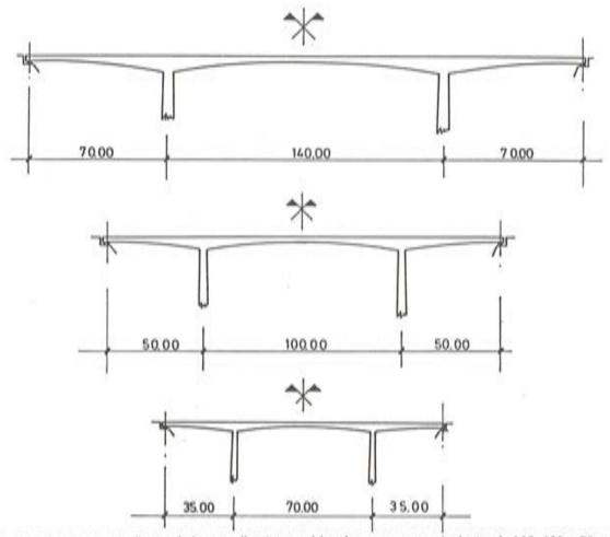
Fig. 16. Alzados longitudinales de los tres dinteles considerados, con vanos principales de 140, 100 y 70 m.
