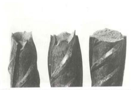
Fotografía 4. Tipos de rotura de probetas corrugadas de acero AEH-400F a temperatura ambiente, -80°C y -165°C.
