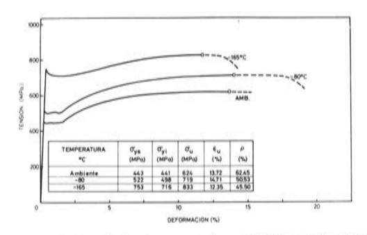
Fig. 3. Curvas tensión-deformación de probetas corrugadas de acero AEH-400N a temperatura ambiente, -80°C y -165°C.
