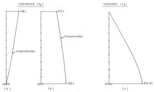
Fig. 13. Esfuerzos transversales en la pila de 120 m. de altura, en el caso de carga en que existe la última do vela de un voladizo en desequilibrio y actúa un viento transversal al viaducto.
