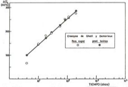
Figura 5. Pérdidas diferidas por efecto combinado de la retracción y fluencia del hormigón y relajación del acero. Comparación de los resultados experimentales (Ref. 5) y las predicciones teóricas basadas en la Ref.1.
