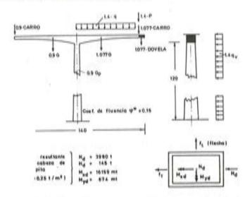
HIPOTESIS: Existencia de la última dovela en desequilibrio y actuación del viento. ERROR DE VERTICALIDAD: 2 mm/m, en las dos direcciones principales. Factor de minoración por simultaneidad de acciones de diferente naturaleza: 0,90.
