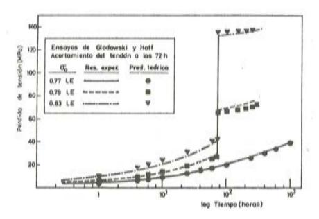
Figura 3. Pérdidas por relajación, con una variación brusca de la longitud del tendón a las 72 horas. Comparación de los resultados experimentales (Ref. 3) y las predicciones teóricas basadas en la Ref. 1.
