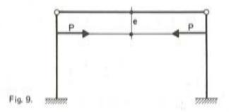
La clave de este asunto se encuentra en si la estructura es o no rígida entre los puntos de anclaje del pretensado. Si lo es, que es la situación más corriente (por lo que podemos entonces decir que el pretensado es normal) (1) (2), los esfuerzos isostáticos convencionales son equilibrados y, por ser inmediatos, suelen ser los más cómodos de elegir, además de que,
