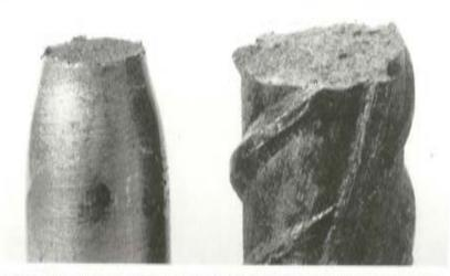
Fotografía 5. Tipos de rotura de probetas rectificadas y corrugadas de acero AEH-400F a -165°C.
