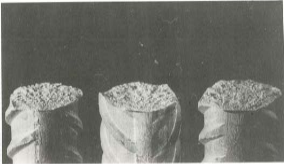
Fotografía 3. Tipos de rotura de probetas entalladas de acero AEH-400N a -165^{\circ}\text{C} .
