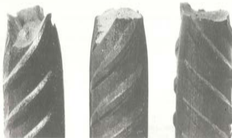
Fotografía 1. Tipos de rotura de probetas corrugadas de acero AEH-400N a temperatura ambiente, -80^{\circ}\text{C} y -165^{\circ}\text{C} .
