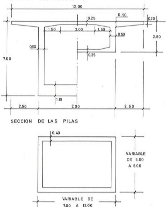
Fig. 6. Secciones del dintel y de las pilas del viaducto analizado en primer lugar y definido en la figura 5,
