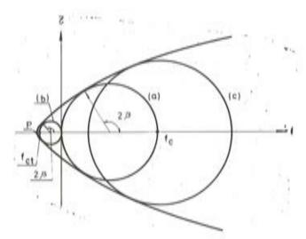
Gráfico 1. Curva de resistencia intrínseca del hormigón.
