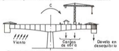
Fig. 1. Estabilidad de un tablero durante su construcción (14).
