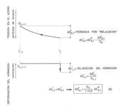
Fig. 6. Cálculo esquemático de las pérdidas por relajación en el intervalo (t<sub>i. 1</sub>, t<sub>i</sub>).
