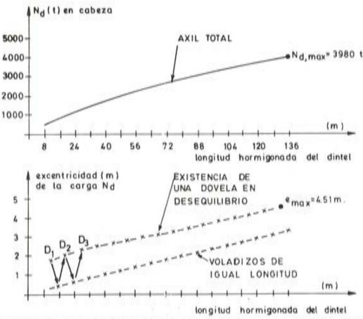
Fig. 8. Evolución de la carga axil N<sub>d</sub> y de su excentricidad en la cabeza de la pila, a lo largo del proceso constructivo del dintel.
