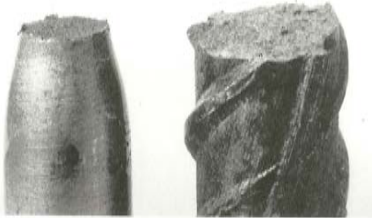
Fotografía 5. Tipos de rotura de probetas rectificadas y corrugadas de acero AEH-400F a -165^{\circ}\text{C} .
