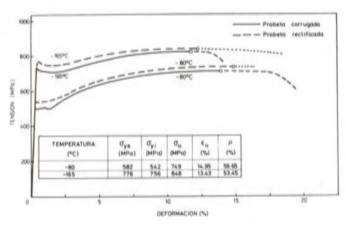
Fig. 4. Curvas tensión-deformación de probetas rectificadas de acero AEH-400N a −80°C y −165°C.
