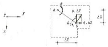
Fig. 8. Desplazamientos de N debidos al giro de A,
