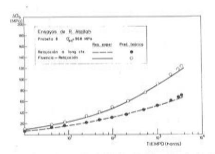
Figura 10. Pérdidas diferidas por efecto combinado de la fluencia del hormigón y la relajación del acero.Comparación de los resultados experimentales (Ref. 4) y las predicciones teóricas basadas en la Referencia 1. También se han representado los datos de la relajación del acero.
