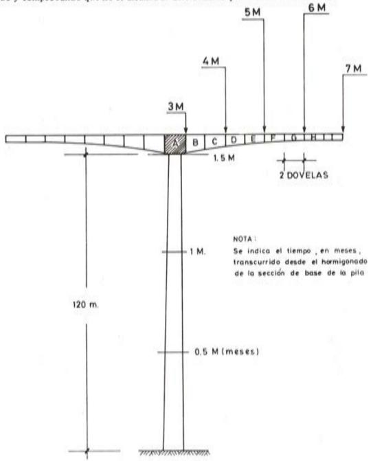
Fig. 9. Evolución en el tiempo de la construcción de una "T",
