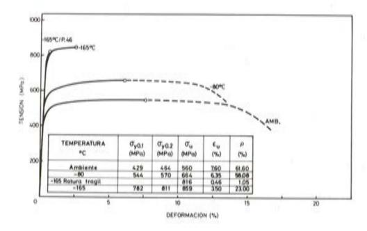
Fig. 6. Curvas tensión-deformación de probetas corrugadas de acero AEH-400F a temperatura ambiente, -80°C y -165°C.
