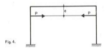
Según la estructura isostática que se tome a partir de la anterior se obtienen unos u otros esfuerzos, de forma que no siempre los esfuerzos isostáticos de la convención (M=P. e. cos  $\alpha$ ; etc.) coinciden con los que resultan en estructuras isostáticas derivadas de la original. La convención sigue siendo posible, pero ya no se ajusta siempre "literalmente" como ocurría en las vigas continuas.
