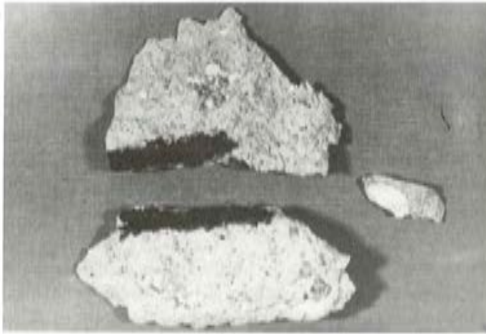
Foto 1. En esta fotografía se aprecia un fragmento del hormigón de un pilar, que se desprendió fácilmente con las manos. En la fotografía se pueden ver los restos de la armadura transformados en herrumbre y un fragmento de una concha marina.
