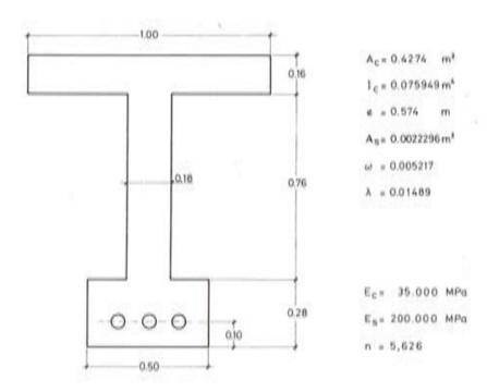
Fig. 10. Sección de hormigón pretensado considerada en el ejemplo.
