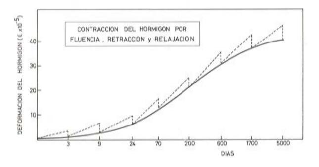
Fig. 11. Pérdidas de tensión y contracción del hormigón por efecto combinado de la fluencia y retracción del hormigón y la relajación del acero.
