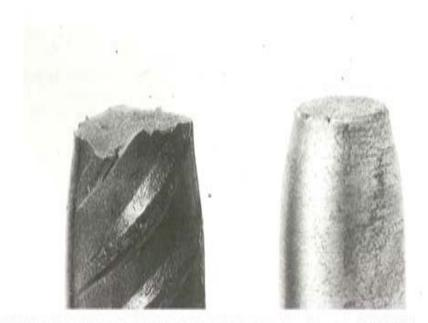
Fotografía 2. Tipos de rotura de probetas rectificadas y corrugadas de acero AEH-400N a -- 165°C.
