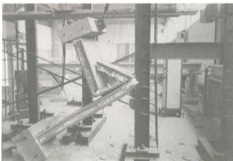
Fig. 17. Aspecto del panel C-2 ( e = 0,25 h = 3,25 \text{ cm} ) una vez que se ha producido su agotamiento resistente.
