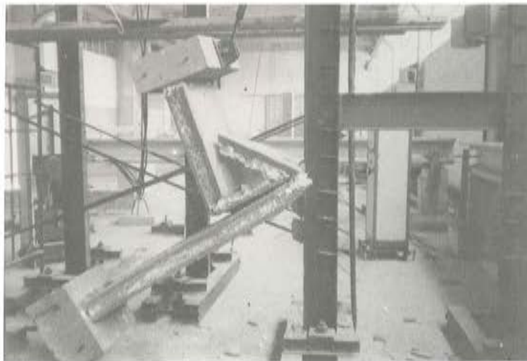
Fig. 17. Aspecto del panel C-2 ( e = 0,25 h = 3,25 cm) una vez que se ha producido su agotamiento resistente.
