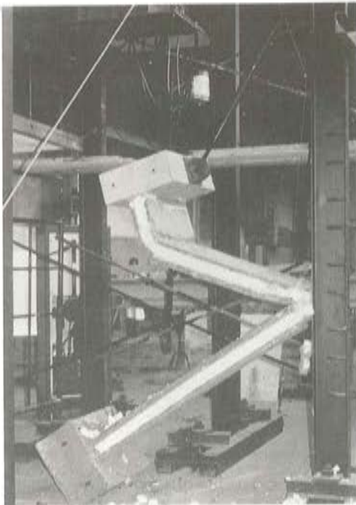
Fig. 15. Aspecto del panel B-2 ( e = 0,1 h = 1,3 \text{ cm} ) una vez que se ha producido su agotamiento resistente para P_u = 54 \text{ t} .
