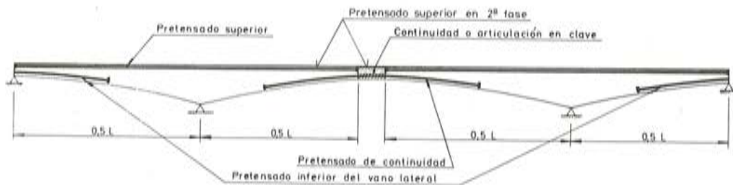
Fig. 1. Esquema de un dintel continuo de tres vanos con articulación en clave o continuidad.
