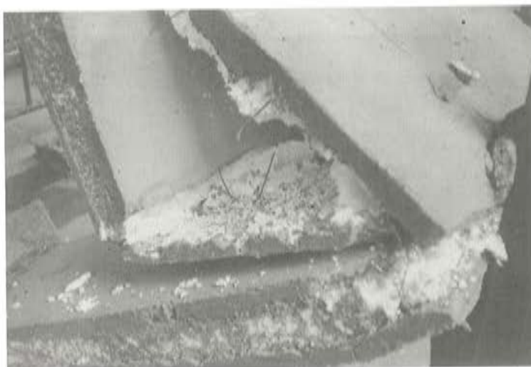
Fig. 18, Detalle de la rotura del panel C-2.
