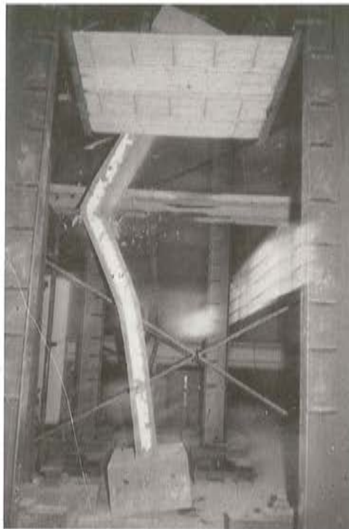
Fig. 12. Aspecto del panel A-3, sometido a carga centrada en el instante que se produce su agotamiento por inestabilidad.
