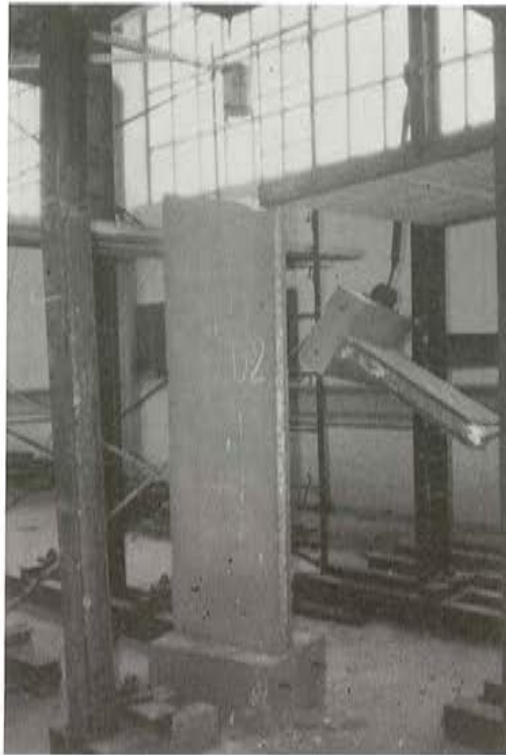
Fig. 19. Aspecto del panel D-2 ( e = 0,5 h = 6,5 \text{ cm} ) una vez que se ha producido su agotamiento resistente para P_U = 20 \text{ t} .
