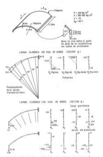
Fig. 12. Lámina cilíndrica simplemente apoyada.
