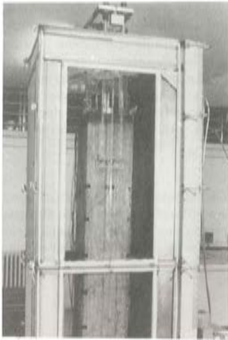
Fig. 2. Elemento estructural para el estudio de la contracción del hormigón situado dentro de la cámara criogénica. Se observan el anclaje superior del pretensado y los dilatómetros de sílice,
