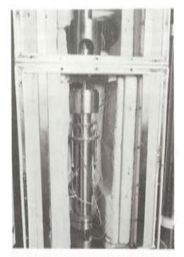
Fig. 3. Extensòmetro para cordón de pretensado.
