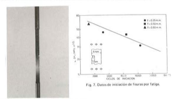
Fig. 6. Probeta para estudio de la iniciación de fisuras.
