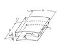
Fig. 4. Tensiones normales y tangenciales.
