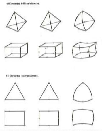
Fig. 2. Algunos elementos bi y tridimensionales para aplicación en el problema térmico.
