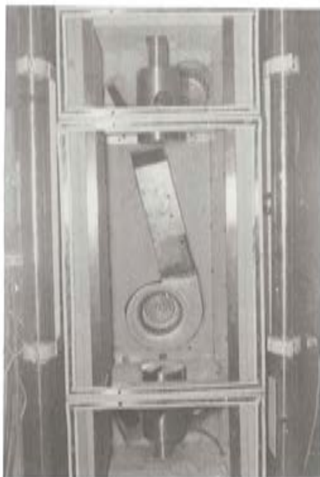
Fig. 4. Cámara criogénica de tres cuerpos utilizada para los ensayos de sistemas de pretensado y de acero de armar.
