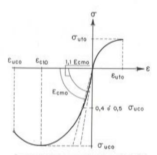
Fig. 4. Diagrama σ - ε del hormigón. Estado uniaxial.
