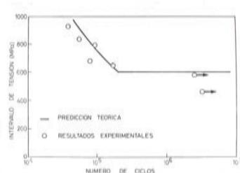
Fig. 10. Curvas de fatiga de alambre de pretensar.
