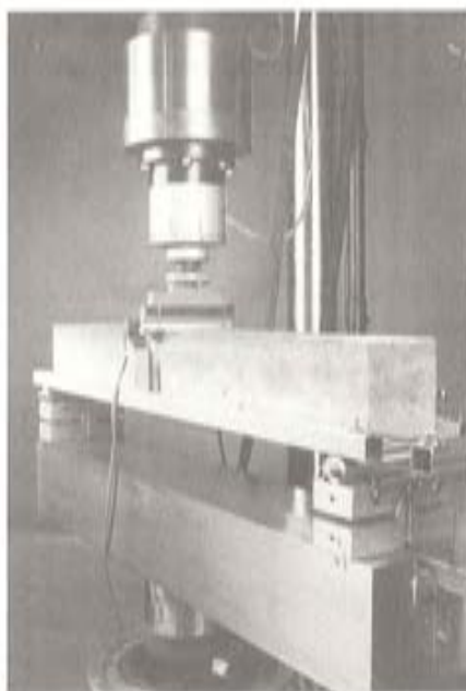
Foto 2. Sistema de medida de desplazamientos para las probetas S1.
