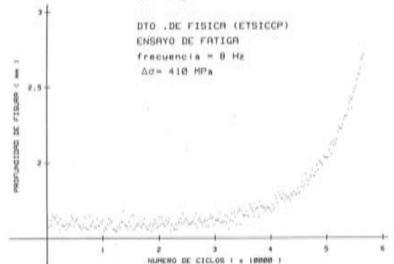
Fig. 4. Evolución de la fisura en un ensayo de fatiga.
