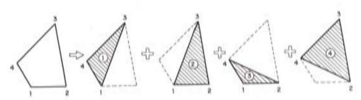
Fig. 2. Descomposición de un elemento de 4 nodos.
