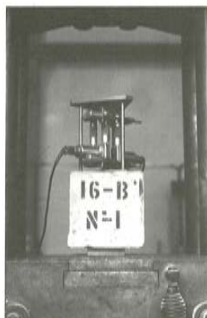
Foto 8. Montaje probeta \phi 16 (B'). Método modificado.
