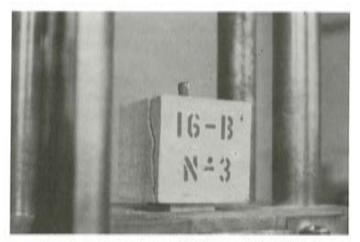
Foto 9. Rotura probeta \$\phi\$ 16 (B') con "SPLITTING".
