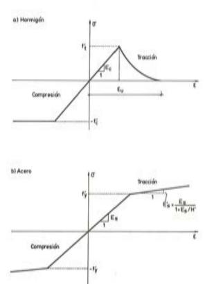
Fig. 7. Diagramas uniaxiales tensión-deformación para el hormigón y el acero.
