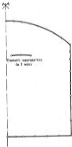
Fig. 13. Tanque de hormigón criogénico. Discretización en elementos finitos para el análisis tensional.
