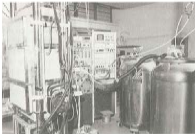
Fig. 1. Vista general del laboratorio. A la izquierda se observa una cámara criogénica colocada en la máquina de ensayo. A la derecha están las bombonas de nitrógeno licuado.
