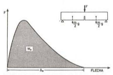
Fig. 8. Esquema del ensayo de determinación de la energía de fractura.
