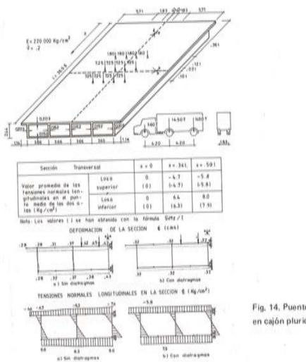
Fig. 14. Puente biapoyado de sección en cajón pluricelular.
