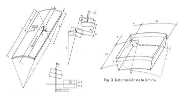
Fig. 2. Normales a la superficie de referencia antes y después de la deformación de la lámina.
