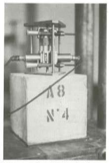
Foto 7. Montaje probeta φ 8 (A). Método normalizado.
