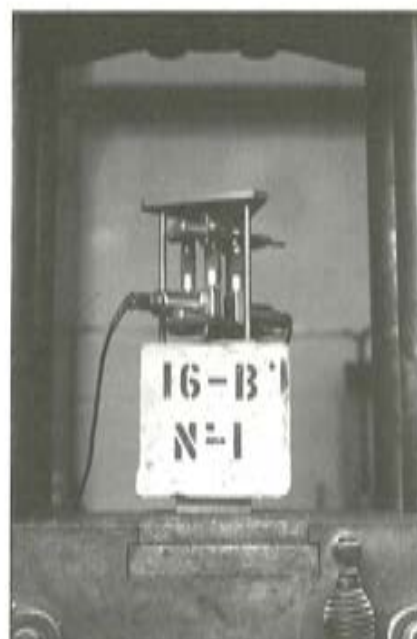
Foto 8. Montaje probeta \phi 16 (B'). Método modificado.
