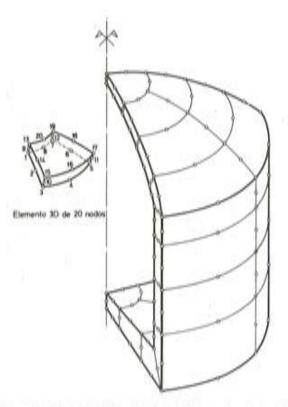
Fig. 3, Tanque de hormigón criogénico. Análisis térmico tridimensional de 1/4 de la estructura (por simetría) con elementos de 20 nodos.
