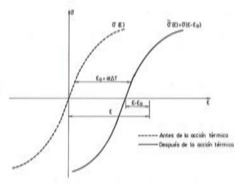
Fig. 14. Desplazamiento de la curva tensión-deformación producida por la temperatura.
