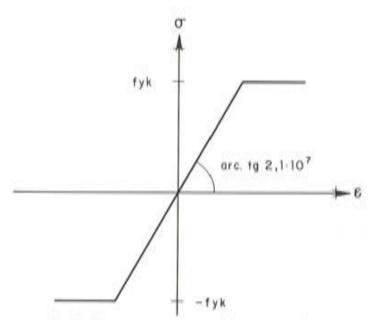
Fig. 11, Diagrama σ-ε del acero (dureza natural).
