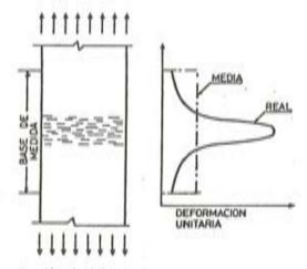
Fig. 3. Localización de deformaciones en la rama de ablandamiento.
