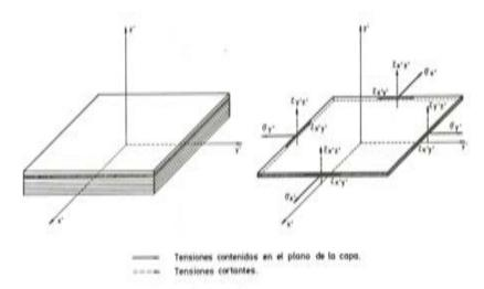
Fig. 8. Tensiones sobre una capa.
