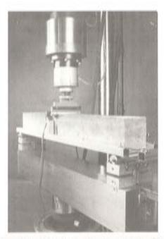
Foro 2. Sistema de medida de desplazamientos para las probetas \$1.
