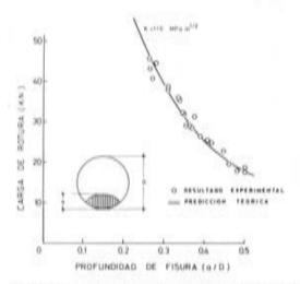
Fig. 8. Criterio de fractura de alambre de pretensar.
