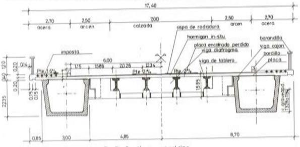
Fig. 7b. Sección transversal tipo.
