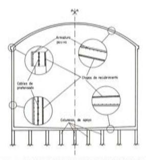
Fig. 5. Estructura resistente de un tanque para G.N.L.
