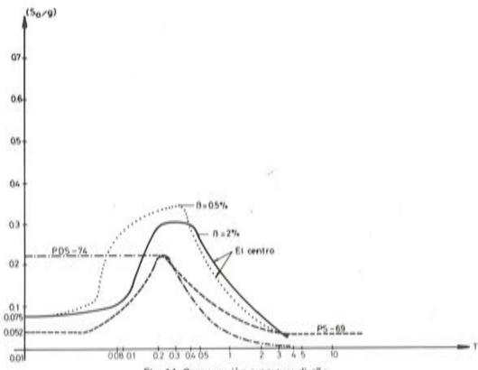
Fig. 14. Comparación espectros diseño.
