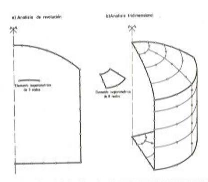
Fig. 13. Tanque de hormigón criogénico. Discretización en elementos finitos para el análisis tensional.
