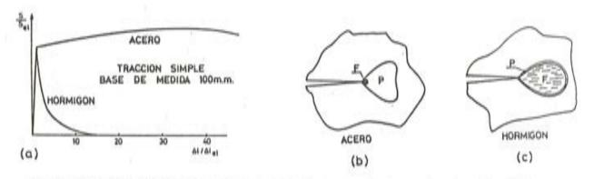
Fig. 2. Esquema del comportamiento en tracción simple de un acero al carbono y de un hormigón (a). Zonas No Lineales para un acero (b) y un hormigón (c).
