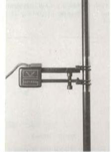
Fig. 2. Dispositivo para medida de fisuras de fatiga,
