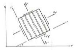
b) Fisuracion en dos direcciones
