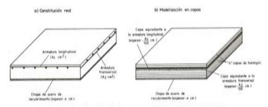
Fig. 6. Modelización de la lámina en capas de los distintos materiales.
