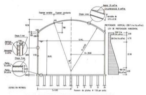
Fig. 17. Características geométricas del tanque para G.N.L.
