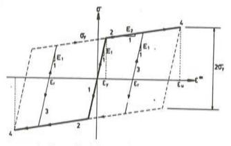
Fig. 2. Diagrama uniaxial tensión-deformación utilizado para el acero pasivo.
