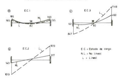
Fig. 8.- Momentos flectores para los estados de carga.
