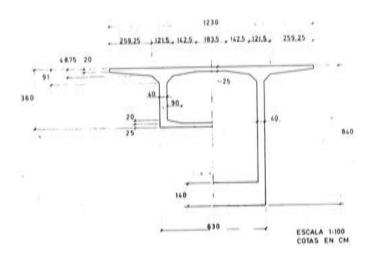
Figura 2. Semisecciones transversales en clave y en apoyos sobre pilas.
