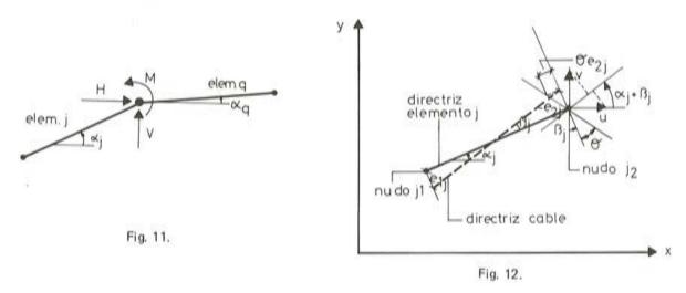
Así pués, en el nudo 'i', común a los elementos 'j' y 'q' atravesados por un cable, se aplica el sistema de fuerzas exteriores siguiente (fig. 11):
