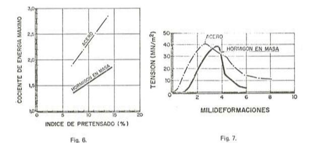
En la figura 6 se puede observar el efecto del Indice de Pretensado sobre el máximo Coeficiente de Energía, definido como el cociente de la Energía de Impacto (peso del martillo x altura de caída libre) a la Tenacidad de Referencia, que a su vez se define como el área bajo la curva carga-deflexión estática hasta el punto correspondiente a una deformación de compresión de 0,0055 (figura 7).
