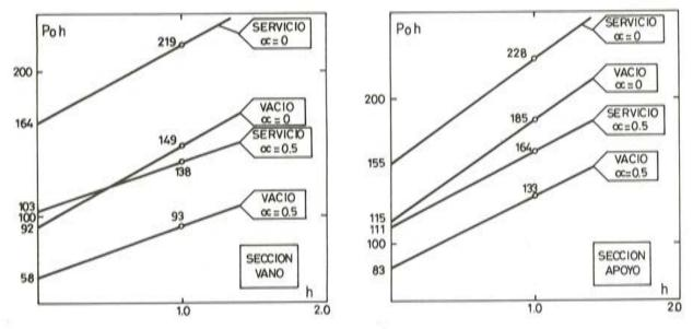
Fig. 4.4. Inecuaciones representativas del e.Q. último en las secciones críticas.
