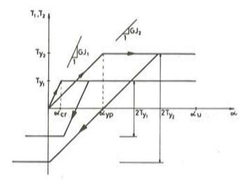
Fig. 11. Modelos elasto-plásticos a superponer en la relacion trilineal adoptada para el comportamiento a torsión.
