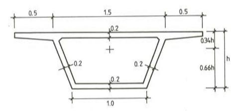
Fig. 4.2. Sección transversal de la viga.
