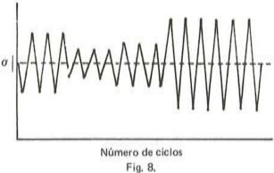
No deja de ser sorprendente el hecho de que la serie J, presenta una dispersión tan solo de 0,308 cuando está formada por bloques distintos no solo en amplitud y en número de ensayos sino que, además, el valor medio de la tensión en cada bloque de ciclos varía de uno a otro (fig. 9), a diferencia con la I. La dispersión del conjunto de las series H, I y J es de 0,346.
