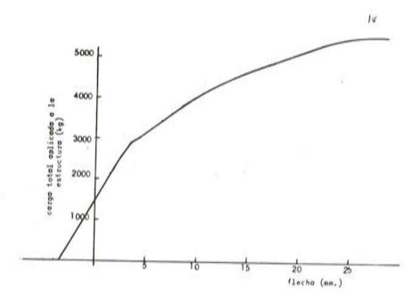
Fig. 16. Curva carga total - corrimiento vertical del punto central de la viga. Pretensión previa en la viga de 3.250 kg.
