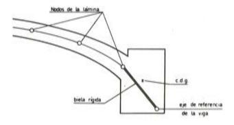
Fig. 4. Modelización de la unión viga-lámina.
