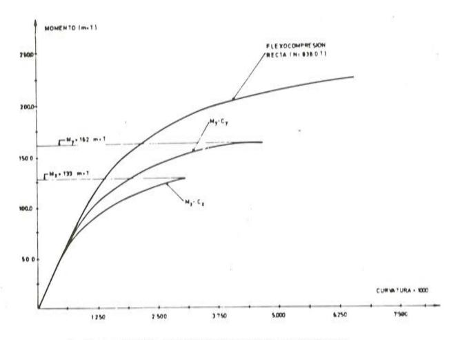
Fig. 11.- Evolución hasta alcanzar agotamiento manteniendo axil constante e incrementando proporcionalmente ambos momentos My y Mz.
