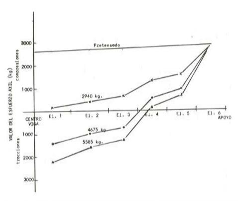
Fig. 17. Valores del esfuerzo axil en la viga para distintos valores de la carga externa total (Viga pretensada).
