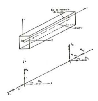
Fig. 2. Geometría y grados de libertad de las vigas.
