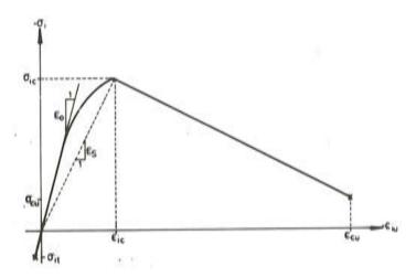
Fig. 9. Curva tensión-deformación uniaxial equivalente.
