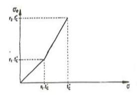
Fig. 3. Tensión eficaz  $\sigma_{\rm e}$  en función de la tensión real para fluencia no lineal.
