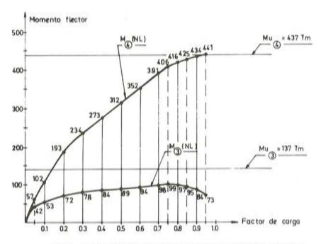
Fig. 9.- Evolución de los momentos flectores en las secciones 3 y 4 para el estado de carga 3.
