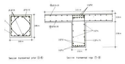
Fig. 4.- Secciones transversales genéricas del pórtico analizado
