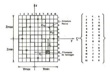
Fig. 7. Discretización de la sección transversal.
