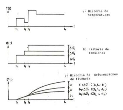
Fig. 2. Superposición de la deformación de fluencia.
