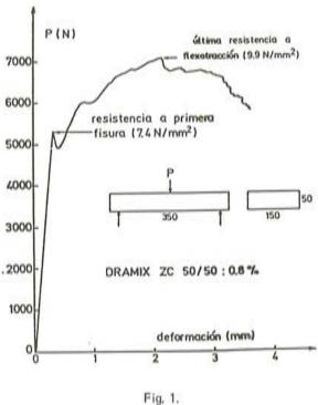
En un hormigón tradicional, al llegarse al "punto de primera fisura" se produce la rotura frágil. En el reforzado con fibras, la primera fisura tiene lugar para tensiones iguales o superiores a la máxima convencional, para luego tomar las fibras el efecto de armado por el que se alcanza la tensión máxima de rotura.
