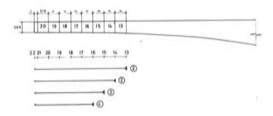
Figura 6. Pretensado inferior del vano lateral.
