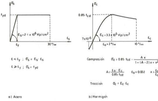
Fig. 2. Diagramas tensión-deformación de los materiales.
