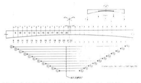
Figura 7. Pretensado inferior del vano central en las estructuras E-1 y E-2. (Pretensado de continuidad "TOTAL", o Clase I).
