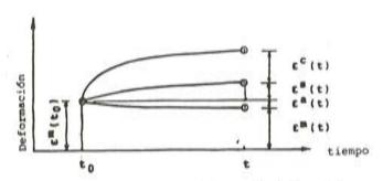
Fig. 1. Componentes de la deformación del hormigón.
