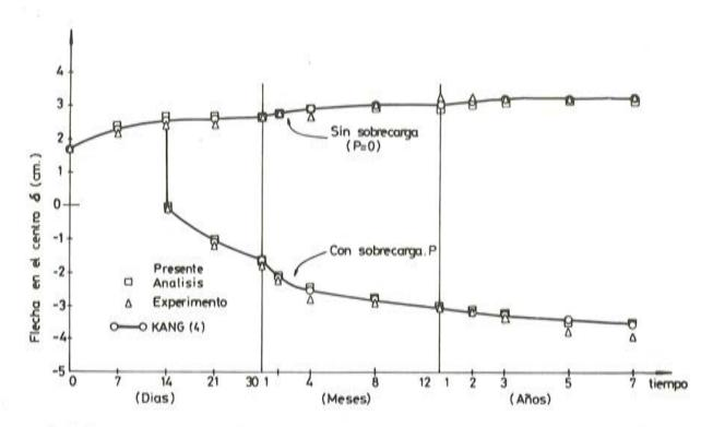
Fig. 9. Flecha en el centro a lo largo del tiempo. Comparación con resultados experimentales y numéricos.
