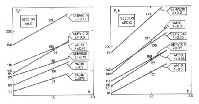
Fig. 4,6. Inecuaciones representativas del e. Å. de fisuración (clase II y III) en las secciones críticas.
