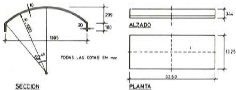
Fig. 12. Dimensiones de la estructura analizada.
