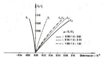
Relaciones experimentales tensión-deformación para tracción biaxial. Fig. 6.
