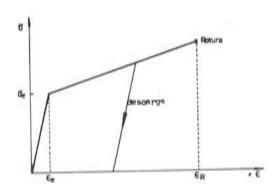
Fig. 5. Diagrama tensión deformación para el acero.
