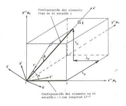
Fig. 12. Transformación de los ejes locales de la viga en un análisis frente a grandes desplazamientos,
