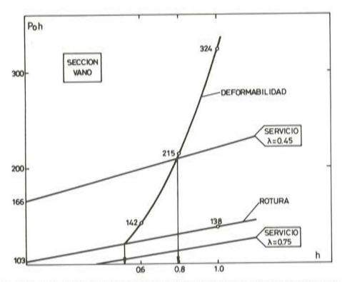
Fig. 4.10. Inecuaciones representativas de los distintos estados límites en pretensado parcial.
