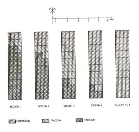
Fig. 18. Distribución de tensiones en varias secciones de la viga de borde previamente pretensada para una carga total de 4.100 kp.
