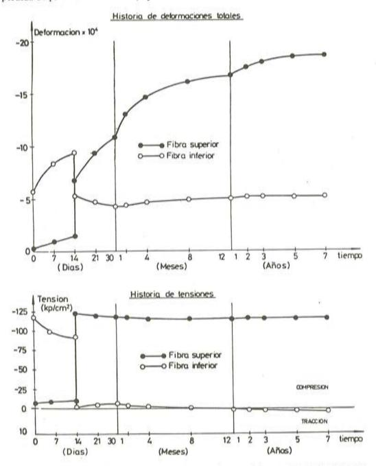
Fig. 11. Historia de deformaciones totales y tensiones en el centro del vano actuando la sobrecarga.
