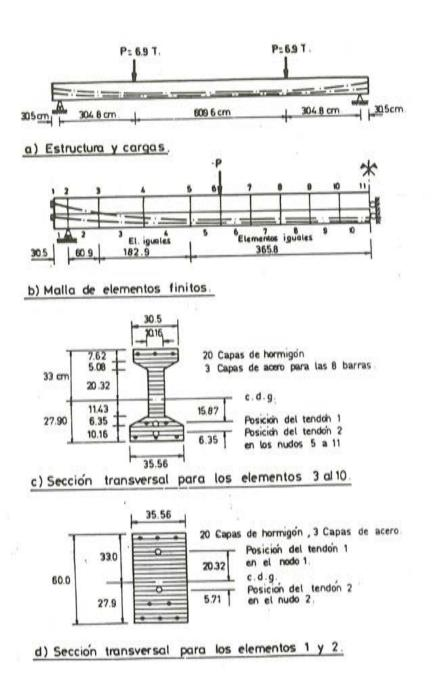
Fig. 7. Viga analizada. Ensayo de Breckenridge y Bugg.
