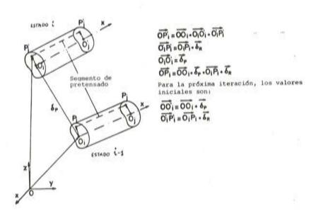
Fig. 17. Cálculo de las coordenadas globales de los extremos de un segmento de pretensado tras la deformación.
