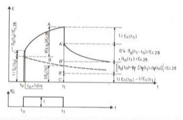
Fig. 2. Probeta de hormigón puesta en carga en el instante to y descargada en el instante to.
