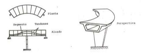
Fig. 8. Estructurada pretensada real e idealizada.
