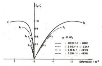
Relaciones experimentales tensión-deformación para tracción biaxial.
