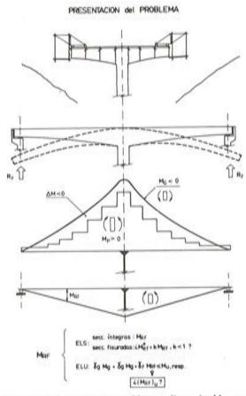
Figura 1. Origen de los esfuerzos de adaptación por fluencia, M<sub>RF</sub>, y problemática de su consideración en la verificación de los distintos estados límites.
