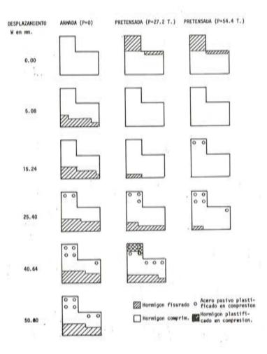
Fig. 20. Evolución de la fisuración y estado tensional de la sección de la base,
