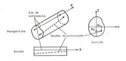
Fig. 9. Elemento viga pretensado.
