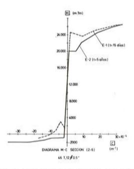
Figura 10. Diagramas Momento-Curvatura de la sección (2-6) de las estructuras E-1 y E-2. Nótese la pequeña diferencia que existe entre el momento de fisuración y el último respuesta, en la estructura E-1, en la que aún no se han producido las pérdidas diferidas de pretensado.
