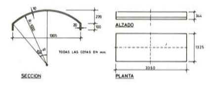
Fig. 12. Dimensiones de la estructura analizada.
