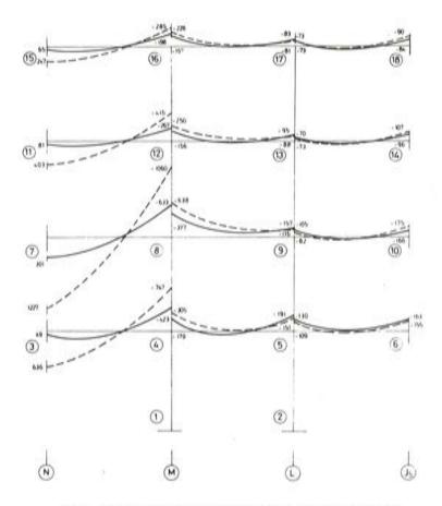
Fig. 6.- Resultados del análisis lineal y no lineal del pórtico analizado (En vigas). L≡ línea discontínua NL≡ línea contínua.
