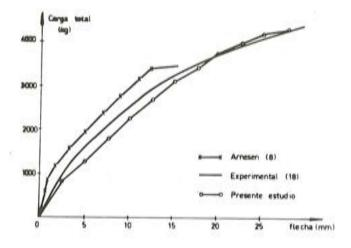
Fig. 14. Curva carga total - desplazamiento del punto central de la viga. Viga no pretensada.
