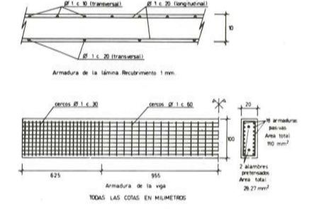
Fig. 13. Armadura de la lámina y de las vigas de borde.
