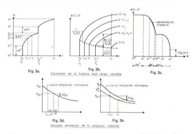
Supongamos una sección de hormigón puesta en carga a una tensión inicial  $\sigma^{\circ}$  en el instante  $t_{o}$ , tensión que ha ido variando con el tiempo según la ley indicada en la fig. 3-a. Los saltos bruscos corresponden a la aplicación de nuevas cargas en la estructura. La ley contínua, consecuencia de las redistribuciones diferidas, no es conocida a priori.
