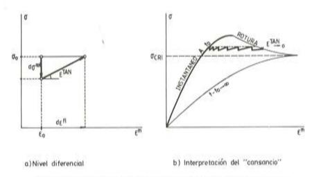
Fig. 6. Fluencia como combinación de relajación y carga instantánea.
