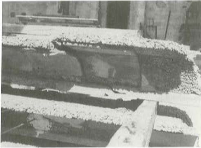
Foto 2. Rotura de un elemento de la serie B-1.
