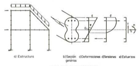
Fig. 1. Estructuras reticulares.
