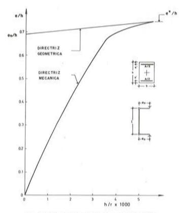
Fig. 2. ELU de agotamiento de la sección crítica.
