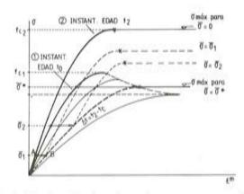
Fig. 4. Disminución de resistencia por carga mantenida previa.
