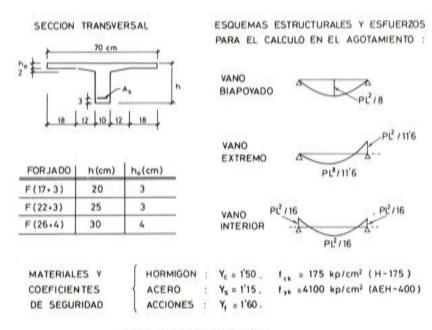
Fig. 1. Forjados analizados.
