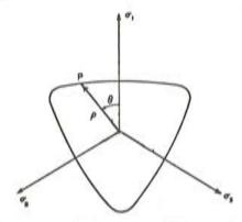
Fig. 3. Intersección de la superficie resistente última con los planos octaédricos.
