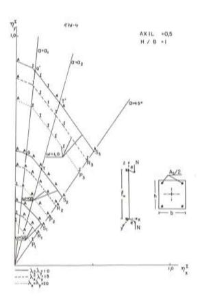
Fig. 4. Superficies de interacción. Cambios en el tipo de rotura.
