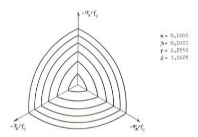
Fig. 4. Intersecciones de la superficie límite propuesta, sobre los planos octaédricos, para diferentes valores de la tensión normal media.
