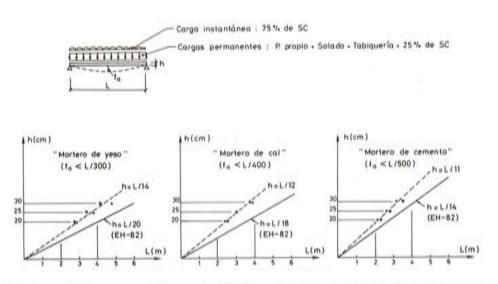
Fig. 6. Relaciones (h/L) recomendadas por la EH-82 y obtenidas en este estudio para forjados nervados que reciben fábricas construídas con diferentes tipos de mortero.
