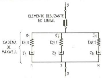
Fig. 3. Modelo para el hormigón.
