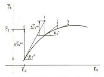
Fig. 5. Proceso iterativo a nivel sección.
