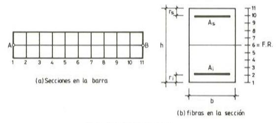
Fig. 7. Definición del elemento barra.
