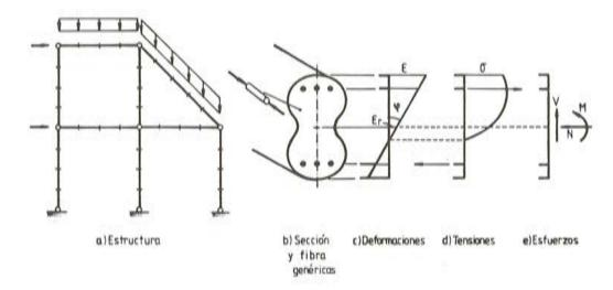
Fig. 1. Análisis de estructuras reticulares.
