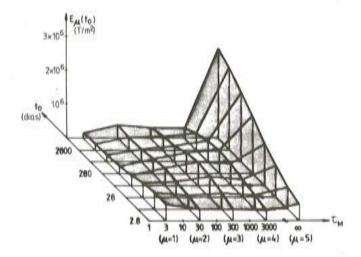
Fig. 7. Espectro de relajación para un hormigón de  $f_{\rm c,28}=3.000~{\rm t/m^2}$  en ambiente húmedo.
