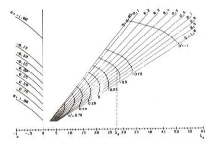
Fig. 5. Nomograma para determinar la esbeltez equivalente,  $\lambda_{\rm e}$ .
