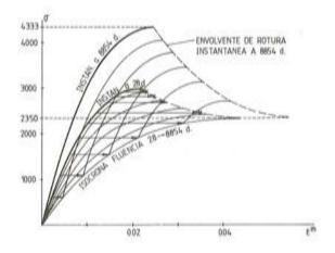
Fig. 11. Disminución de resistencia por cansancio.
