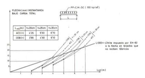
Fig. 3. Flechas instantáneas, bajo carga total, en los diferentes forjados estudiados, y "luces máximas" que admite cada "canto" de modo que se respete la limitación (L/300) de flecha.
