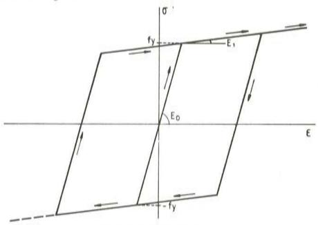
Fig. 4. Modelo para el acero.
