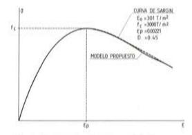
Fig. 9. Verificación de la forma del diagrama σ- cinstantáneo.
