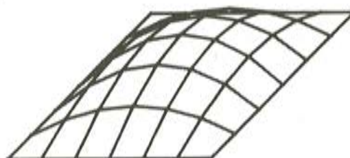
Velaria paraboloidal A = B = 2, C = 1, m = -2C/B = -1
