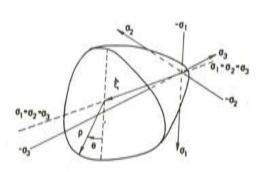
Fig. 1. Representación triaxial típica de la superficie resistente última de un material isotrópico.
