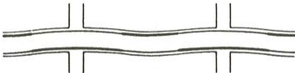
Fig. 2. Esquema de deformación de un pórtico.
