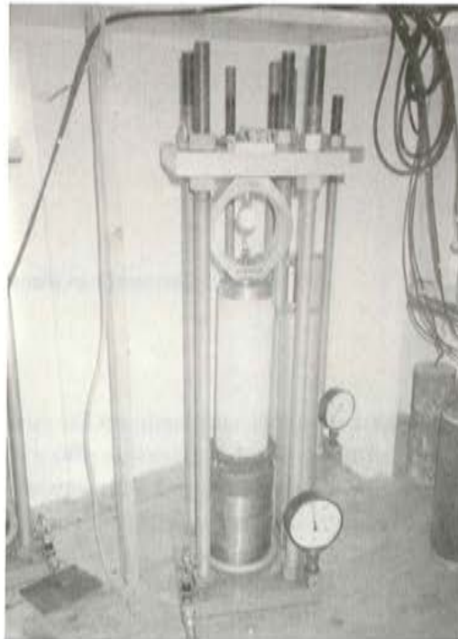
Fig. 3. Esquema del bastidor de carga empleado.
