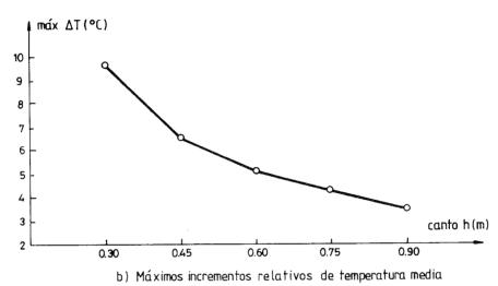
Fig. 13. Influencia del canto sobre el gradiente térmico, vertical, máximo y sobre el rango diario de la temperatura media.
