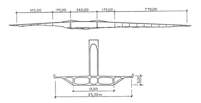
Fig. 1. Puente Gateway, en Brisbane. Propuesta no aceptada.
