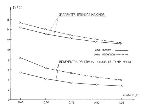
Fig. 17. Influencia del canto sobre el gradiente térmico, vertical, máximo y sobre el rango diario de la temperatura media, para los diferentes tableros de losa maciza y losa aligerada analizados.
