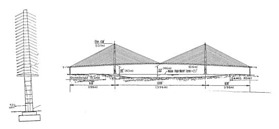
Fig. 8. En el puente Dame Point (Florida), la gran rigidez de las pilas se introduce por dos motivos. Por tener una relación de luces entre vano lateral y central de 0,5 y por utilizar un atirantamiento en arpa.
