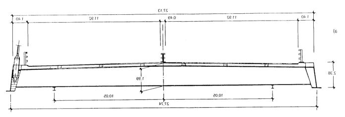
Fig. 25. Sección transversal, no aceptada, para el puente de Sunshine Skyway.
