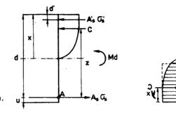
Fig. 2.2. Tensiones y esfuerzos en la sección.
