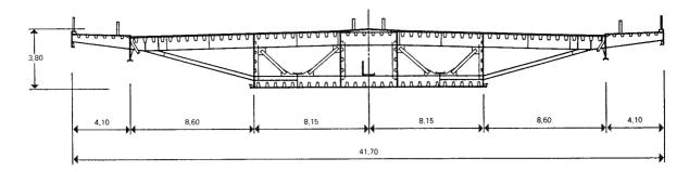
Fig. 18. Sección transversal del Puente de Flehe.
