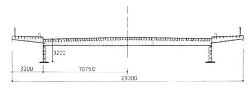
Fig. 20. Sección transversal del Kniebrücke, en Düsseldorf.
