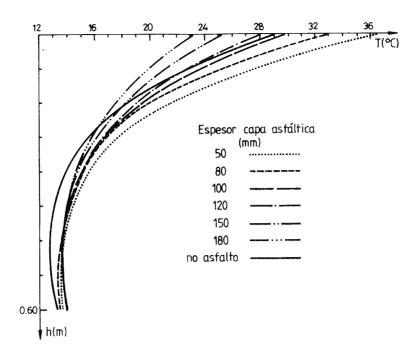
Fig. 2. Distribuciones de temperaturas según el eje de simetría, correspondientes al instante de máximo gradiente térmico, para los diferentes espesores de capa asfáltica.
