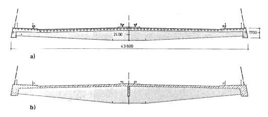
Fig. 24. Propuesta, no aceptada, de Leonhardt para el Kniebrücke. (a) Propuesta metálica, (b) Propuesta de hormigón con viga metálica transversal.
