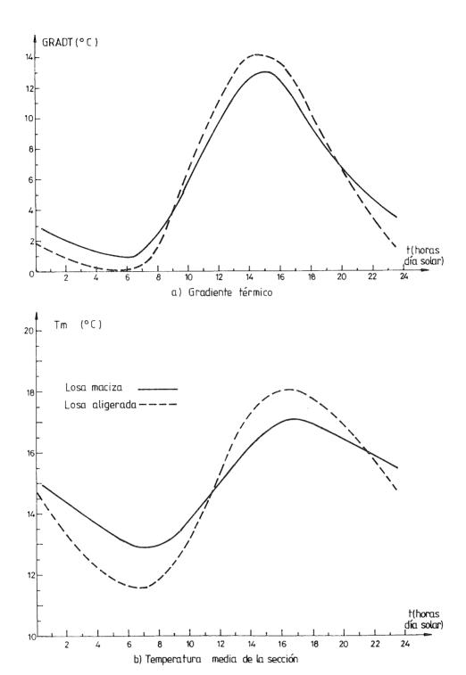
Fig. 16. Evoluciones diarias del gradiente térmico y de la temperatura media para los tableros losa maciza y losa aligerada analizados.
