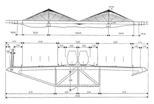
Fig. 3. Propuesta para puente sobre el estrecho de Mesina. F. Leonhardt.
