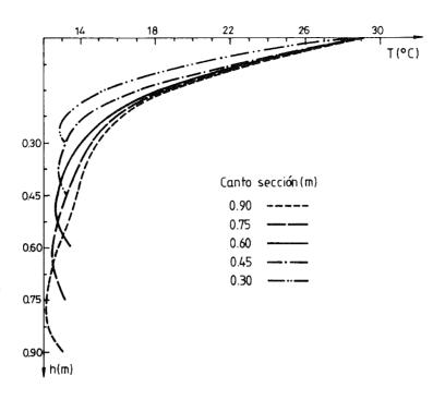
Fig. 11. Distribuciones de temperaturas según el eje de simetría, correspondientes al instante de máximo gradiente térmico, para los diferentes cantos.
