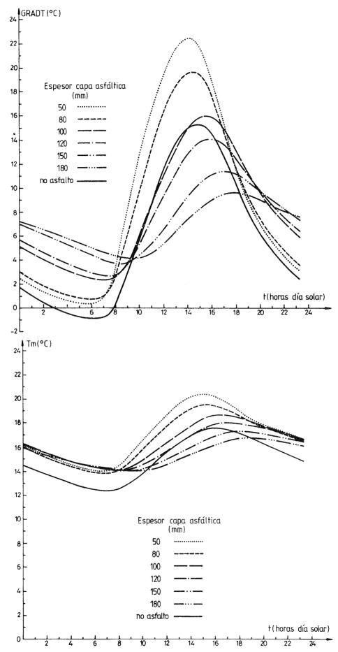
Fig. 3. Evoluciones diarias del gradiente térmico y de la temperatura media, para los diferentes espesores de capa asfáltica.
