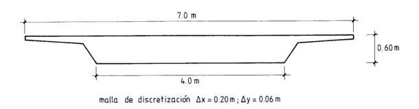
Fig. 20. Sección transversal de referencia adoptada para la determinación del valor característico de las acciones térmicas en tableros de puentes losa maciza emplazados en nuestro país,
