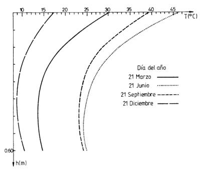
Fig. 7. Distribuciones de temperaturas según el eje de simetría, correspondientes al instante de máximo gradiente térmico, para diferentes días del año (equinoccios y solsticios).
