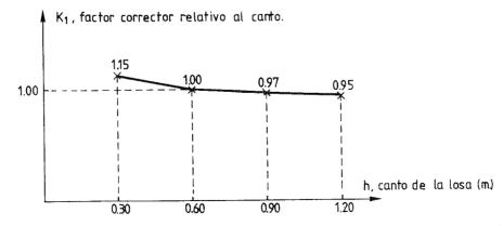
Fig. 22. Factor de corrección  $k_1$ , relativo al canto del tablero, para determinar el rango anual de diseño de la temperatura media en puentes losa maciza.
