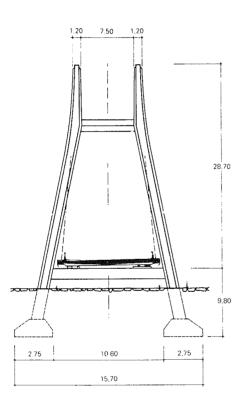
Fig. 50. Puente de Diepoldsau. Pila.
