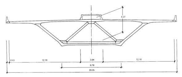
Fig. 30. Sección transversal utilizada en Brotonne (L=320 m) Coatzocoalcos (L = 288 m) y Sunshine Skyway (L = 365,76 m) (representado). Las variaciones entre estas secciones son mínimas. Unicamente, en el último puente citado, el apuntalamiento interior se realiza por parejas de puntales. También se diferencian entre sí en la forma de hormigonado de la sección transversal.
