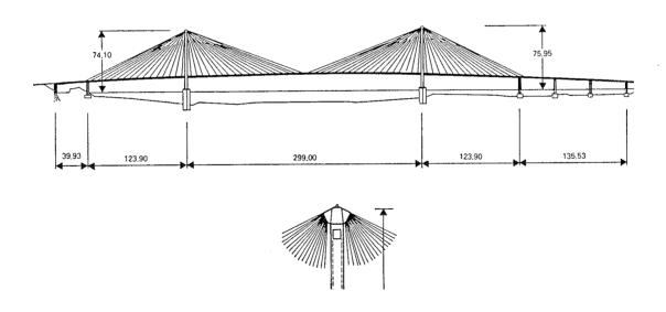
Fig. 11. Puente de Pasco - Kennewick. Ejemplo típico del puente en abanico. El anclaje de tan gran número de tirantes en cabeza, supuso la colocación en la misma de una pieza metálica de gran valor y complicación.
