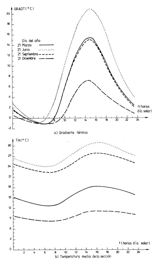
Fig. 8. Evoluciones diarias del gradiente térmico y de la temperatura media, para los diferentes días analizados.
