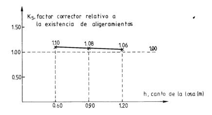
Fig. 27. Factor de corrección  $k_5$ , en función del canto del tablero, relativo a la presencia de aligeramientos para determinar el gradiente térmico de diseño en puentes losa aligerada.
