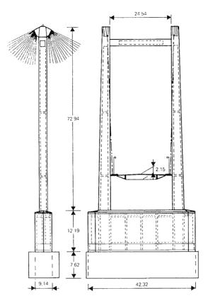
Fig. 48. Puente de Pasco-Kennewick. Pila.
