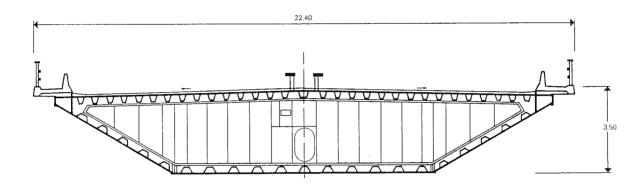
Fig. 19. Sección transversal del Puente de Faro. Cowiconsult - Copenhagen.
