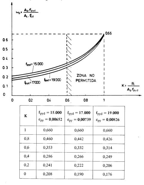
Fig. 2.6. Valor de la cuantía máxima para que la rotura sea dúctil.
