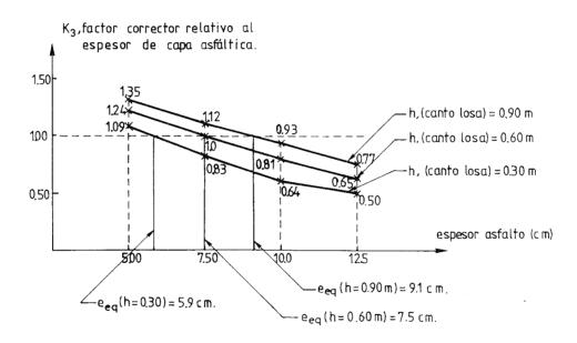
Fig. 25. Factor de corrección k<sub>3</sub>, relativo al espesor de capa asfáltica, para determinar el gradiente térmico de diseño en puentes losa maciza.
