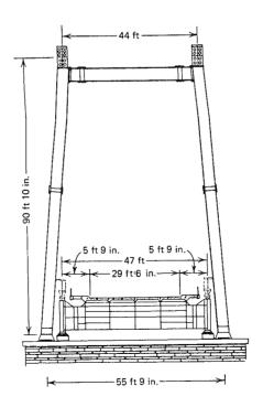
Fig. 47. Puente de Stromsund, Pila.
