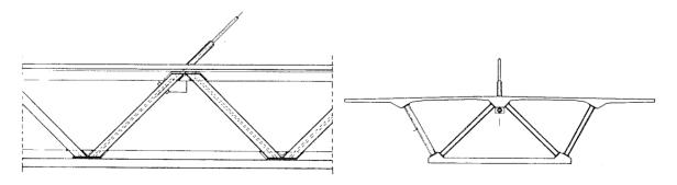
Fig. 28. Proposición de tableros metálicos atirantados, con almas triangulares.
