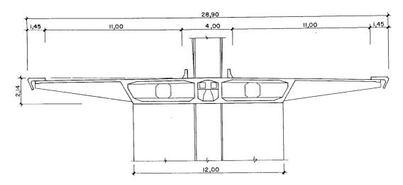
Fig. 29. Sección transversal del puente del Ebro. Leonardo Fernández Troyano y Javier Manterola Armisen.
