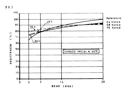
Fig. 5. Evolución de las resistencias en función de las condiciones de curado inicial. Serie II.
