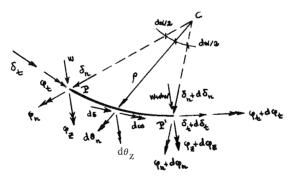
Fig. 12. Deformaciones y movimientos en una rebanada
