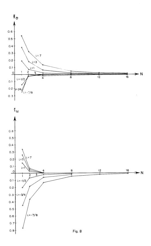
Mediante el análisis de la figura se observa que, para valores positivos del coeficiente i, las mayores diferencias se obtienen en el giro  $\Theta$ ; mientras que para valores negativos de dicho coeficiente, las discrepancias del momento M son de mayor cuantía. Asimismo, se deduce que, para los rangos de variaciones de rigidez analizados, resulta necesario subdividir la viga hasta en seis barras, para conseguir errores inferiores al 10 por 100.
