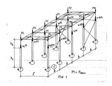
En el trabajo se presenta un programa de computación que integra dos programas para la determinación del coeficiente [k] de longitud efectiva para el pandeo de columnas de segmentos espaciales de naves metálicas utilizando microcomputadoras.
