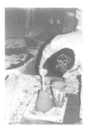
Foto 3. Determinación de la consistencia.
