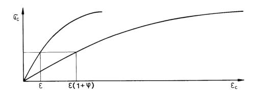
Evidentemente, esto sería exacto si, en condiciones de linealidad del material, las tensiones durante el proceso fueran constantes (caso fluencia); pero esta situación no puede tomarse precisamente como general.
