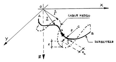
Fig. 16. Representación genérica de un cable de pretensado
