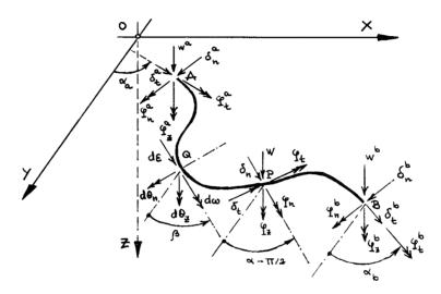
Fig. 13. Movimientos genéricos de la viga curva
