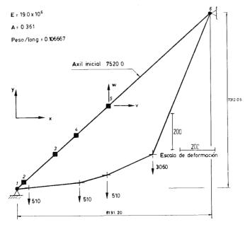
Fig. 4. Configuración de un tirante con cargas puntuales.
