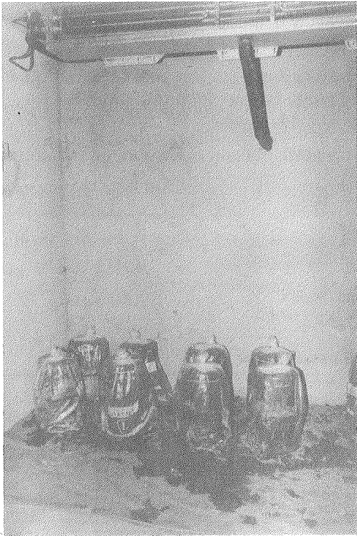
Foto 5. Probetas en la cámara especial de curado.
