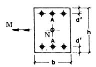
Fig.2 Flexocompresión recta
