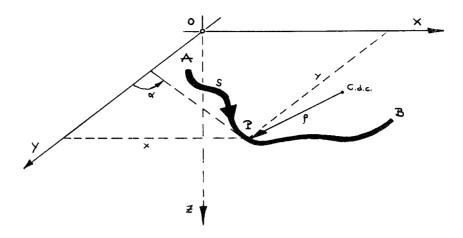
Fig. 3. Coordenadas generales y elementos característicos de la geometría de la viga de planta curva
