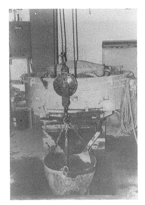
Foto 1. Amasadora marca TEKA, de 375 l de capacidad, utilizada para la fabricación del hormigón.
