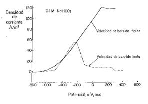
Fig. 3. Curvas de polarización a velocidad de barrido rápida y lenta 0,1 M NaHCO<sub>3</sub>.
