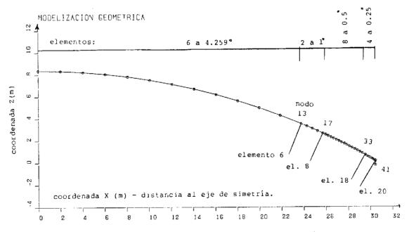
Fig. 17. Ejemplo 1- Discretización en elementos finitos de tres nodos.
