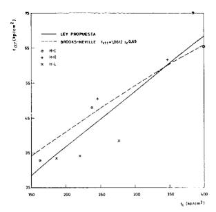
Fig. 6. Regresión de  $f_{ctt}$  sobre  $f_c$ .
