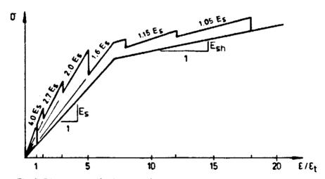
Fig. 6. Diagrama tensión-deformación del acero pasivo, modificado para la modelización del efecto de *tensión stiffening*.
