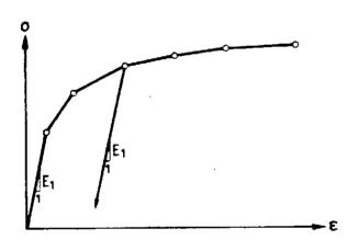
Fig. 15. Diagrama tensión-deformación multilineal, para el acero de pretensado.
