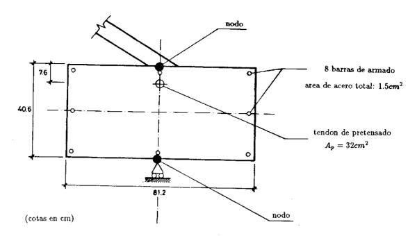
Fig. 18. Ejemplo 1- Geometría y distribución de la armadura, en la viga de borde.
