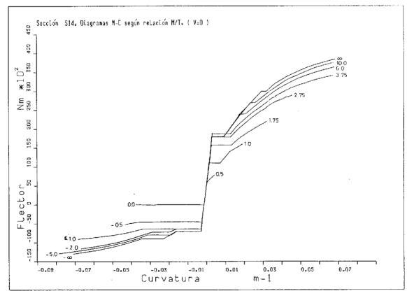
Fig. 29. Sección S14. Influencia de la relación M/T en el diagrama flector-curvatura.
