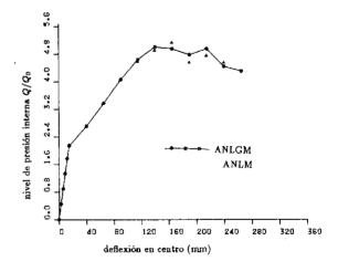
Fig. 28. *Ejemplo 2*— Relación entre el nivel de presión interna aplicado y la deflexión en el centro de la cúpula.
