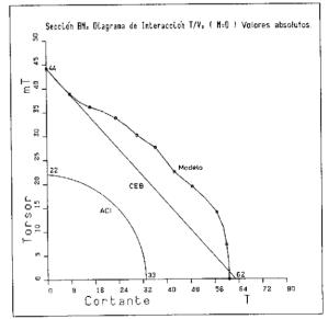
Fig. 40. Sección BM. Comparación del diagrama de interacción T/V, con las recomendaciones del ACI y del CEB. (valores "característicos").
