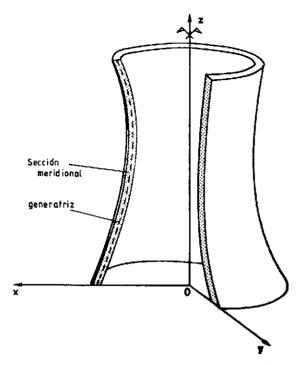
Fig. 1. Geometría de una lámina de revolución.
