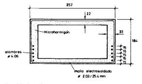
Fig. 25. Sección central de la viga 14 de los ensayos de SWANN y WILLIAMS (1973).
