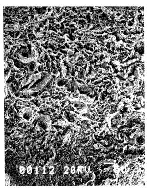
Fig. 5. Acero ensayado al aire. Centro de la superficie de fractura (dúctil)  $\times$  1 K.
