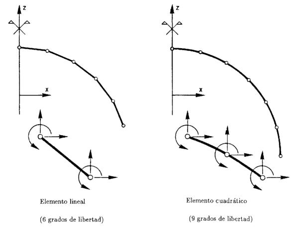
Fig. 7. Descripción de los elementos finitos normalmente utilizados en la discretización de láminas de revolución.
