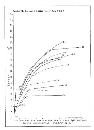
Fig. 37, Sección BM. Influencia de la relación M/T en el diagrama torsor-giro unitario.
