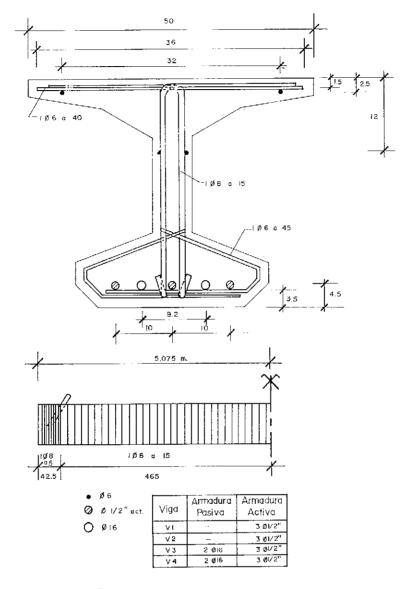
Fig. 5. Sección transversal de las vigas.
