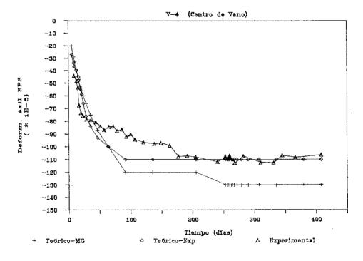
Fig. 11. Deformación media.
