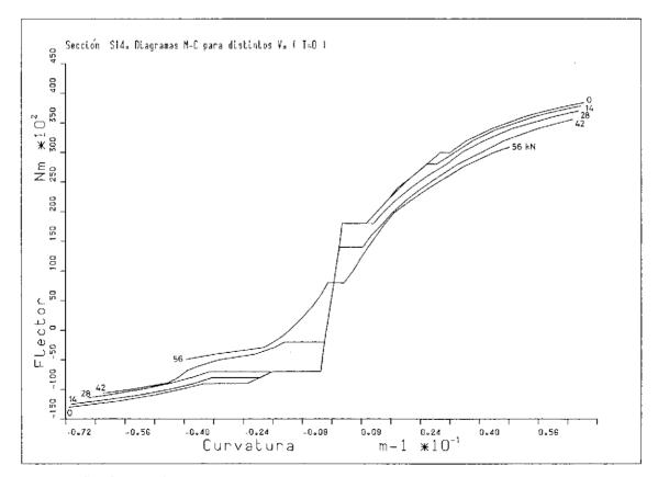
Fig. 31. Sección \$14. Influencia del esfuerzo cortante en el diagrama flector-curvatura,
