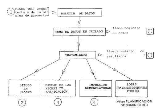
Proyectos. - Plano de colocación automático de las losas semirresistentes.
