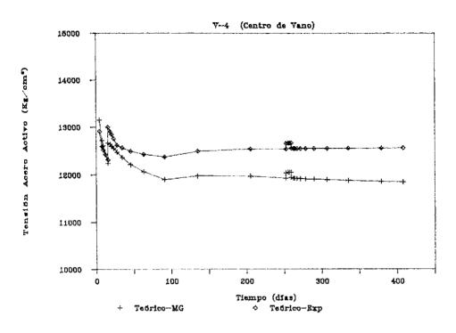
Fig. 14. Evolución de la tensión en armadura activa.
