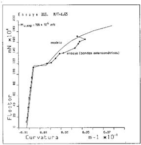
Fig. 17. Verificación del modelo en flexión y torsión combinadas (M/T = 4.65)
