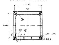
Fig. 15. Geometría de la sección transversal y disposición de las armaduras, en los ensayos DQ1, DQ3 y DQ4.
