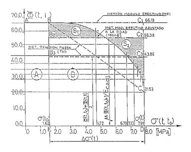
Fig. 2. Función integral de fluencia. Métodos simplificados [30].
