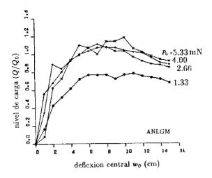
Fig. 24. Ejemplo 1— Relación entre el nivel de carga externa y la deflexión central  $(w_0)$ , para distintas fuerzas de pretensado.
