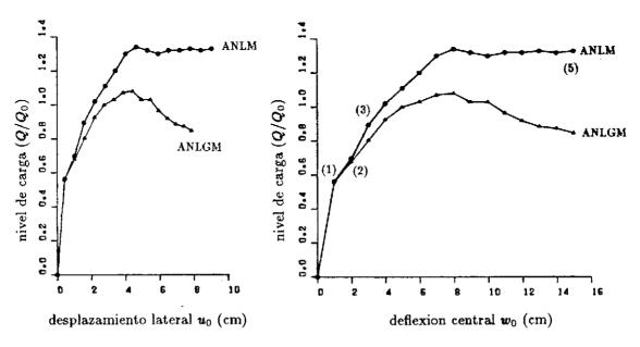
Fig. 20. Ejemplo 1— Relación entre el nivel de carga externa y el movimiento lateral en la base de la cúpula  $(u_0)$ .
