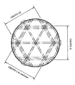
Fig. 14. Ejemplo de distribución real de tendones de pretensado meridionales, en varios haces simétricos.
