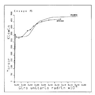
Fig. 10. Verificación del mocelo, en torsión pura, para secciones pretensadas huecas o macizas.
