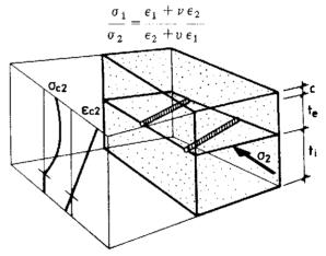
Fig. 2. Deformaciones en el espersor de un panel, debidas a la curvatura inducida por la flexión y la torsión.
