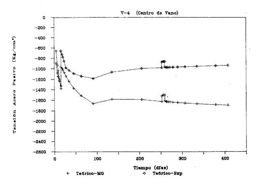
Fig. 16. Evolución de la tensión en armadura pasiva.
