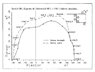
Fig. 34. Sección BM. Contraste de los diagramas de interacción M/T, para agotamiento por el hormigón vs por el acero.
