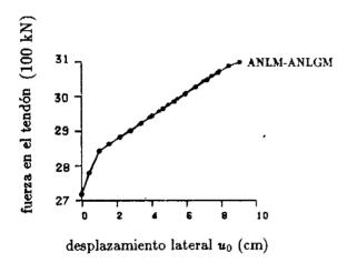
Fig. 22. Ejemplo 1— Relación entre la fuerza en el tendón y el desplazamiento lateral en la base  $\{u_Q\}$ .
