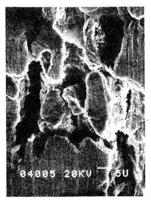
Fig. 8. Ataque localizado 0,05 M NaHCO<sub>3</sub> a + 210 mV desaireada x 1,7 k.
