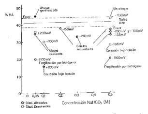
Fig. 4. Reducción en área en función [NaHCO<sub>3</sub>]. Tipos de fracturas y ataques encontrados en las distintas condiciones de tracción ensayados.
