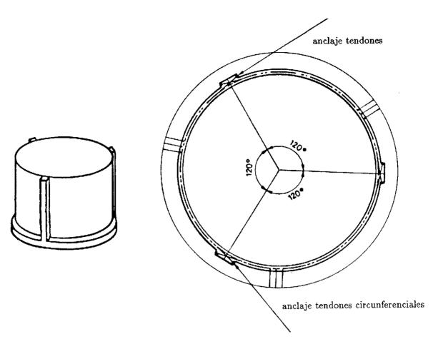
Fig. 13. Ejemplo de distribución real de tendones circunferenciales, en una lámina de revolución, pretensada.
