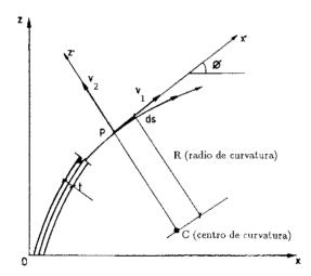
Fig. 2. Sección meridional de una lámina de revolución.
