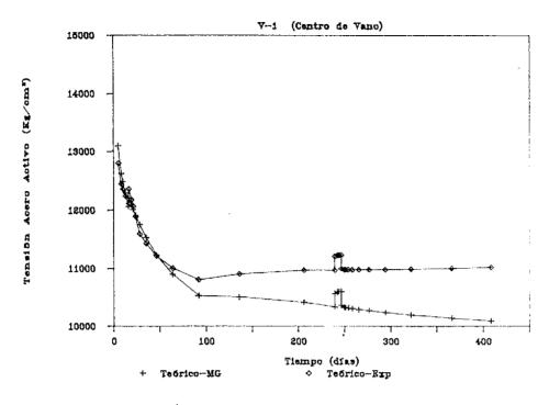
Fig. 12. Evolución de la tensión en armadura activa.
