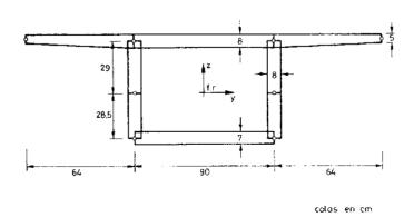
Fig. 20. Sección transversal y discretización en paneles de las vigas BM1 y BM2.
