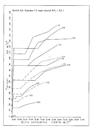
Fig. 30. Sección S14. Influencia de la relación M/T en el diagrama torsión-giro unitario.
