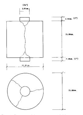
Fig. 1. Esquema del ensayo por "doble punzonamiento".
