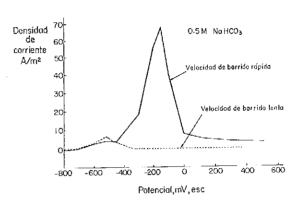
Fig. 2. Curvas de polarización a velocidad de barrido rápida y lenta. 0,5 M NaHCO<sub>3</sub>.
