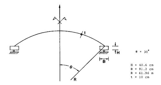
Fig. 16. Ejemplo 1- Geometría y dimensiones de la cúpula.
