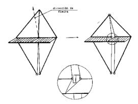
Fig. 11. Fisura que progresa generando un pasador.
