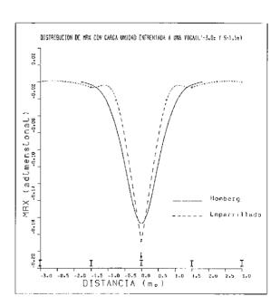
Fig. 9. Distribución de momentos reacción,  $M_{\tau x}$ , con una carga unidad enfrentada a una viga.
