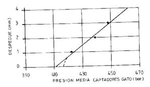
Fig. 4. Diagrama Presión media captadores-Despegue del tendón C-4 extremo 330 de la 2<sup>a</sup> vigilancia del grupo I de la C.N. Ascó.
