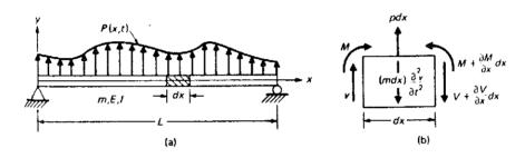
Fig. 1. Planteamiento del equilibrio dinámico en un elemento diferencial.
