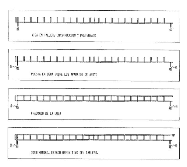
Fig. 20. Evolución de la discretización del tablero, a lo largo del tiempo.
