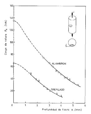
Fig. 3. Relación entre la profundidad de fisura y la carga de rotura de muestras cilíndricas fisuradas.
