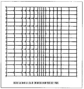
Fig. 4. Discretización de la losa de continuidad para el tablero de 5 vigas (A) y de 9 vigas (B).
