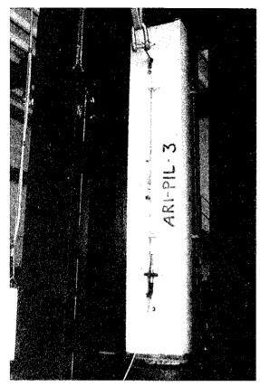
Foto 3. Disposición del ensayo de un pilar.
