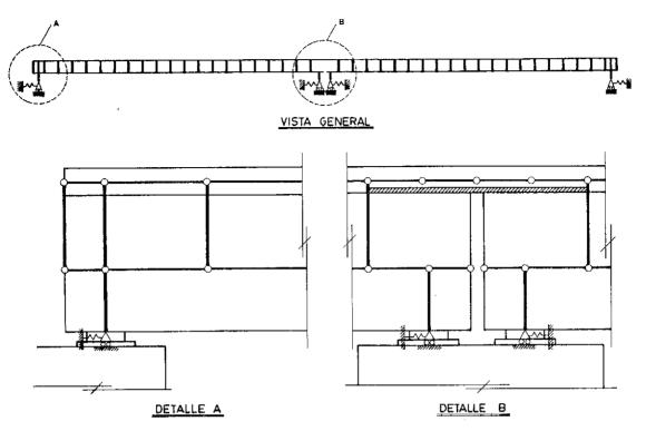
Fig. 2. Discretización longitudinal de un puente de vigas de dos vanos.
