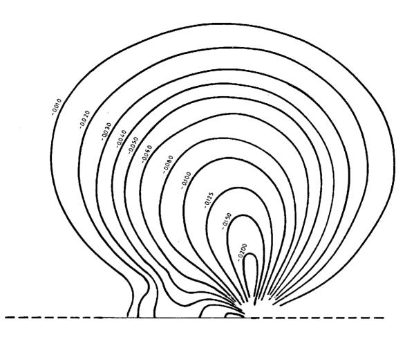
Fig. 16. Superficie de influencia del momento reacción M<sub>ry</sub>.
