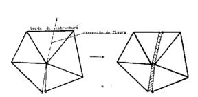
Fig. 8. Fisura que alcanza el borde de la estructura.
