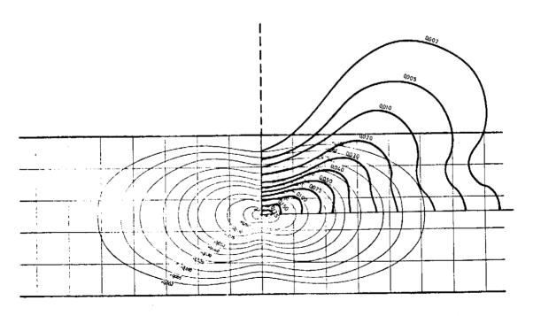
Fig. 11. Superficie de influencia del momento Mx, en un punto enfrentado a una viga.
