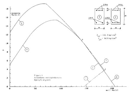
Fig. 3. Armadura contraproducente, Ejemplo segundo.
