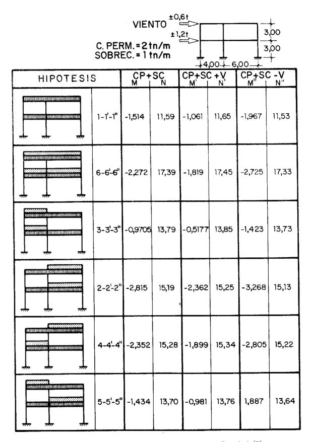
Fig. 1. Casos de carga para el cálculo del soporte de un pórtico. Tomado de [2].
