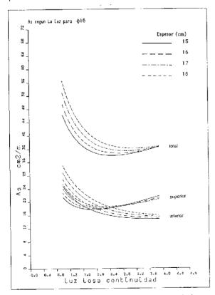
Fig. 31. Armadura longitudinal necesaria en la losa de continuidad, si para armar se emplean barras de  $\phi$  16.
