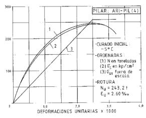
Fig.1. Diagramas esfuerzo - deformación obtenidos en el ensayo.
