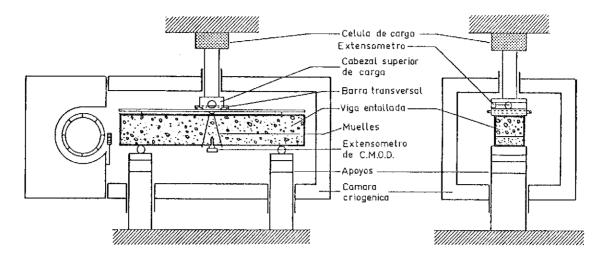
Fig. 3. Dispositivos para ensayos estables a flexión.
