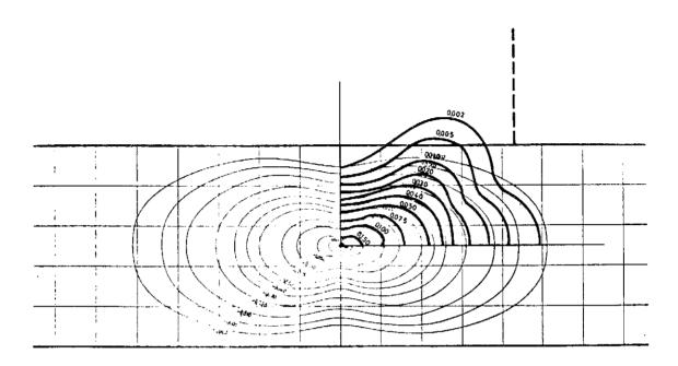
Fig. 12. Superficie de influencia del momento Mx, en un punto entre dos vigas.
