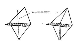
Fig. 10. Fisura que alcanza a un elemento de adherencia.
