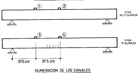
Fig. 4. Esquema del sistema de medida, adquisición y registro de vibraciones.
