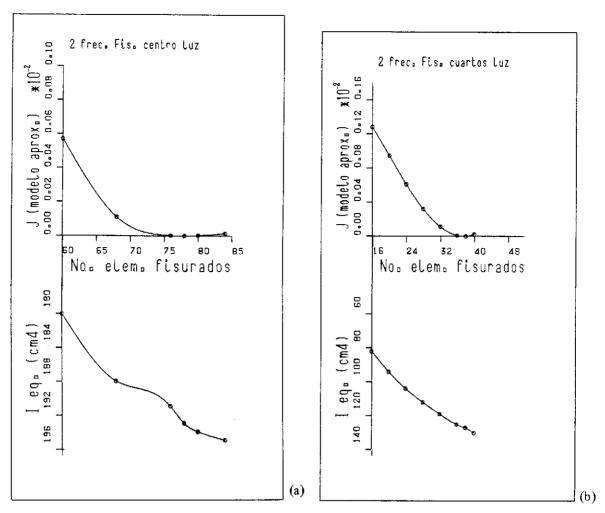
Fig. 10. Vigas B1, B2. Variables interpoladas: primera γ segunda frecuencía de vibración. a) Hipótesis de fisuración en centro luz. b) Hipótesis de fisuración a cuartos de luz.
