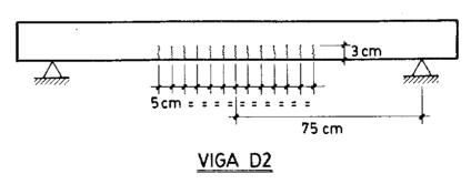
Fig. 2. Esquema de fisuración en las vigas ensayadas.
