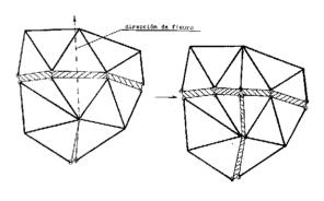
Fig. 9. Fisura que alcanza a otra fisura. Duplicación de elemento fisura.
