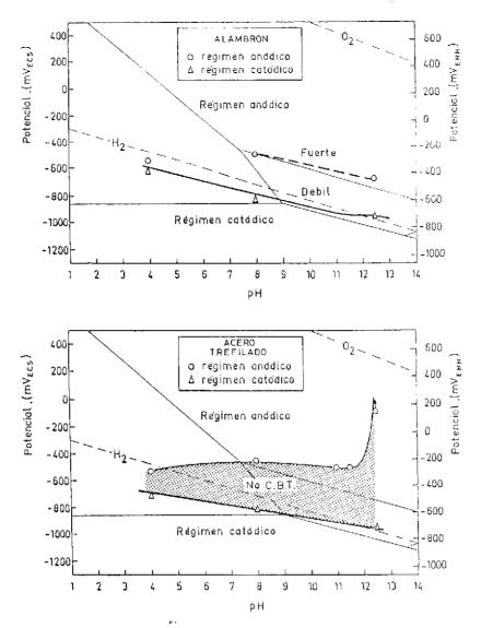
Figs. 9 y 10. Relación entre el diagrama de Pourbaix del sistema Fe-H<sub>2</sub>O y los regímenes de fractura por corrosión bajo tensión.
