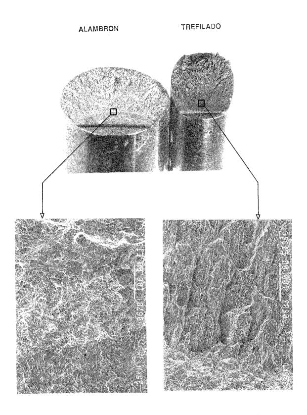
Fig. 7. Propagación de fisuras del alambrón y del acero trefilado, en régimen catódico.
