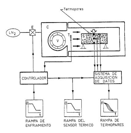
Fig. 2. Sistema de enfriamiento. Diagrama de bloques.
