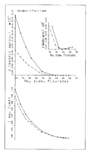
Fig. 7. Vigas A1, A2. Representación del valor de J (suma de errores cuadráticos de interpolación) y de la inercia equivalente, en función del número de elementos fisurados. El valor mínimo de J corresponde a la solución buscada. Variables interpoladas: primera frecuencia y primer modo de vibración.
