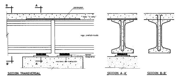
Fig. 1. Detalles constructivos de una losa de continuidad.
