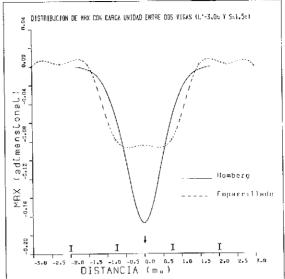
Fig. 10. Distribución de momentos reacción, M<sub>FX</sub>, con una carga unidad entre dos vigas.
