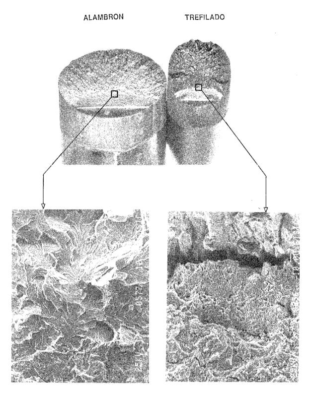
Fig. 8. Propagación de fisuras del alambrón y del acero trefilado en régimen anódico.
