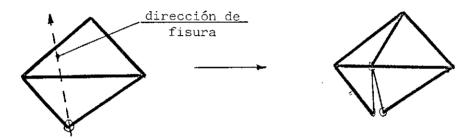
Fig. 7. Duplicación del elemento adyacente al fisurado.
