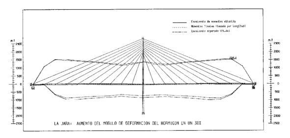
Fig. 10. Envolvente de momentos flectores durante construcción, obtenida en la simulación: Hipótesis: aumento de E<sub>c</sub> un 30 por 100; control de tesado por longitud.
