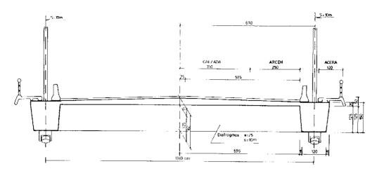
Fig. 2. Sección transversal del tablero.
