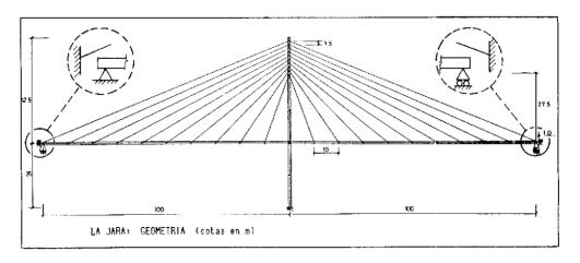
Fig. 1. Esquema longitudinal del puente estudiado.
