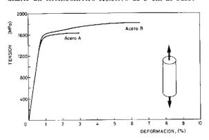
Fig. 1. Curvas tensión-deformación de los aceros empleados en la experimentación.
