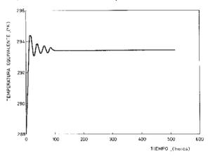
Fig. 7. Historia de temperaturas equivalentes, a 9,5 metros del extremo del puente.
