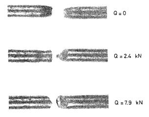
Fig. 5. Roturas de probetas para diferentes cargas laterales.
