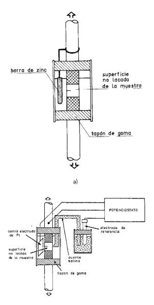
Fig. 2. a) Esquema del montaje de las muestras con acoplamiento de zinc en los ensayos de corrosión bajo tensión. b) Esquema del circuito electroquímico de control de potencial, utilizado en las experiencias de corrosión bajo tensión.
