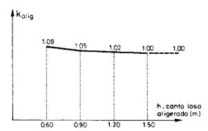
Fig. 6. Factor corrector k<sub>alig</sub>, en función del canto del tablero, relativo a la presencia de aligeramientos, para la determinación del rango anual de la temperatura media de puentes losa aligerada.
