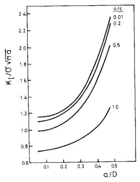
Fig. 3. Factor de intensidad de tensiones para la fisura semielíptica.
