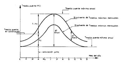
Fig. 10. Recorrido de la junta debido a la variación de la temperatura media del puente, en función de la temperatura de montaje (gráfica cualitativa).
