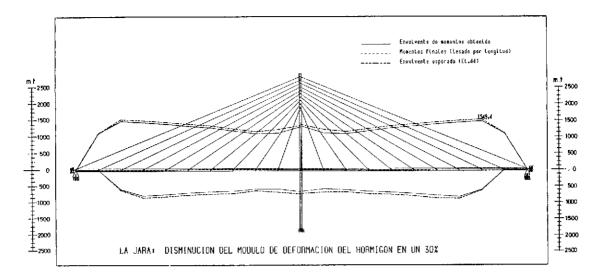
Fig. 12. Envolvente de momentos flectores durante construcción, obtenida en la simulación: Hipótesis: disminución de E<sub>c</sub> un 30 por 100; control de tesado por longitud.
