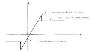
Fig. 6. Ensayo de corte a tensión normal constante.
