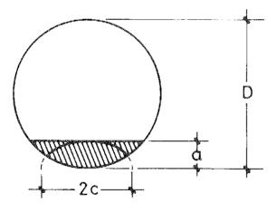
Fig. 5. Asimilación de la fisura semielíptica a una de borde recto.
