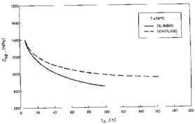
Figs. 9.1 y 9.2. Comparación entre dos soluciones teóricas (cilindro y semiplano infinito) y los resultados experimentales (área sombreada),
