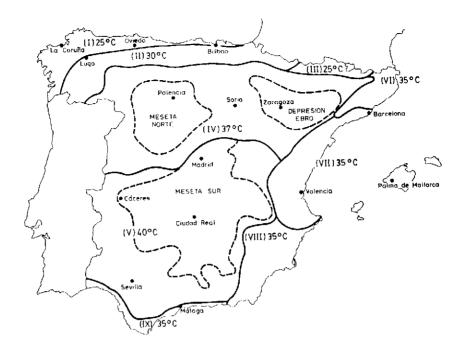
Fig. 1. Mapa peninsular de valores de diseño del rango anual de la temperatura media en puentes losa maciza, de canto 0,60 metros, atendiendo a las diferentes regiones climáticas.
