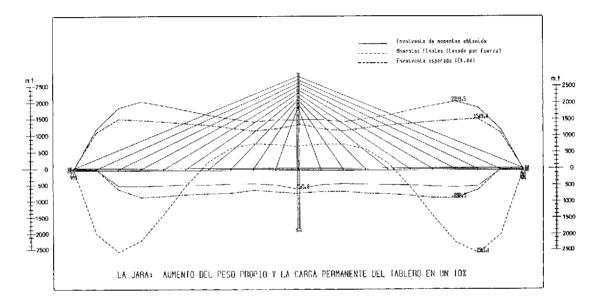
Fig. 5. Envolvente de momentos flectores durante la construcción, obtenida en la simulación: Hipótesis: incremento del peso propio un 10 por 100; control del tesado por fuerza.
