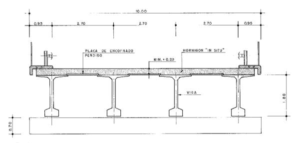
Fig. 3.1.3, Sección transversal de tablero.
