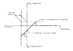
Fig. 5. Ensayo normal a tensión constante de corte,
