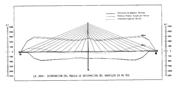
Fig. 11. Envolvente de momentos flectores durante construcción, obtenida en la simulación: Hipótesis: disminución de  $E_{\rm c}$  un 30 por 100; control de tesado por fuerza.
