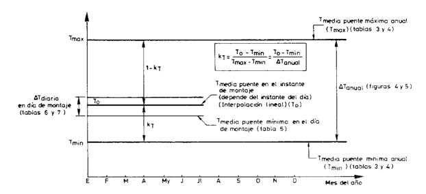
Fig. 11. Determinación de la variable  $k_{\rm T}$  para poder aquilatar el recorrido de la junta, en función de la temperatura de montaje y del rango anual de diseño de la temperatura media del puente.
