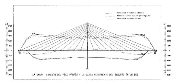
Fig. 6. Envolvente de momentos flectores durante construcción, obtenida en la simulación: Hipótesis: incremento del peso propio un 10 por 100; control de tesado por longitud.
