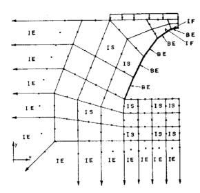
Fig. 9. Malla en elementos finitos.
