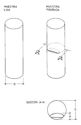
Fig. 1. Esquema de la geometría de las muestras.
