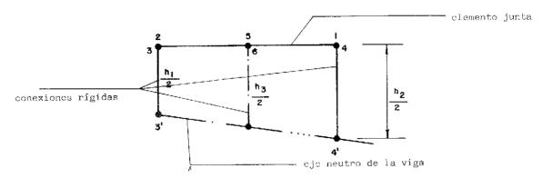
Fig. 3. Conexión del elemento junta con la viga,
