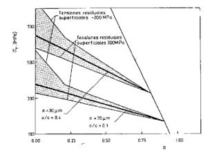
Fig. 8. Influencia de las tensiones residuales superficiales en el límite de fatiga.
