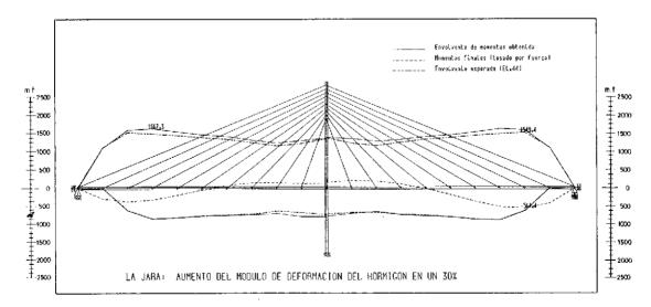
Fig. 9. Envolvente de momentos flectores durante construcción, obtenida en la simulación: Hipótesis: aumento de  $E_0$  un 30 poe 100; control de tesado por fuerza.
