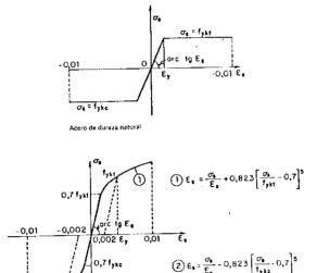
Fig. 3, Diagrama Tensión - Deformación para los aceros.
