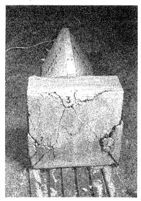
Fig. 7. Rotura por splitting.
