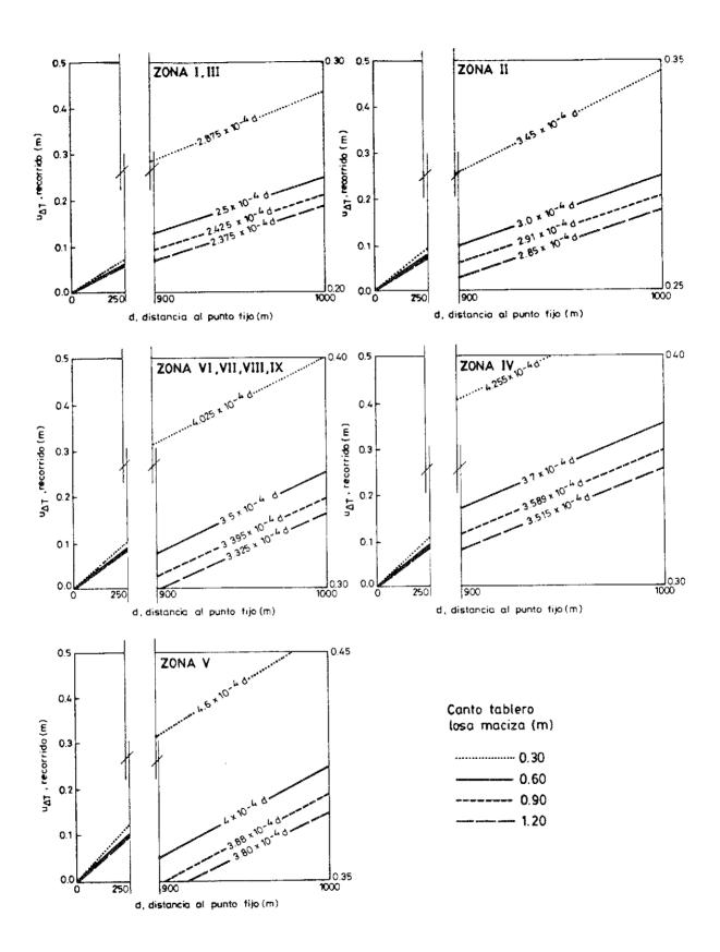
Fig. 4. Recorridos de juntas debidos a la expansión y contracción uniforme por temperatura, en tableros de puentes losa maciza.
