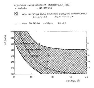
Fig. 9. Resultados experimentales de vida en fatiga de alambres de acero de pretensado (11) y predicciones del modelo.
