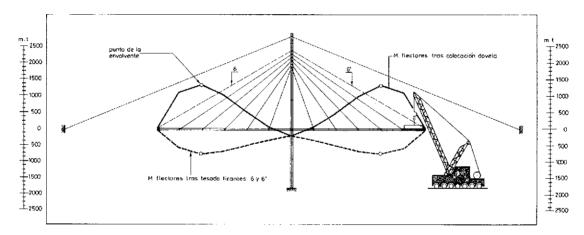
Fig. 3. Etapa impar de construcción. Momentos flectores en esa etapa y definición de la envolvente de momentos flectores durante construcción.
