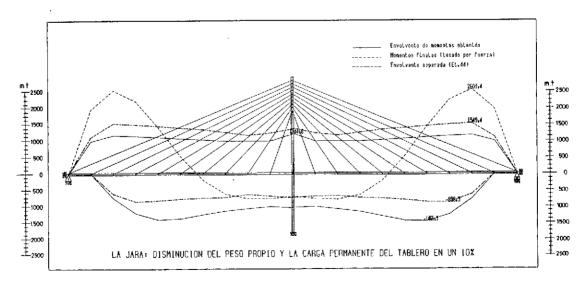
Fig. 7. Envolvente de momentos flectores durante construcción, obtenida en la simulación: Hipótesis: disminución del peso propio un 10 por 100; control del tesado por fuerza.
