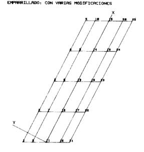
define el número mínimo de tipos de sección, dando para cada una de ellas su momento de inercia y su módulo de torsión. Para calcular estos valores se determina la anchura del área tributaria de cada barra, considerando como tal la distancia entre las líneas medias, entre el eje de
