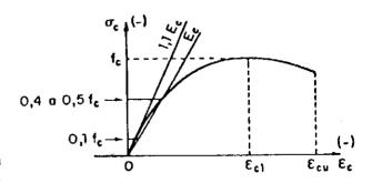
Fig. 2. Diagrama Tensión - Deformación del hormigón.
