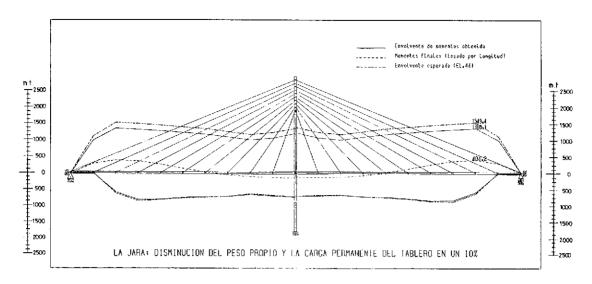
Fig. 8. Envolvente de momentos flectores durante construcción, obtenida en la simulación: Hipótesis: disminución del peso propio un 10 por 100; control de tesado por longitud.
