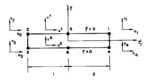
Fig. 2. Elemento isoparamétrico de seis nudos, Clase Cº
