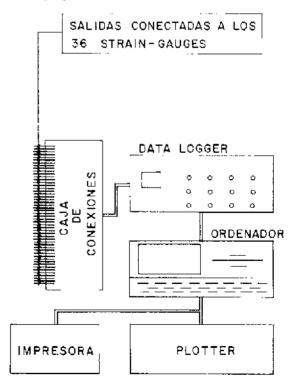
Fig. 11. Esquema de los componentes del equipo de medidas.
