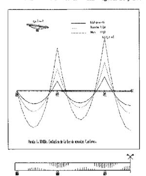
Fig. 26. Puente I. SC400c. Ley de momentos flectores y croquis de la fisuración en rotura,
