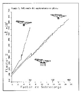
Fig. 33. Puenta I. Evolución del momento flector en la sección sobre la pila 2, según la hipótesis de carga γ la vinculación en pilas intermedías.
