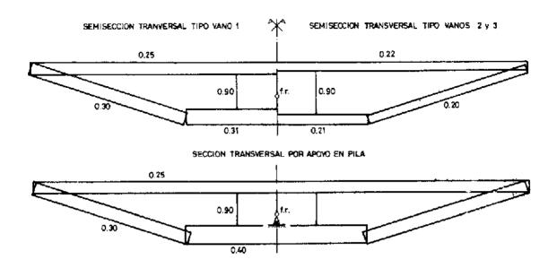
Fig. 21, Puente I, Discretización de las secciones transversales.
