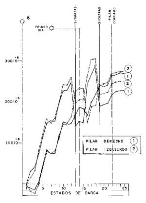
Fig. 20a. Medidas obtenidas con los strain-gauges an los pilares metálicos delanteros.
