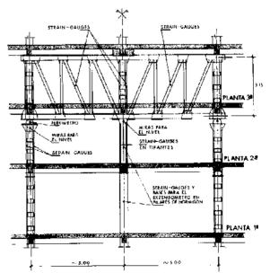
Fig. 7, Esquema de la instrumentación,
