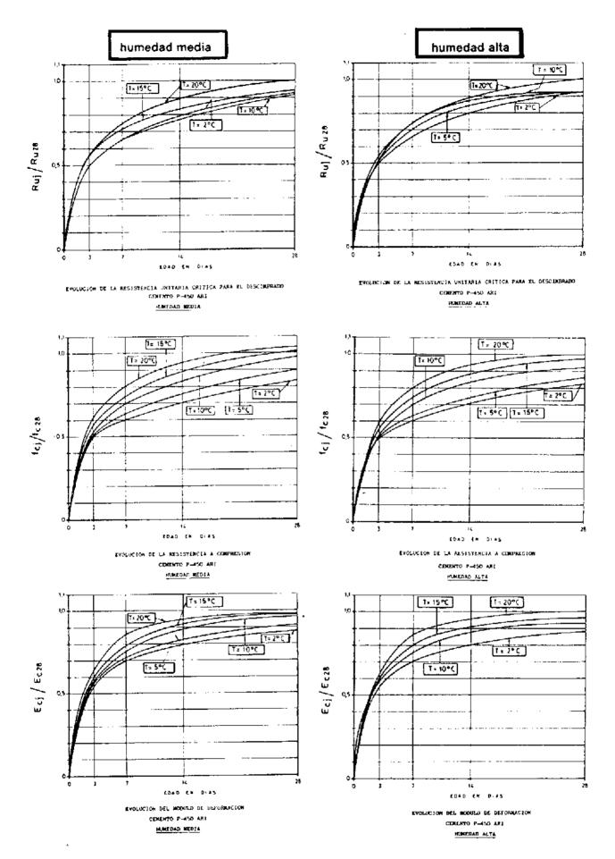
Fig. 4. Curvas de evolución de características mecánicas. Cemento P-450 ABI.
