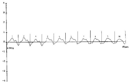
Fig. 2b, Tirante 54, Fuste 1, Canal 12 (Torón 3)  $f = 5.21 H_z$ . 36,4 t.
