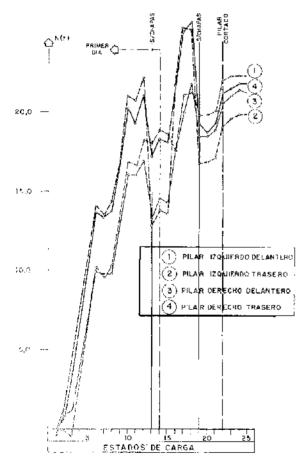
Fig. 22, Variación del esfuerzo normal en los pilatim perálicos.
