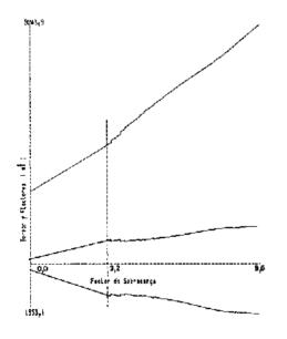
Fig. 14. Evolución de los esfuerzos principales durante el proceso de carga, cuando se aumenta el grado de pretensado.
