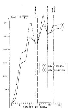
Fig. 17. Flecha en el centro del vano de las vigas metálicas.
