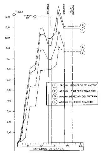
Fig. 16. Variación de la separación entre vigas y pilares.
