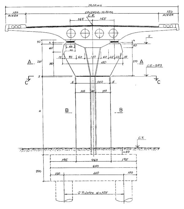
Fig. 14. Diseño de la pila tipo.
