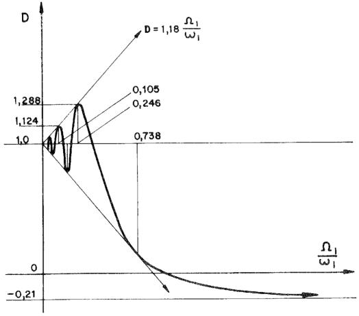
Fig. 2. Valores del coeficiente dinámico.
