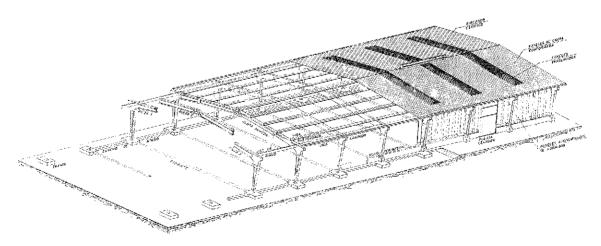
Fig. 1. Perspectiva de los elementos que componen la nave.
