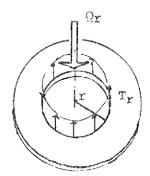
siendo  $Q_r$  la resultante de las cargas que actúan sobre la zona aislada. Nos queda por obtener  $M_r$  y  $M_{\alpha}$ , y al no tener mas que una ecuación, debemos buscar una relación entre ambos, estudiando la forma en que se deforma la placa.
