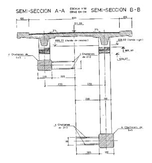
Fig. 2. Sección transversal tipo del Viaducto.
