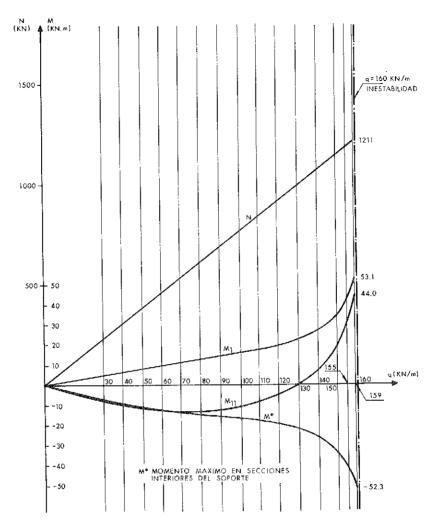
Fig. 11. Variación del esfuerzo axil y los momentos flectores en el soporte derecho, en función de la carga "q".
