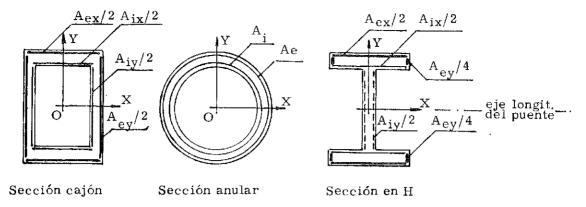
Fig. 3. Definición de las armaduras,
