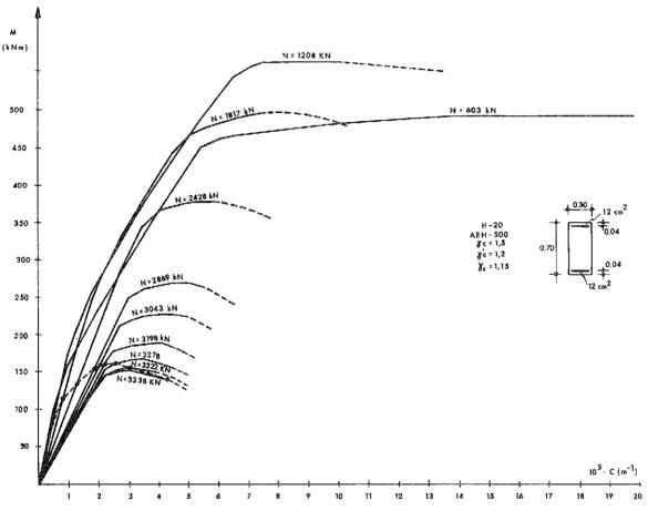
Fig. 17. Diagramas "momentos-curvaturas" del pilar central de la planta 1.ª, para diferentes valores de esfuerzo axil.
