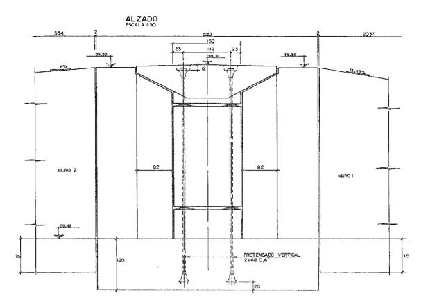
Fig. 15. Pretensado vertical de cosído entre tablero y estribo.
