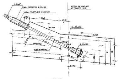
Fig. 13. Anclaje muerto tipo, situado en el tablero.
