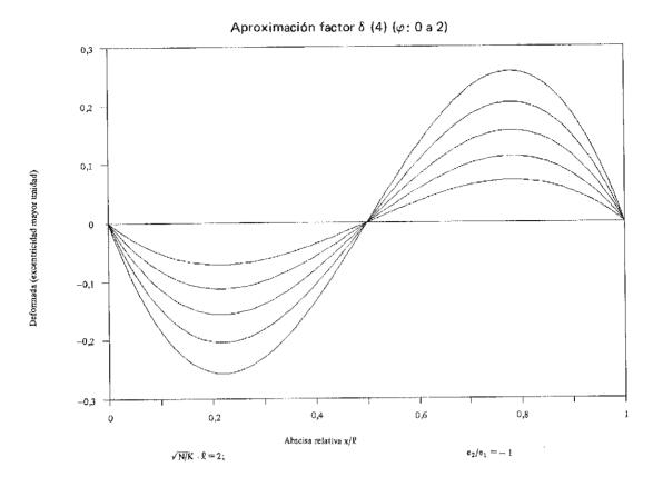
Fig. 3,a Deformadas de la pieza entre t=0 y  $t\to\infty$
