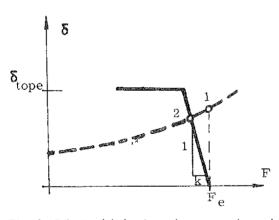
Fig. 6. Cálculo del desplazamiento en cabeza de la pila.
