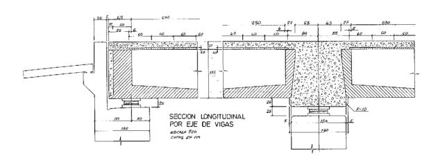
Fig. 4. Detalle de contacto viga prefabricada - riostra de pila in situ,
