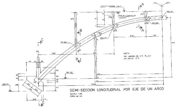
Fig. 3. Semialzado del arco.
