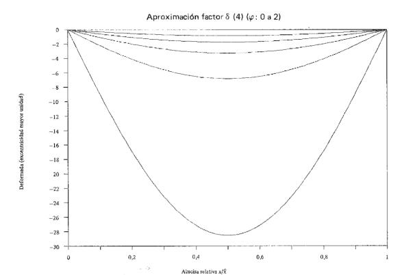
Fig. 3.c. Deformadas de la pieza entre t = 0 y  $t \rightarrow \infty$
