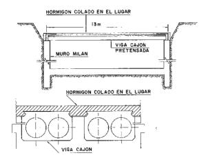
Fig. 10. Estructura de una estación subterránea.
