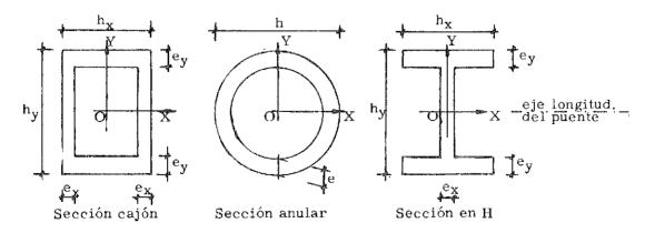
Fig. 2. Definición de la sección.
