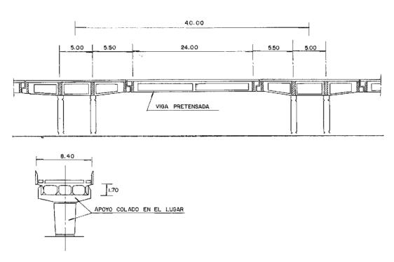
Fig. 11. Secciones en alzado de un paso elevado del sistema de tránsito rápido.
