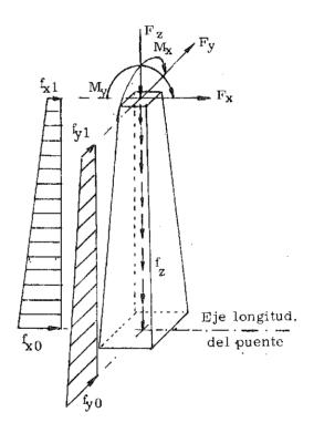
Fig. 4. Cargas aplicadas sobre la pila.
