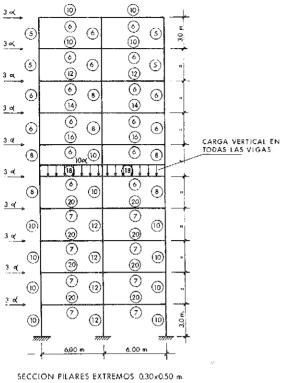
SECCION PILAR CENTRAL 0.30x0.70 m SECCION VIGAS 0.30x0.60 m
