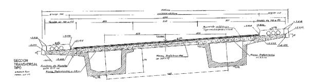
Fig. 1. Sección tipo de tablero de vigas artesa.
