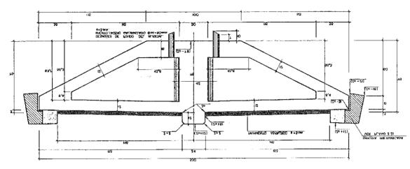
Fig. 12. Sección tipo del tablero,
