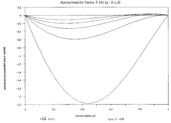
Fig. 4. Deformadas de la pieza entre t = 0 y  $t \rightarrow \infty$
