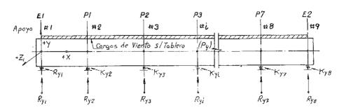
Fig. 2. Tablero en Planta, modelizado como emparrillado plano.
