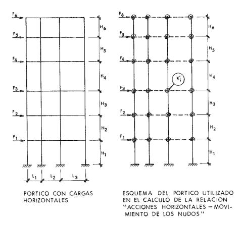
Fig. 2. Esquemas para el cálculo con cargas horizontales.
