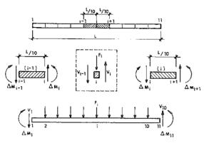
SISTEMA DE FUERZAS EN VIGAS DEBIDO AL COMPORTAMIENTO NO LINEAL DEL MATERIAL
