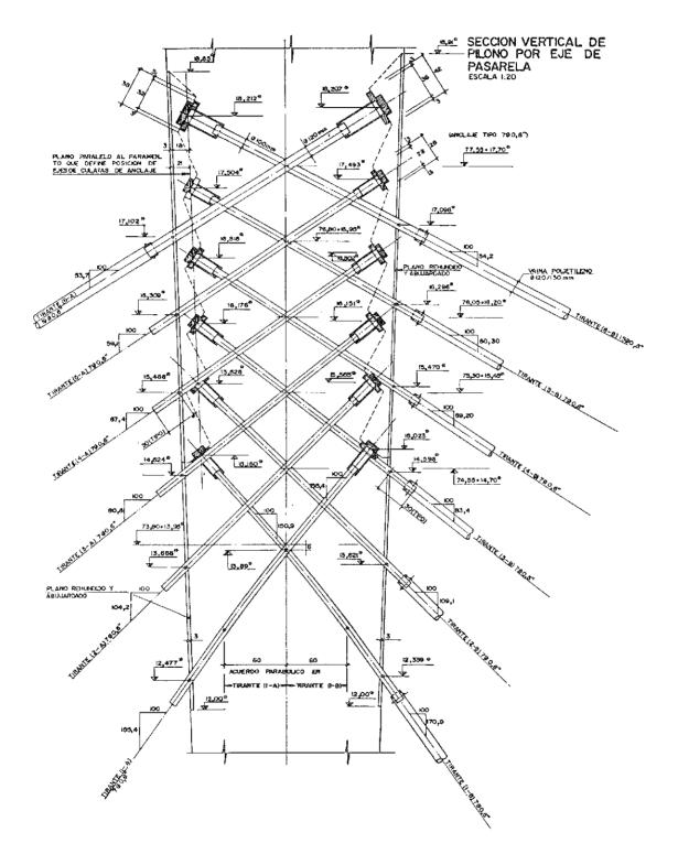
Fig. 14. Anclajes activos en cabeza del mástil.
