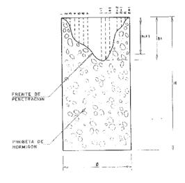
Fig. 2. Discretización del frente de penetración.
