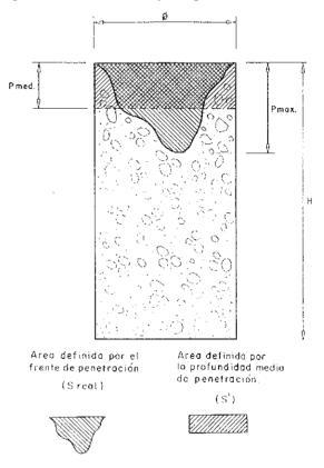
Fig. 1. Profundidades máxima y media de penetración.
