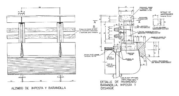
Fig. 8, Detalles de borde del tablero.
