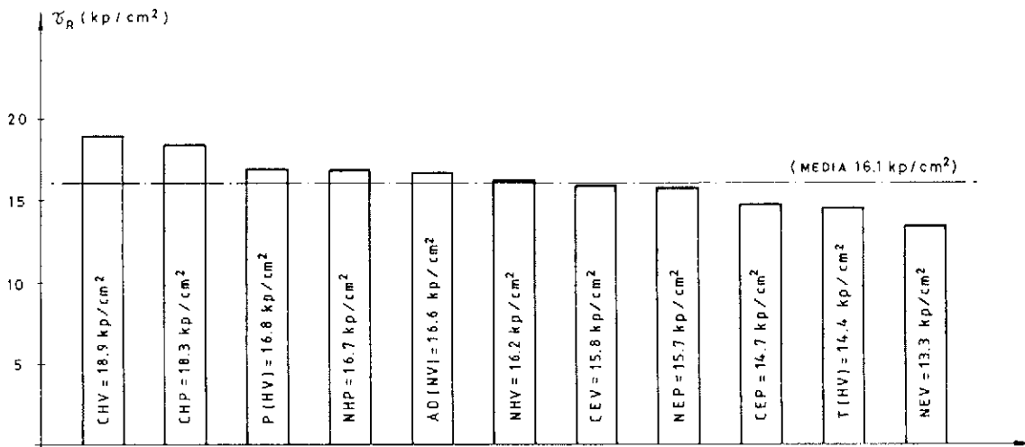
Fig. 13. Resumen de tensiones tangenciales medias en agotamiento (homogeneizadas a hormigones de f_c = 200 \text{ kp/cm}^2 )
