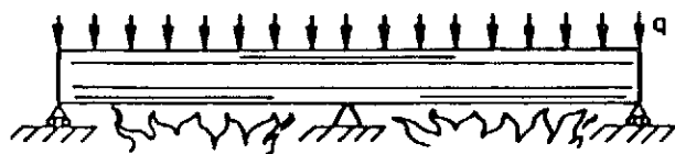
Fig. 14. Resultados de ensayo de vigas \pi de hormigón armado con 4,75 m de luz.
