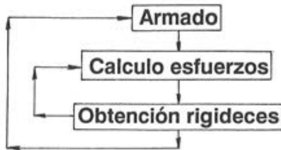
Fig. 2. Análisis no lineal de estructuras de hormigón.
