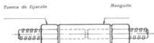
B.1. Manguito roscado sobre barras con corrugado especial, sistema GEWI.
