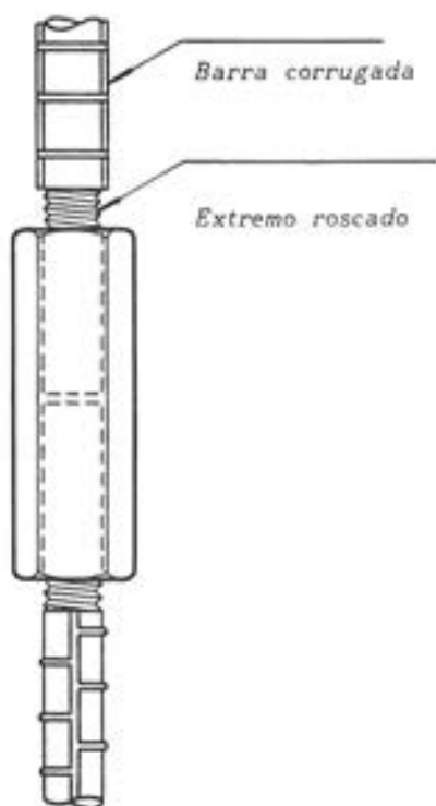
B.2. Manguito roscado sobre barras mecanizadas.
