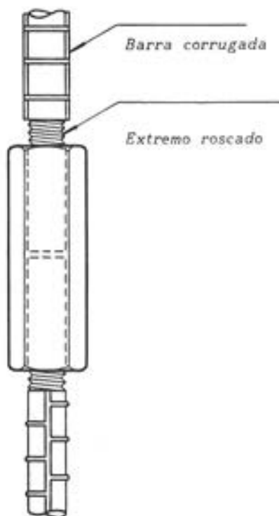
B.2. Manguito roscado sobre barras mecanizadas.
