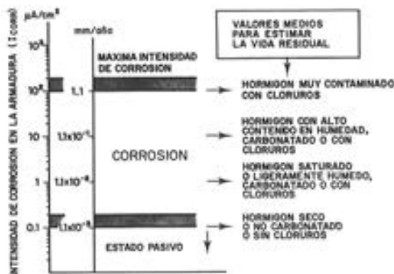
1. Valores de la Intensidad de Corrosión ( \mu A/cm^2 ) y de la profundidad de ataque homogéneo (mm/año) en armaduras.
