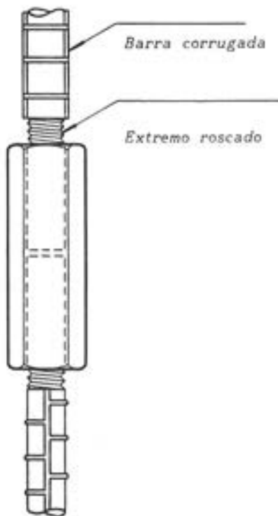
B.2. Manguito roscado sobre barras mecanizadas.
