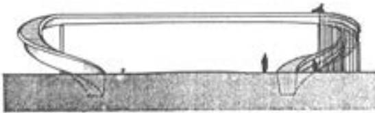
3. Ejecución de tramo derecho, en helicoides, con idéntico procedimiento al utilizado en el lado izquierdo. Ejecución de la losa superior, en segunda etapa, y escalones.
