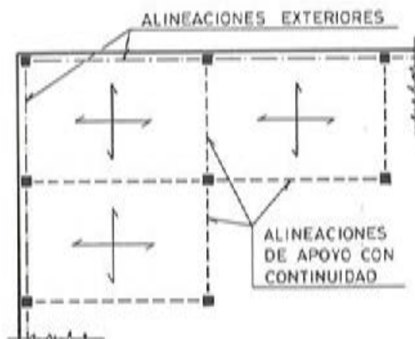
Fig. 6. Alineaciones de apoyo con continuidad de los diferentes nervios de los recuadros perimetrales del forjado.
