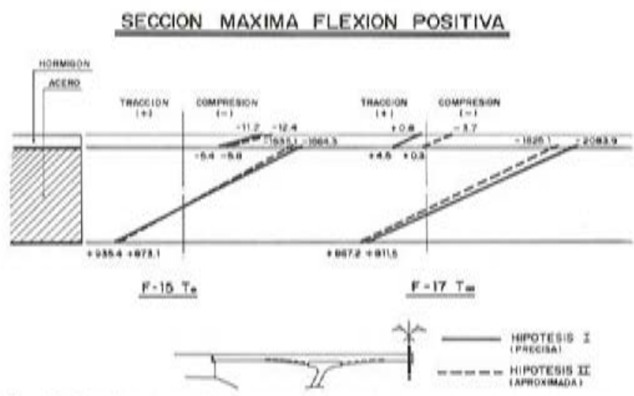
Fig. 10. Distribuciones Tensionales a T_0 y T_m bajo cargas permanentes.
