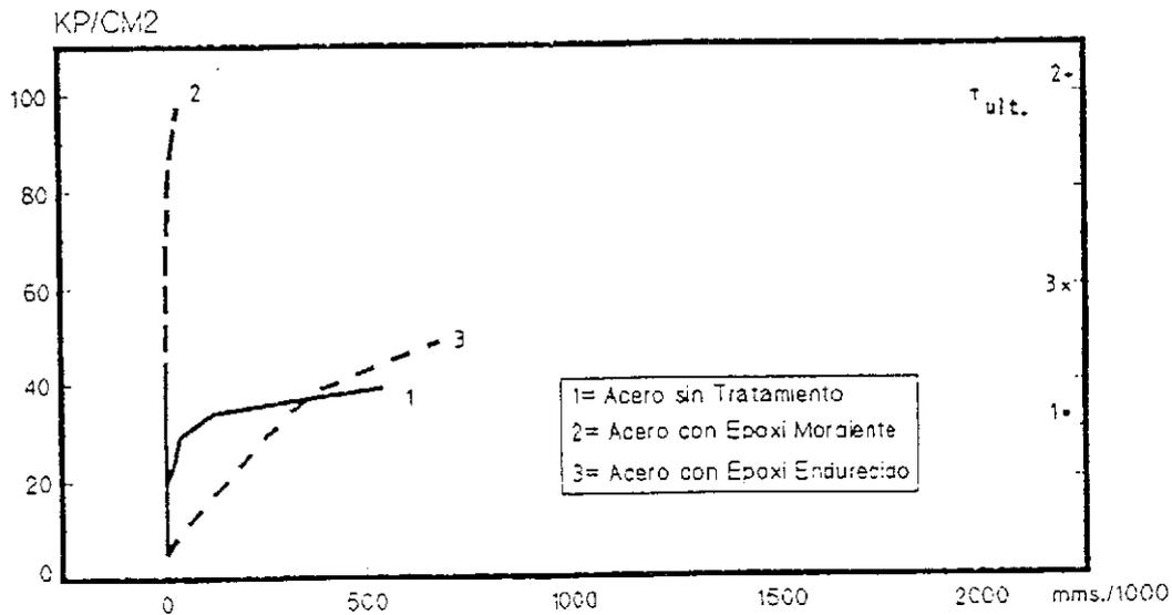
Fig. 8. Gráfica tensión-deslizamiento (180 días, carga monótona, Barras lisas).
