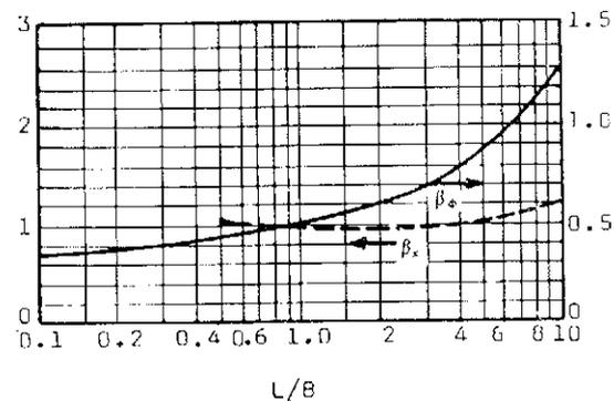
Fig. 2. Coeficientes  $\beta_x$  y  $\beta_\phi$  para cimientos rectangulares (Whitman 1966).
