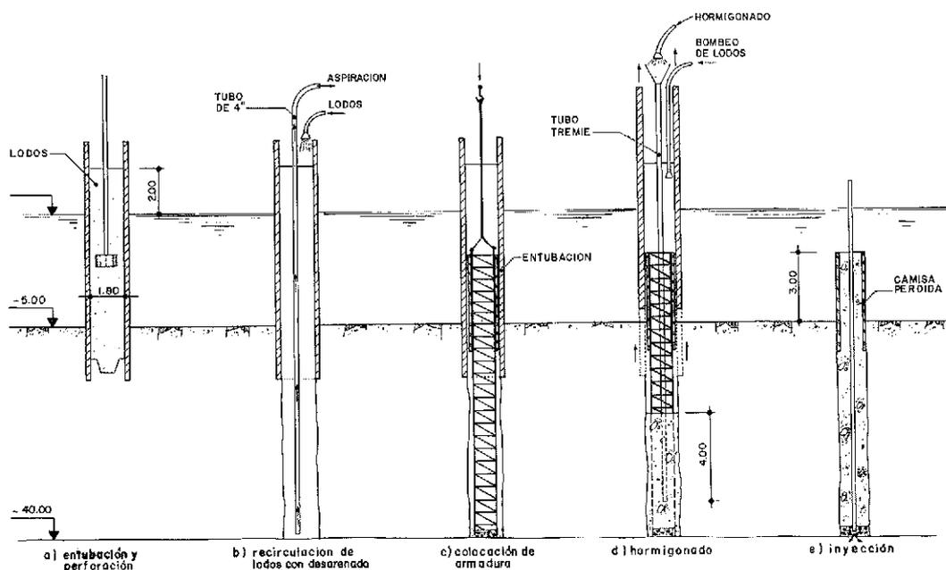
Fig. 5. Ejecución de los pilotes.
