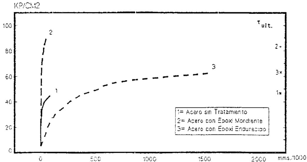
Fig. 7. Gráfica tensión-deslizamiento (28 días, carga monótona, Barras lisas).
