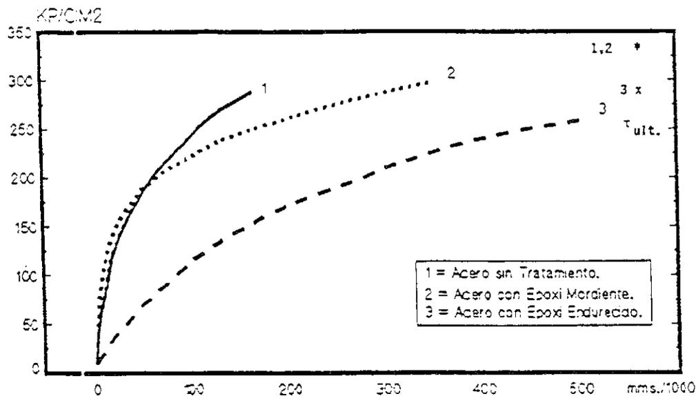
Fig. 2. Gráfica tensión-deslizamiento (28 días, carga monótona, Barras corrugadas).
