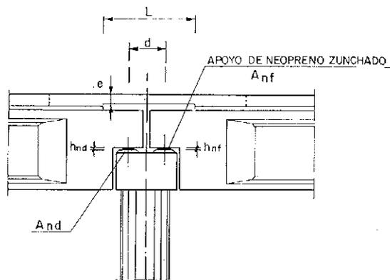
Fig. 3. Parámetros característicos de la losa de continuidad.
