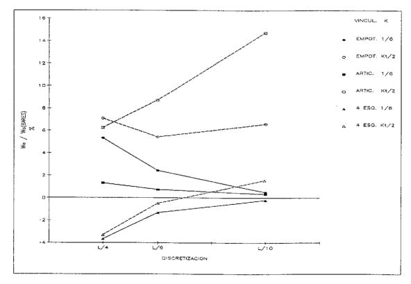
Gráfico 5. Efecto de la rigidez torsional. Placas cuadradas con doble simetría de vinculación. Flecha en el centro de las placas. L = 10 m; h = 0,2 m; E = 2.100.000 t/m²;  $\mu$  = 0; q = 2 t/m².
