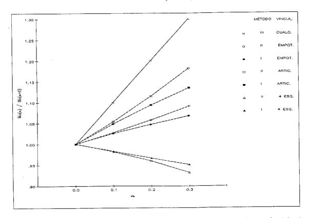
Gráfico 4. Efecto del módulo de Poisson. Placas cuadradas con doble simetría de vinculación. Momentos flectores en el centro de las placas. L=10~m; h=0.2~m;  $E=2.100.000~t/m^2$ ;  $q=2~t/m^2$ ; Discr.: L/10.
