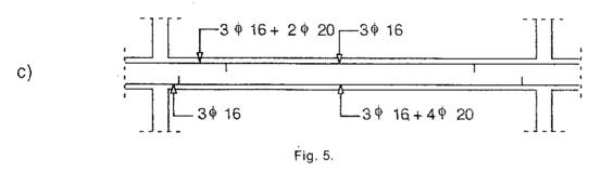
del 15% de los momentos negativos, figura 5 b). La distribución de armaduras obtenidas es la indicada en la figura 5 c).
