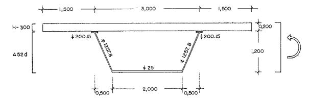
Fig. 8. Sección esquemática de un cajón mixto hormigón acero estructural solicitado en flexión pura "positiva".
