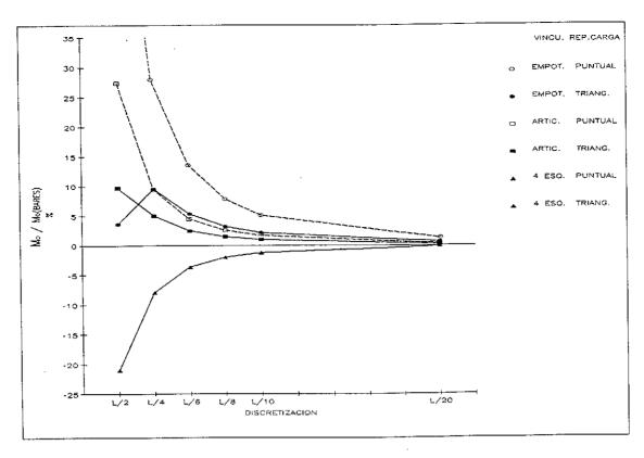
Gráfico 2. Placas cuadradas con doble simetría de vinculación. Momentos en el centro de las placas. L = 10 m; h = 0,2 m; E = 2.100.000 t/m²;  $\mu$  = 0; q = 2 t/m².
