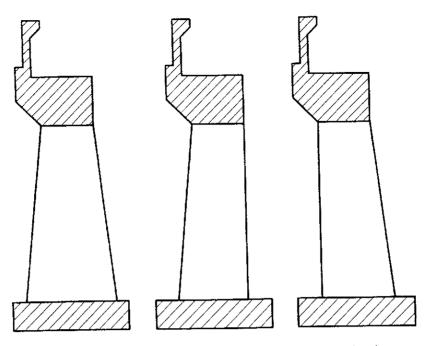
Fig. 3. Esquema de las tres tipologías de estribos abiertos consideradas,
