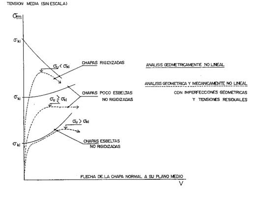
Fig. 3. Diferentes comportamientos postcríticos de las chapas.
