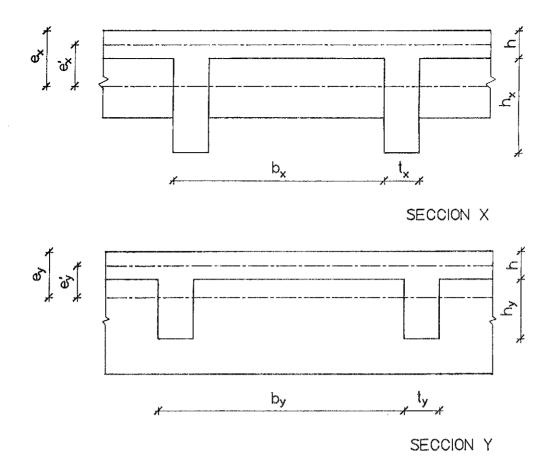
Fig. 8. Secciones-tipo de una placa nervada.
