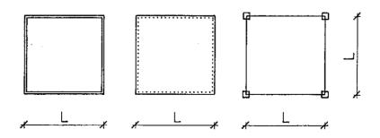
Fig. 7. Placas cuadradas, con doble simetría de vinculación. L = 10 m; h = 0,2 m; E = 2.100.000  $t/m^2$ ;  $\mu$  = 0; q = 2  $t/m^2$ .
