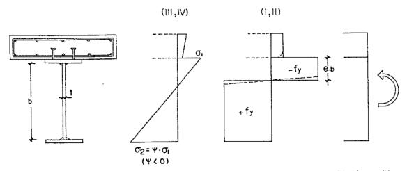
Fig. 1. Distribuciones de tensiones normales en secciones mixtas solicitadas en flexión positiva y con la fibra neutra ubicada en el interior del alma.
