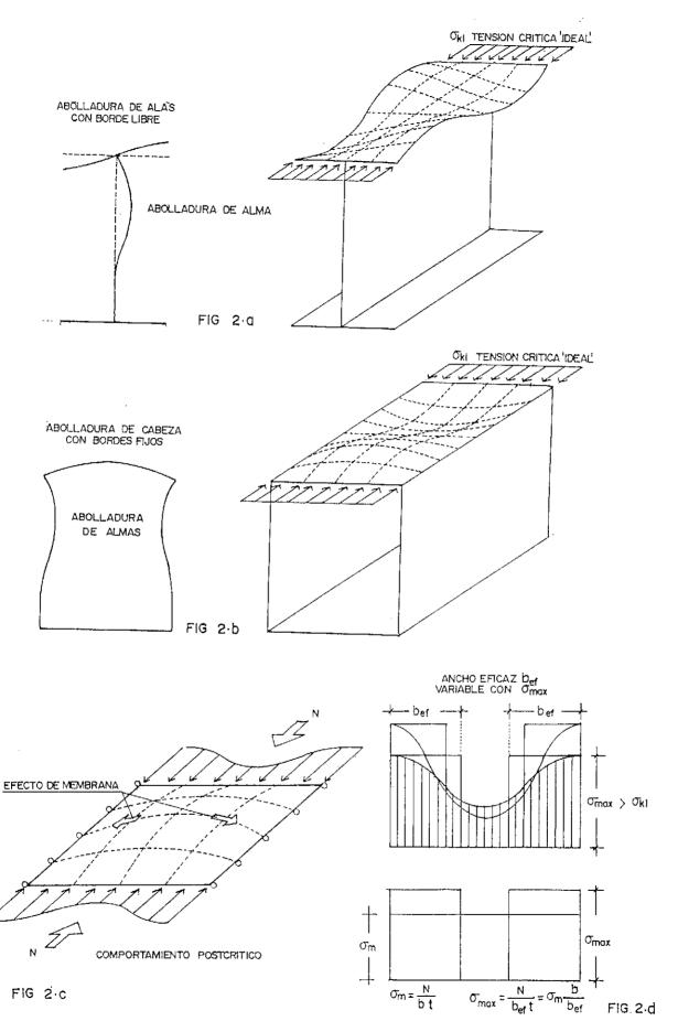
Fig. 2. Abolladura de chapas no rigidizadas.
