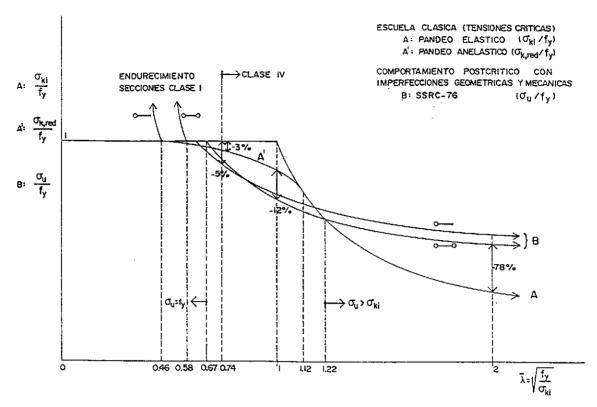
Fig. 4. Inestabilidad de chapas no rigidizadas uniformemente comprimidas.
