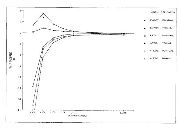
Gráfico 1. Placas cuadradas con doble simetría de vinculación. Flechas en el centro de las placas. L = 10 m; h = 0,2 m; E = 2.100.000 t/m²;  $\mu$  = 0; q = 2 t/m².
