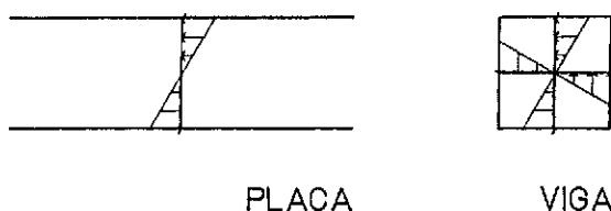
Fig. 2. Tensiones tangenciales en placas y vigas.
