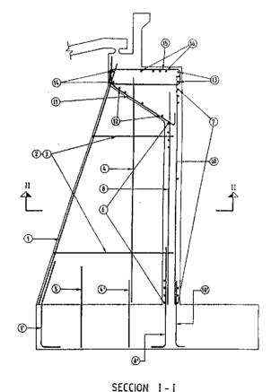
Fig. 9. Croquis de armaduras del alzado de un estribo de contrafuertes.
