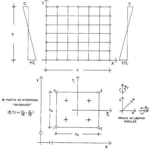
Fig. 6. Discretización en elementos rectangulares de 4 nodos.
