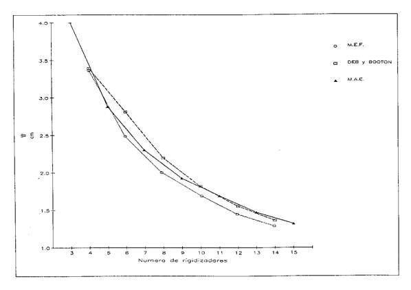
Gráfico 10. Placa nervada cuadrada articulada en el perímetro. Flecha en el centro de la placa. L = 2 m; E = 21.000.000 t/m²;  $\mu$  = 0,2; q = 6 t/m²; h = 0,02 m; h<sub>x</sub> = h<sub>y</sub> = 0,1 m; t<sub>x</sub> = t<sub>y</sub> = 0,01 m.
