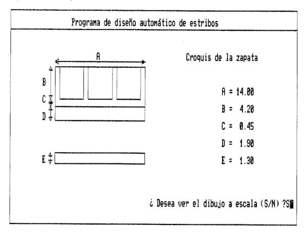
Fig. 13. Salida de la geometria de la cimentación superficial del estribo de contrafuertes de la Fig. 32.
