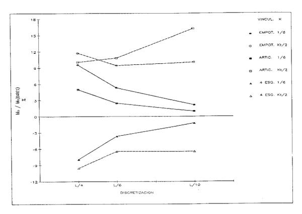
Gráfico 6. Efecto de la rigidez torsional. Placas cuadradas con doble simetría de vinculación. Momentos flectores en el centro de las placas. L = 10 m; h = 0,2 m; E = 2.100.000 t/m²;  $\mu$  = 0; q = 2 t/m².
