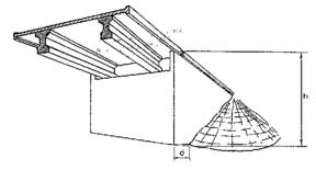
Fig. 6. Perspectiva de un estribo con muros en vuelta. Se indican los datos requeridos por el sistema.
