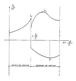
Fig. 11. Envolvente de momentos en la zona delantera.
