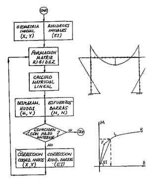
Fig. 4. Cálculo no lineal marcha del proceso.
