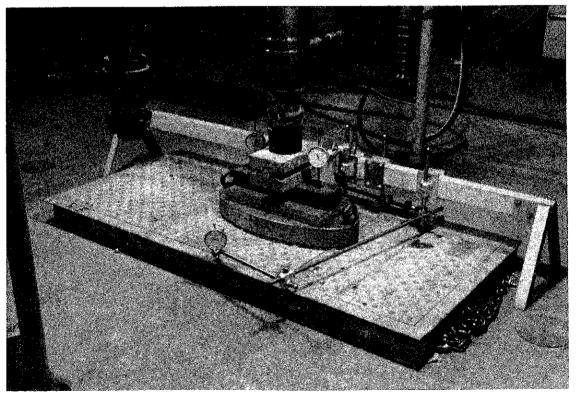
ENSAYO DE TAPAS DE ARQUETA DE UN HANGAR DE IBERIA, FRENTE A LA SIMULACIÓN DE CARGA DE LA RUEDA DE UN JUMBO.
