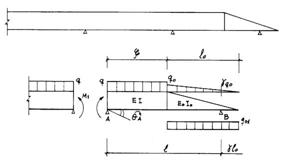
Fig. 5. Cálculo de una posición de empuje después de apoyar
