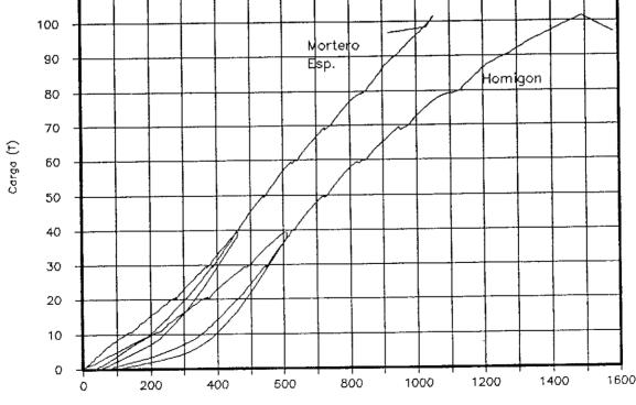
Deformación  $(\mu \varepsilon)$ : Fig. 5. Ello permitirá extraer algunas conclusiones respecto al comportamiento real de los elementos reparados, respecto al cálculo, lo que puede que aconseje establecer algún coeficiente adicional de seguridad; y, al mismo tiempo, ha permitido escoger el método de reparación más adecuado, de los dos investigados, para el tipo de patología contemplado.
