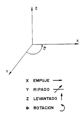
Fig. 1. Movimientos posibles de un tablero
