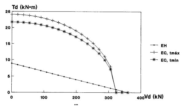
EJEMPLO DE SECCION VIGA 0.25\*0.40 m2 INTERACCION CORTANTE-TORSOR
