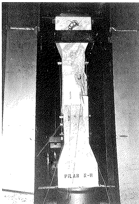
Foto 7. Rotura del pilar nº 11.
