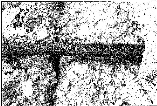
Fig. 6. Ejemplo de rotura sin extricción, detectada en los redondos.
