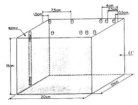
Fig. 1. Modelo de probeta empleada para los ensayos de corrosión de armaduras.
