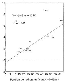
Fig. 5.- Pérdida de radio hasta aparición de fisura <= 0.05, en función de la relación recubrimiento/diámetro.
