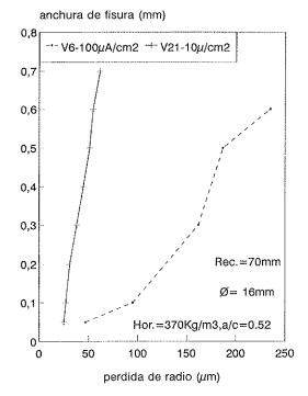
Fig. 7.- Evolución de la fisuración del hormigón en función de la velocidad de corrosión.
