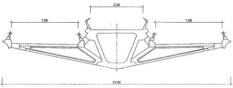
Fig. 2. Sección transversal.
