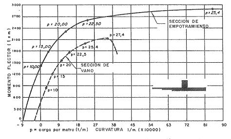
Fig. 12. Diagrama momento-curvatura para la sección propuesta.
