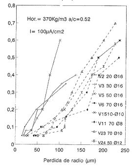
Fig. 6.- Evolución anchura de fisura-pérdida de radio según recubrimiento/diámetro.
