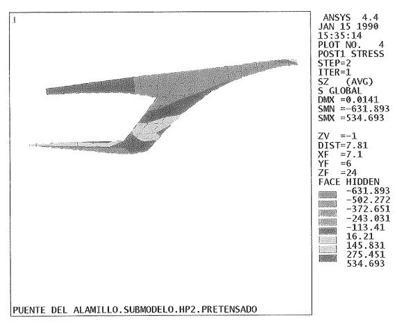
Figura 6. Tensiones longitudinales de pretensado
