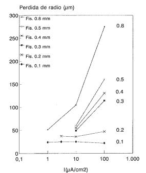
Fig. 8.- Evolución de la fisuración del hormigón en función de: pérdida de radio/velocidad de corrosión.
