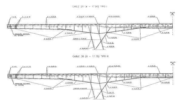
Fig. 5. Sección longitudinal cable de pretensado transversal.
