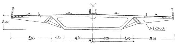
Figura 7. Puente de Badajoz: sección transversal.
