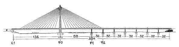
Figura 6. Puente de Badajoz: alzado.
