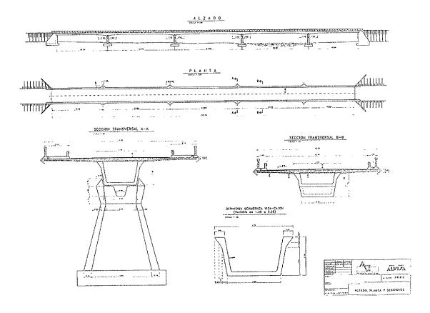
Figura 4. Viaducto de cinco tramos, sobre el río Cinca. Los tres vanos centrales son de 53,00 m de luz, y los dos extremos de 41 m.
