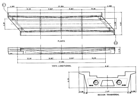
Figura 1. Definición geométrica del tablero.
