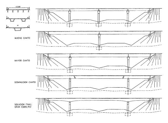
Figura 1. Evolución de los pasos superiores prefabricados.
