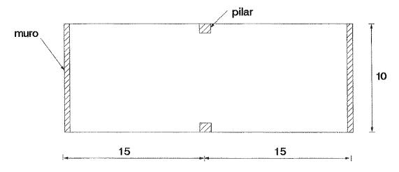
planta de la estructura reticular mixta
