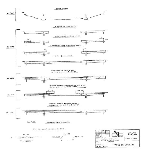
Figura 5. Fases de montaje y hormigonado
