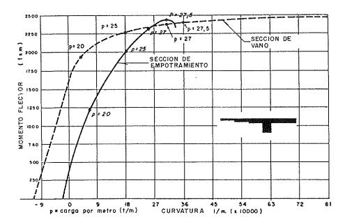
Fig. 13. Diagrama momento-curvatura para la sección invertida.
