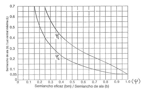
Figura 3. Obtención de coeficientes de ancho eficaz (Y) según norma AASHTO.
