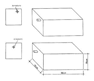
Fig. 1: Probetas de la Serie I
