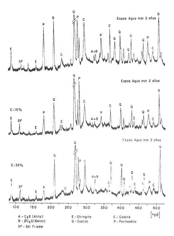
Fig. 6. Difractogramas de hormigones con 0,15 y 35% de cenizas a 2 años de exposición al agua de mar.
