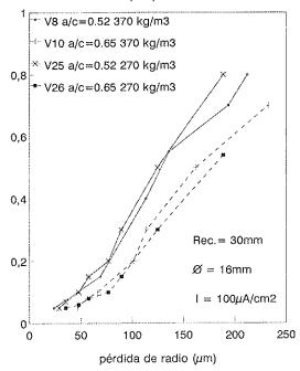
Fig. 9.- Evolución anchura de fisura-pérdida radio según calidad de hormigón
