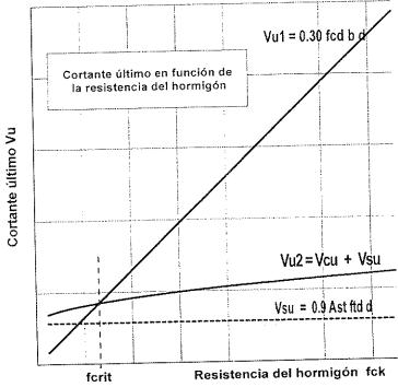
Figura 2. Relación entre el cortante último  $(V_{u1} \text{ y } V_{u2})$  y la resistencia a compresión del hormigón.
