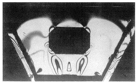
Fig. 4. Acción del esfuerzo tangencial y apoyo elástico.
