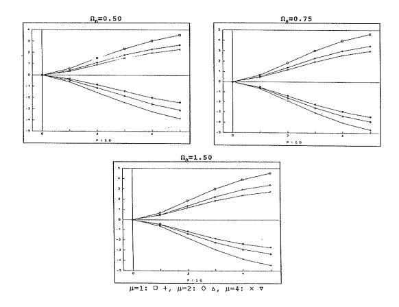
Figura 5c. Influencia del parametro  $\Omega_{\theta}$  en el desplazamiento traslacional del marco 3.
