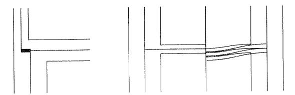
Fig. 1. Problemas incorrectamente representados en los programas de análisis matricial. En el primero, no se considera el descentramiento de las secciones en el equilibrio, por lo que los resultados no están en equilibrio en la geometría real; en el segundo, las luces efectivas pueden suponer una rigidez mucho mayor de la considerada: el dibujo muestra las deformadas con idénticas curvaturas para dos interpretaciones diferentes de la luz.
