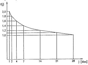
Figura 3. Evolución de la función f(j) en función de la edad de carga.
