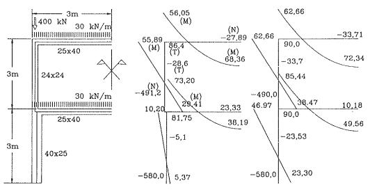
Fig. 7. Esfuerzos del pórtico, con soportes con compresiones importantes. A la izquierda, según el método del nudo extenso, a la derecha, según la formulación tradicional.
