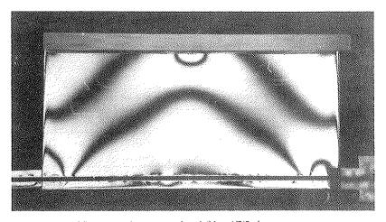
Fig. 6. Viga con placa superior, L/H = 17/9, fuerza aplicada P.
