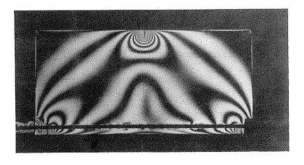
Fig. 5. Viga sin placa superior, L/H = 17/9, fuerza aplicada P.
