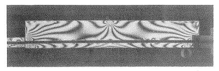
Fig. 8. Viga sin placa superior, L/H = 17/3, fuerzas aplicadas S y P.
