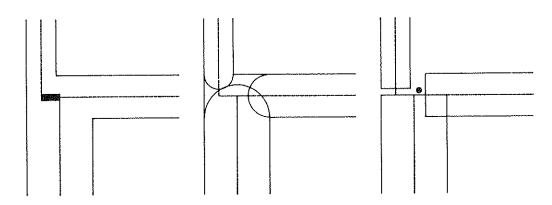
Fig. 2. Configuración convencional de los nudos. Pueden observarse las directrices, la posición del medio canto de las piezas, y posiciones convenidas para los extremos de las barras y para el nudo. Las coordenadas de los extremos de las barras y las del nudo son, en general, diferentes.
