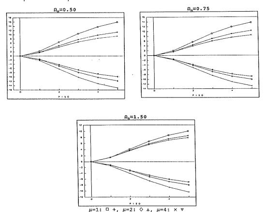
Figura 5a. Influencia del parámetro  $\Omega_{\theta}$  en el desplazamiento traslacional del marco 1.
