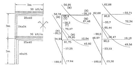
Fig. 6. Esfuerzos del pórtico del ejemplo. A la izquierda, según el método del nudo extenso, a la derecha, según la formulación tradicional. En las barras regruesadas se identifican los esfuerzos a que corresponde cada uno de los números.
