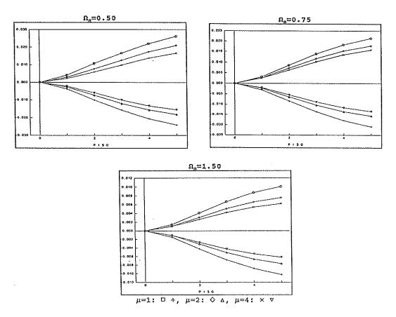
Figura 4. Influencia del parámetro  $\Omega_{\theta}$  en el desplazamiento torsional del diafragma.
