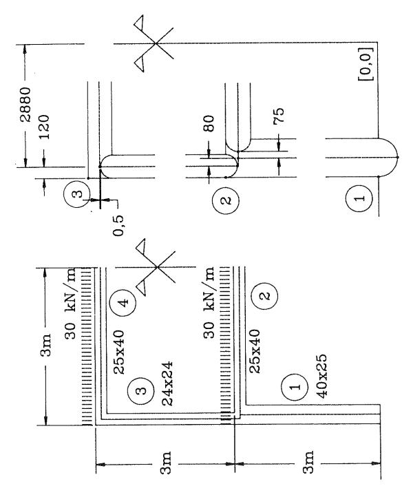
Fig. 5. Problema resuelto: geometría y cargas adoptadas. Se numeran nudos y barras, cuyos extremos 1 y 2 serán los de menores y mayores coordenadas, respectivamente, sitos en los puntos que se identifican gráficamente.
