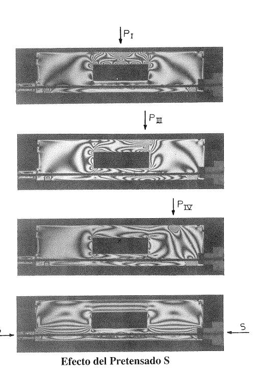
Fig. 11. Isocromáticas obtenidas por la acción de las distintas cargas.
