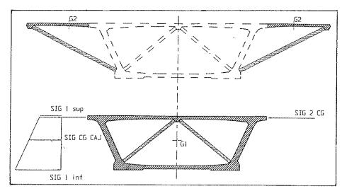
Fig. 4. Sección hormigonada en 2 fases.
