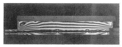
Fig. 7. Viga con placa superior, L/H = 17/3, fuerza aplicada S.
