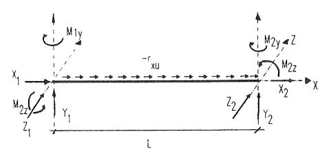
Fig. 8. Cargas equivalentes en Elementos Simples.
