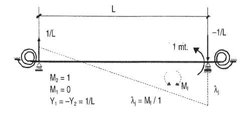
Fig. 10. Acciones para obtener el Coef. de Hiper. local.
