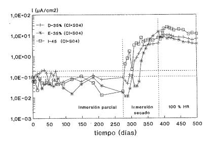
Fig. 8. Evolución de la velocidad de corrosión, Icorr, en probetas de mortero con cenizas, sumergidas en agua de mar artificial, hasta la despasivación de las armaduras y propagación posterior de la corrosión al 100% HR.
