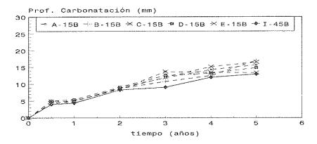
Figura 2. Evolución de la profundidad de carbonatación de hormigones con 15% de ceniza volante.
