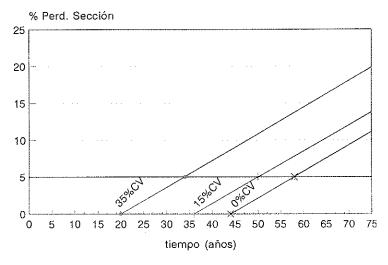
Fig. 5. Diagrama de vida útil en un hormigón con adición de cenizas, ante un problema de carbonatación y corrosión de armaduras.
