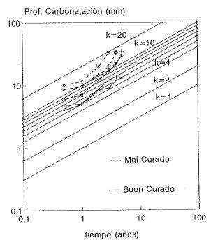
Fig. 3. Determinación de K<sub>CO2</sub> de carbonatación, en hormigones con varias adiciones de ceniza volante.
