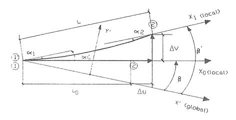
Fig. 20. Barra en posición transformada.
