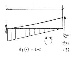
Fig. 16. Esquemas básicos para los coeficientes de flexión.
