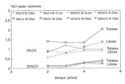
Fig. 10. Evolución del contenido en cloruros totales y libres, a 75 mm de profundidad, en hormigones con y sin cenizas, expuestos en una playa en Huelva. Bien (B) y Mal curado (M).
