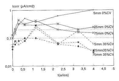
Fig. 9. Velocidades de corrosión en hormigones con y sin cenizas, sumergidos en agua de mar natural.
