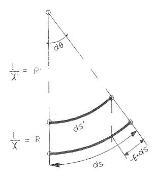
Fig. 21. Variación de la curvatura con el acortamiento.
