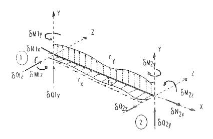
Fig. 3. Acciones Equivalentes a las Deformaciones δε
