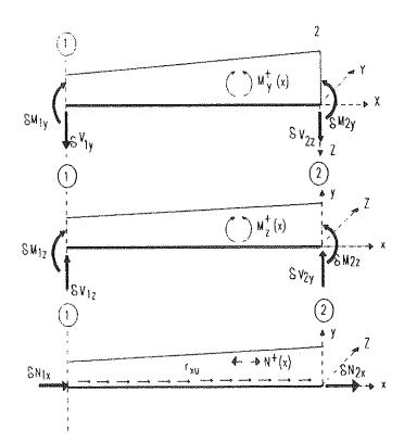
Fig. 5. Leyes lineales debidas a acciones en Bordes.
