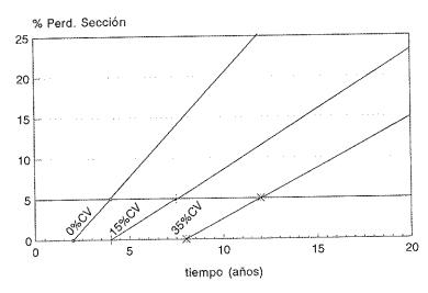
Fig. 11. Diagrama de vida útil de hormigones con cenizas volantes, con riesgo de corrosión por cloruros. Armadura a 30 mm de profundidad.
