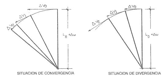
Fig. 22. Iteracciones de Compatibilidad Geométrica.
