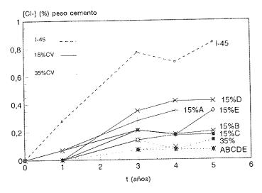
Fig. 6. % de CI totales, en peso de cemento, a 75 mm de profundidad, en hormigones con cinco tipos de ceniza volante (A, B, C, D y E) y sustituciones del 15 y 35%. Exposición en Huelva.
