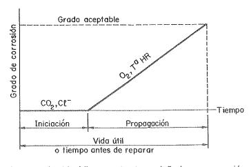
Fig. 1. Diagrama de vida útil para estructuras dañadas por corrosión de armaduras, según Tuutti (4)
