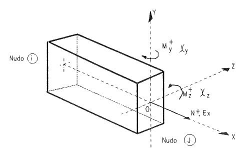
Fig. 1. Ejes locales, Esfuerzos y Deformaciones
