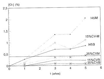
Fig. 7. % de CI totales, promedio de las cinco cenizas, a 75 mm de profundidad, en hormigones con 15 y 35% de ceniza, bien (B) y mal (M) curados, expuestos a la acción del agua de mar. (Huelva)
