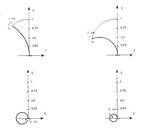
Fig. 25. Evolución de la ménsula con flexión pura, obtenida con el proceso iterativo.
