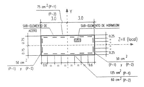
Fig. 18. Discretización de las Secciones de Fustes.
