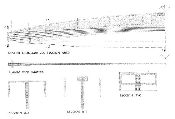
Figura 4. Croquis alzado y secciones postesado.
