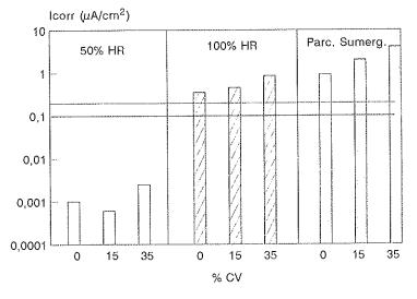
Fig. 4. Velocidades de corrosión límite, medidas en mortero con adición de cenizas y carbonatado. Importancia de la humedad ambiental.
