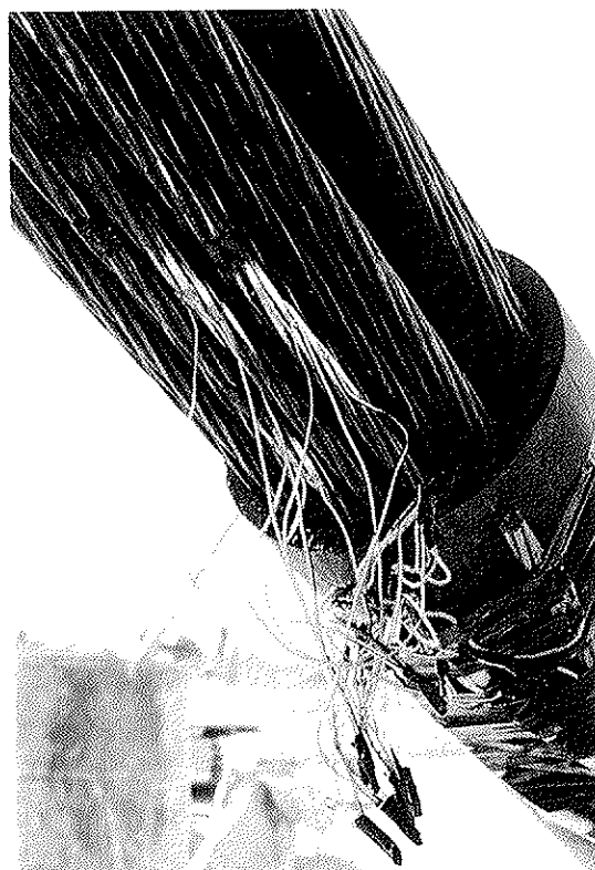
Fig. 5. Bandas extensométricas en tirantes.
