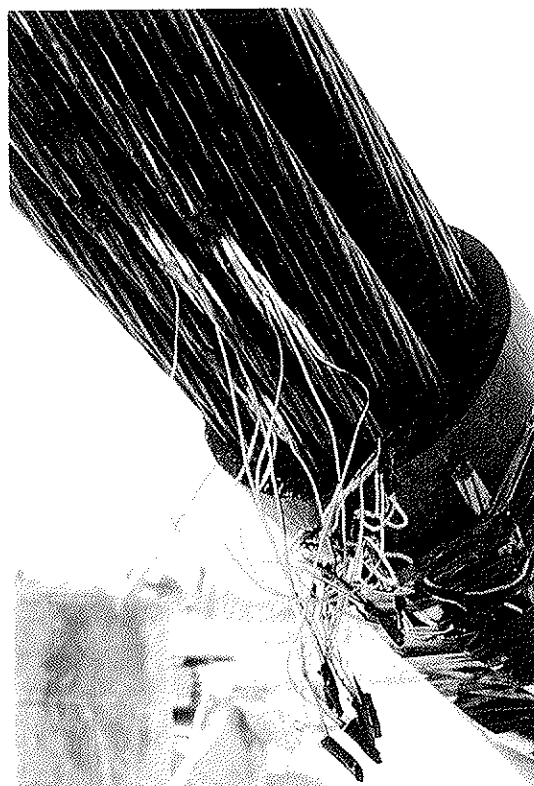
Fig. 5. Bandas extensométricas en tirantes.
