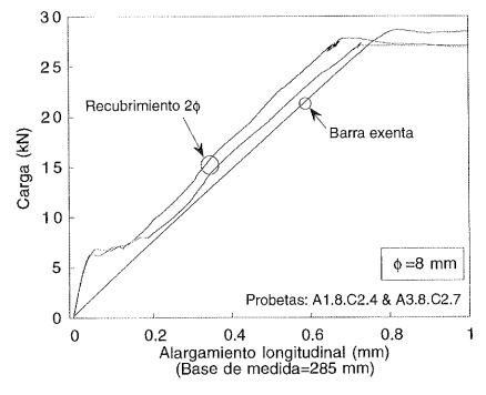
Fig. 8. Curvas experimentales carga *P* frente al alargamiento longitudinal de la probeta (medida entre las caras superior e inferior del prisma de hormigón), para probetas con barra de  $\phi$ 8 y recubrimiento de  $2\phi$ .
