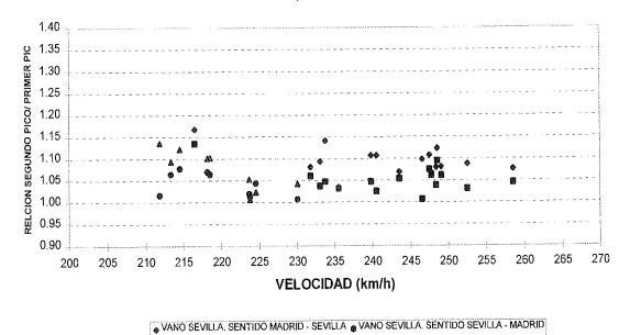
Fig. 9. Relación entre máximos en primer y segundo picos. Velocidades superiores a 200 km/h.
