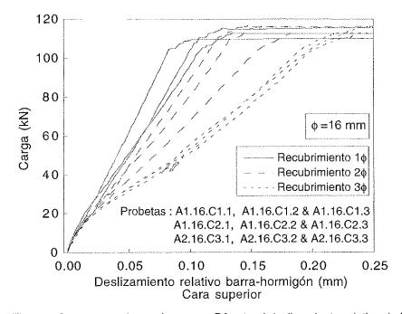
Fig. 9a. Curvas experimentales carga P frente al deslizamiento relativo de la barra respecto de la cara superior del prisma de hormigón; para probetas con barra de  $\phi$ 16 y recubrimientos de  $1\phi$ ,  $2\phi$  y  $3\phi$ .
