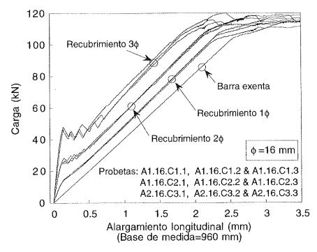
Fig. 7. Curvas experimentales carga P frente al alargamiento longitudinal de la probeta (medida entre las caras superior e inferior del prisma de hormigón), para probetas con barra de  $\phi$ 16 y recubrimientos de 1 $\phi$ , 2 $\phi$  y 3 $\phi$ .
