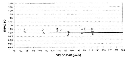
Fig. 7. Coeficiente de impacto para valores netos.
