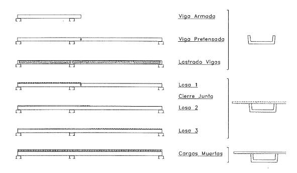
Fig. 4. Etapas fundamentales del proceso constructivo.
