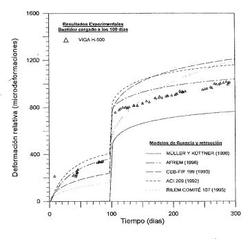
Fig. 8. Deformaciones de fluencia y retracción.
