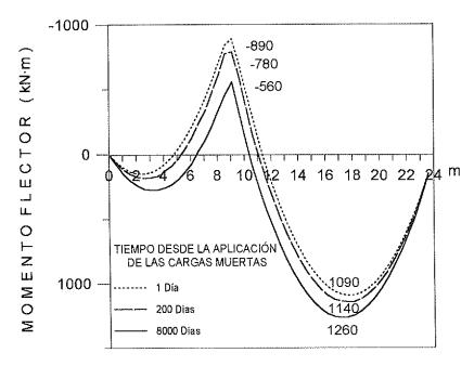
Fig. 12. Evolución de los momentos flectores bajo cargas permanentes.
