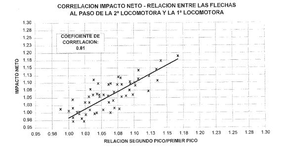
Fig. 10. Correlación coeficiente de impacto - Relación entre máximos, en primer y segundo picos.
