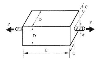
Fig. 4. Geometría de las probetas de hormigón con una barra embebida [9].
