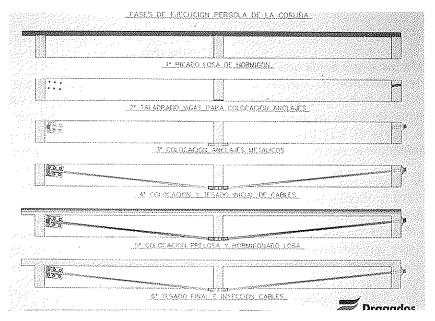
Fig. 2. Proceso de ejecución del refuerzo.
