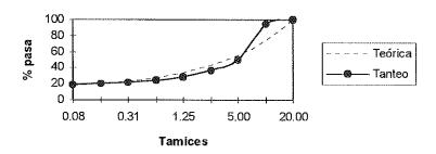
Fig. 3.1. Ajuste granulométrico por compensación de áreas.
