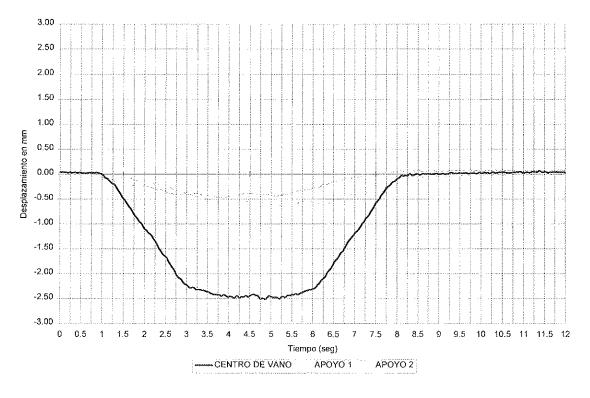
Fig. 3. Registro tipo en las pruebas con locomotoras.
