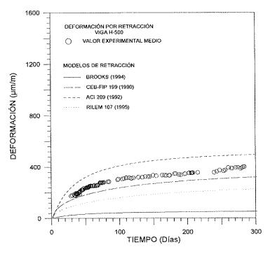
Fig. 7. Deformaciones de retracción.
