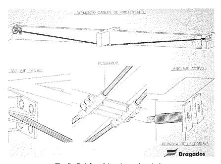
Fig. 3. Detalles del pretensado exterior.
