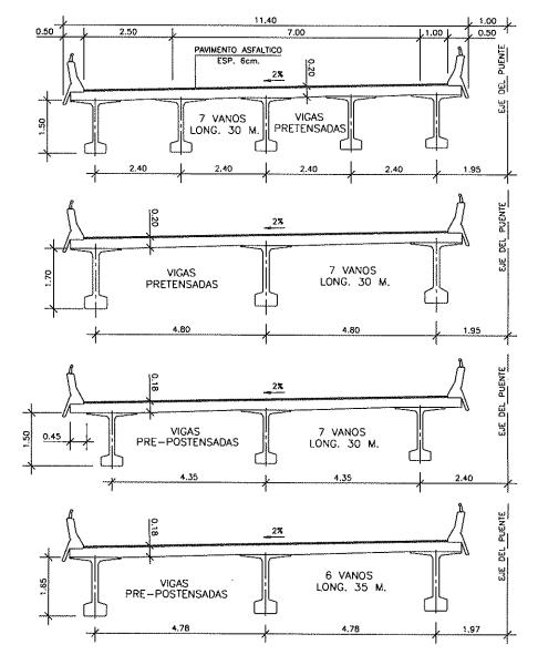
Fig. 1. Solución original con H-450 y soluciones A, B y C con HAR H-800.
