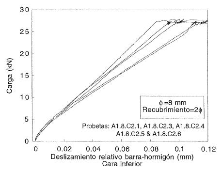
Fig. 10b. Curvas experimentales carga P frente al deslizamiento relativo de la barra respecto de la cara inferior del prisma de hormigón; para probetas con barra de  $\phi 8$  y recubrimiento de  $2\phi$ .
