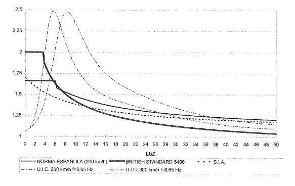
Fig.13. Coeficiente de impacto según distintas normativas europeas.
