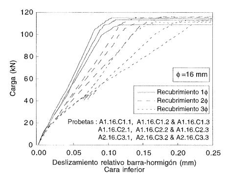
Fig. 9b. Curvas experimentales carga P frente al deslizamiento relativo de la barra respecto de la cara inferior del prisma de hormigón; para probetas con barra de  $\phi$ 16 y recubrimientos de  $1\phi$ ,  $2\phi$  y  $3\phi$ .
