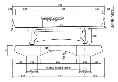
Fig. 4. Sección transversal del puente.
