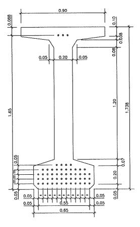
Fig. 5. Sección transversal de la viga.
