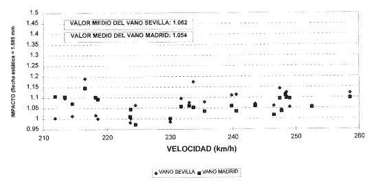
Fig.12. Coeficiente de impacto. Velocidades superiores a 200 km/h.
