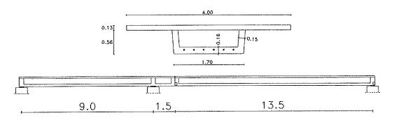
Fig. 3. Esquema transversal y longitudinal del modelo.
