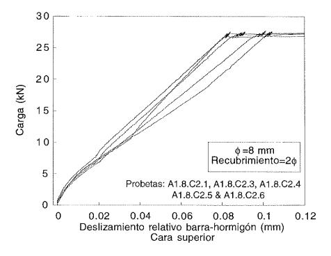
Fig. 10a. Curvas experimentales carga P frente al deslizamiento relativo de la barra respecto de la cara superior del prisma de hormigón; para probetas con barra de  $\phi 8$  y recubrimiento de  $2\phi$ .
