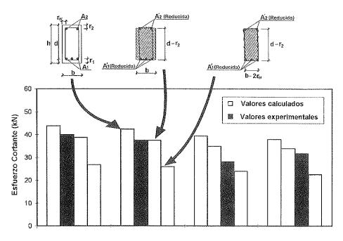
Figura 10. Esfuerzos cortantes últimos en vigas con armaduras corroídas.
