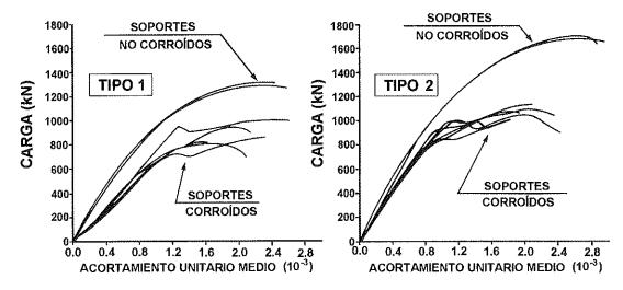
Figura 10. Curva carga-acortamiento unitario medio, en los soportes tipos 1 y 2.
