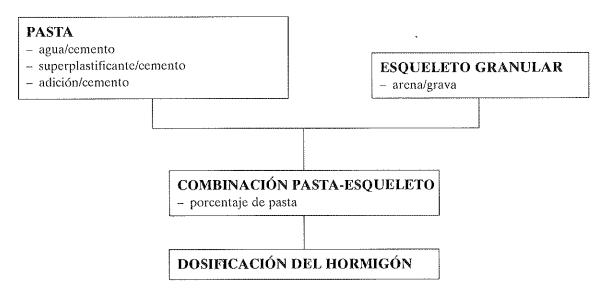
Figura 1. Etapas del método de dosificación para hormigones de altas prestaciones.
