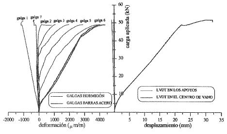
Figura 7. Ensayo a rotura de la viga 2
