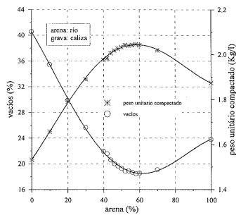
Figura 6. Optimización del esqueleto granular.
