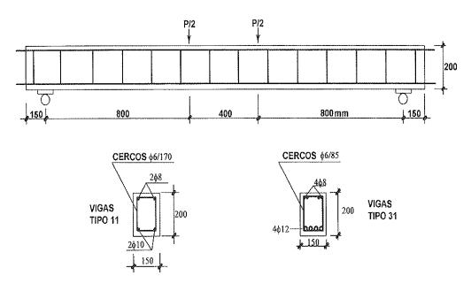
Figura 8. Esquema de algunas vigas ensayadas.
