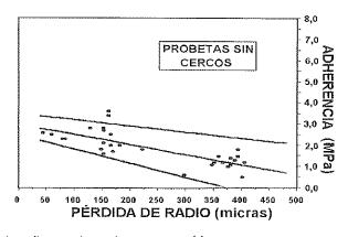
Figura 5. Valores experimentales de la adherencia en barras corroídas.
