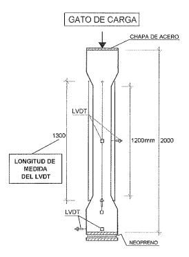
Figura 5. Esquema del dispositivo para ensayo de carga.
