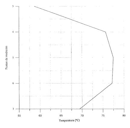
Fig. 23. Distribución de temperaturas con gradiente máximo en vertical, aproximadamente a las 150 horas de la instalación de las sondas.
