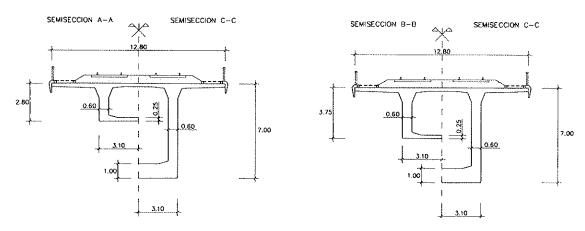
Figura 4. Secciones.
