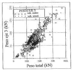
Figura 8. Distribución del peso total del vehículo tipo 8 (Figura 1) entre los distintos ejes.
