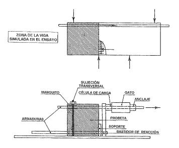
Figura 4. Esquema del ensayo de adherencia.
