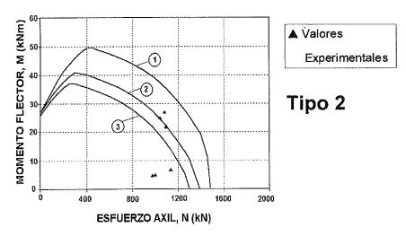
Figura 12. Valores del esfuerzo axil último, Nu, y del momento flector último, Mu, en los soportes corroídos tipo 2.
