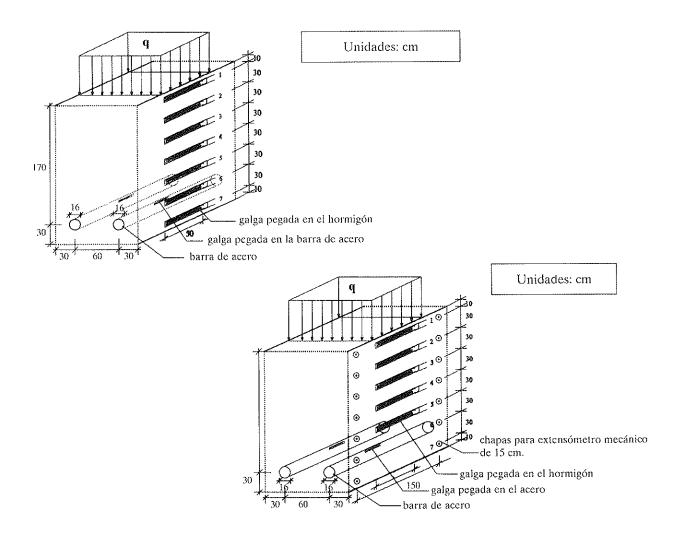
Figura 4. Disposición de los sistemas de medida de deformaciones en la sección central.
