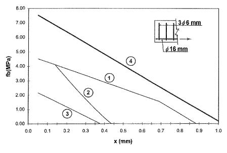
Figura 7. Valor característico de la adherencia residual frente a la pérdida de radio de la armadura.
