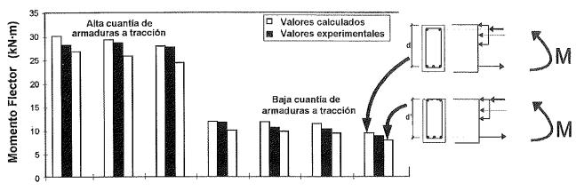
Figura 9. Momentos flectores últimos en vigas con armaduras corroídas.
