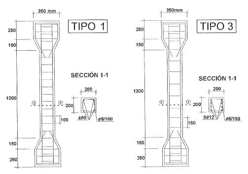
Figura 2. Esquema de los soportes tipos 1 y 3.
