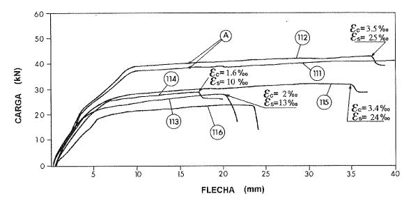
Figura 11. Curvas carga-flecha en vigas con cuantía baja de armaduras (0,5%).
