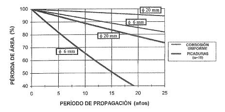
Figura 2. Disminución del área de la sección transversal de las armaduras, para velocidad de corrosión  $l_{corr} = 1 \ \mu A/cm^2$ .
