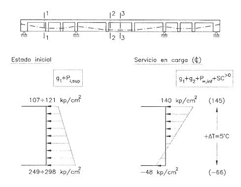
Fig. 12. Resumen de los estados tensionales en secciones críticas en fases de construcción y servicio.
