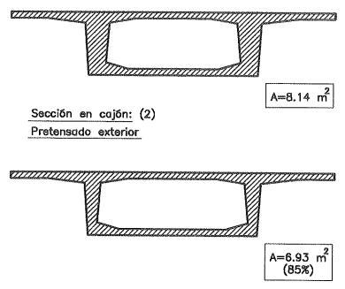
Fig. 2. Evolución conceptual de la sección transversal (I). Secciones en cajón con pretensado interior en almas (1) y con pretensado exterior (2).
