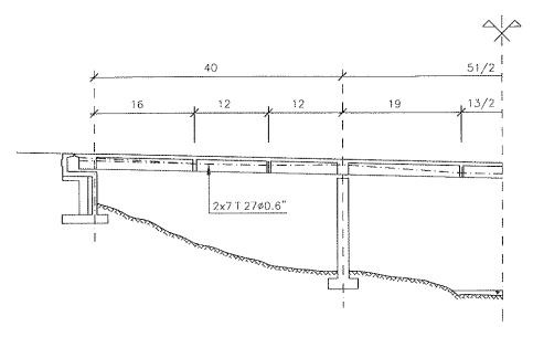
Fig. 7. Esquema del trazado del pretensado en alzado.
