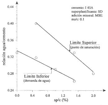
Figura 5. Límite inferior y superior para determinación de la relación agua/cemento.
