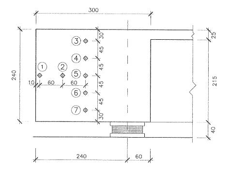
Fig. 19. Disposición de las sondas térmicas para la medición de la temperatura durante el fraguado en la traviesa del lado Calaf.
