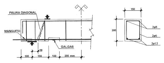
Figura 6. Esquema del ensayo para evaluar la influencia de la presión externa en el valor residual de la adherencia.
