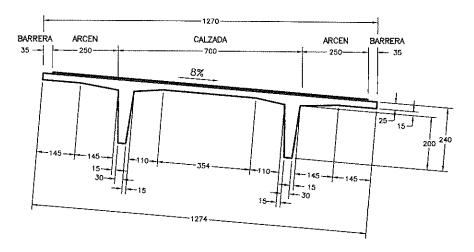
Fig. 4. Sección transversal tipo.
