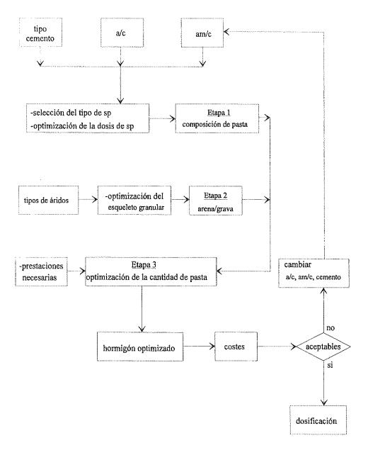
Figura 9. Esquema general del método de dosificación.
