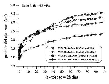
Figura 11. Evolución del eje neutro de la sección central.
