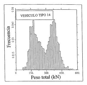
Figura 2. Histograma de la variable "peso total" de los vehículos tipo 11 y 14 de la Figura 1.
