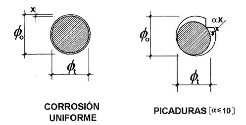
Figura 1. Sección residual de la armadura corroída.
