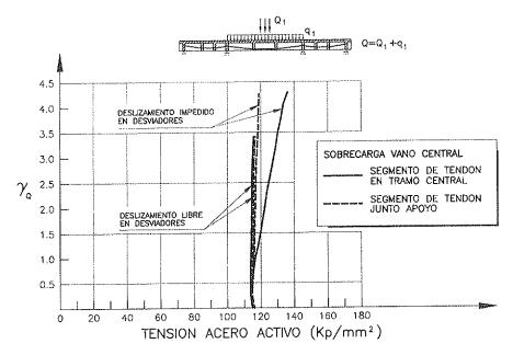
Fig. 15. Evolución de la tensión en el acero de pretensado con las cargas en la sección centro luz del vano central del puente, según los resultados del análisis no lineal. Nótese cómo al ser la distancia entre anclajes extremos muy importante, en la hipótesis de deslizamiento del acero activo sobre los desviadores, el incremento de tensión es casi despreciable.
