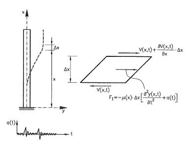
Figura 1. Caso de la excitación sísmica actuando sobre el modelo de viga de cortante.
