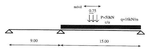
Figura 2: Esquema de carga para obtención del momento flector máximo debido a sobrecargas de uso en el vano pretensado.
