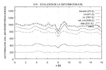
Figura 9. VH1 - Evolución de la deformación axil a lo largo de la viga.
