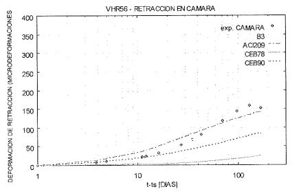
Figura 31. Deformación de retracción. Ensayo en cámara.
