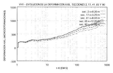
Figura 15. VH1 - Evolución dde la deformación axil en el tiempo.
