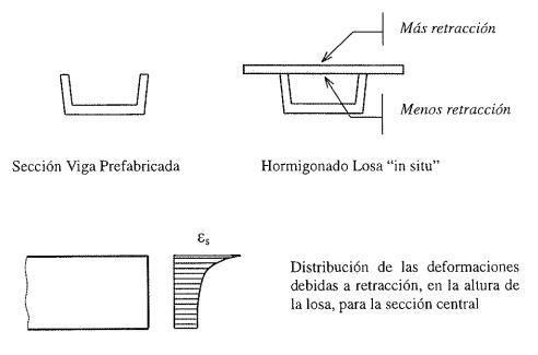
Figura 10: Influencia de la construcción evolutiva en la retracción.
