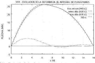
Figura 22. VH1 - Evolución de las flechas a lo largo de la viga (II). Integral de las curvaturas.
