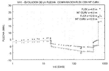
Figura 25. VH1 - Evolución de la flecha en el tiempo. x = 4 y x = 12 m.
