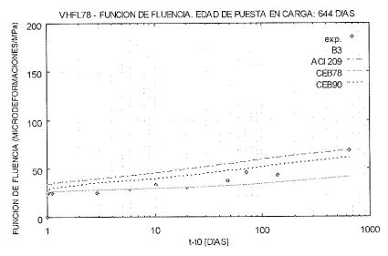
Figura 36. VHFL78 - Función de fluencia.
