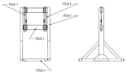
Figura 4. Apoyo en sección central de las vigas.
