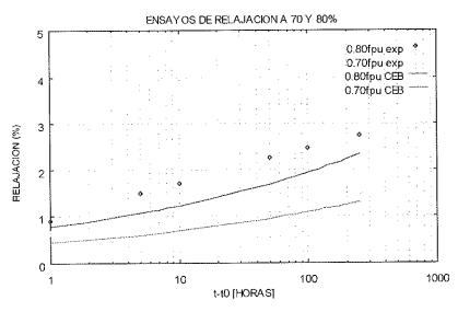
Figura 37. ensayos de relajación para el 70% y 80% de la tensión de rotura.
