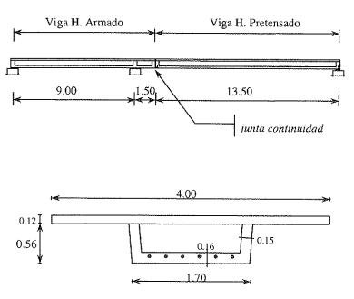
Figura 1: Sección longitudinal y transversal del modelo.
