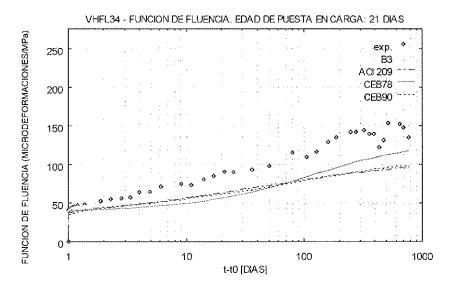
Figura 34. VHFL34 - Función de fluencia.
