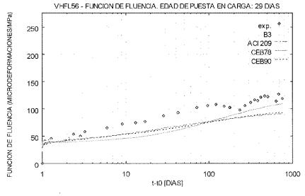
Figura 35. VHFL56 - Función de fluencia.
