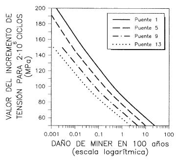
Figura 11. Valores representativos de las curvas S-N utilizadas (incremento de tensión en 2 · 106 ciclos) frente al daño de Miner en 100 años.
