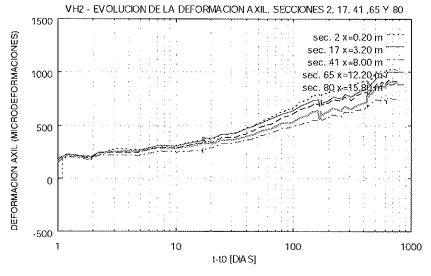
Figura 16. VH2 - Evolución de la deformación axil en el tiempo.
