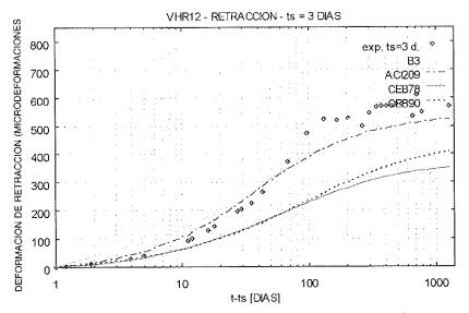
Figura 29. Deformación de retracción. Curado: 3 días en cámara.
