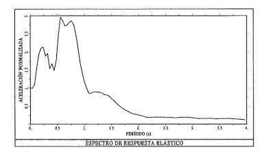
Figura 5. Espectro de respuesta elástico para el sismo de Corralito, de 1989, para 5% del amortiguamiento crítico.
