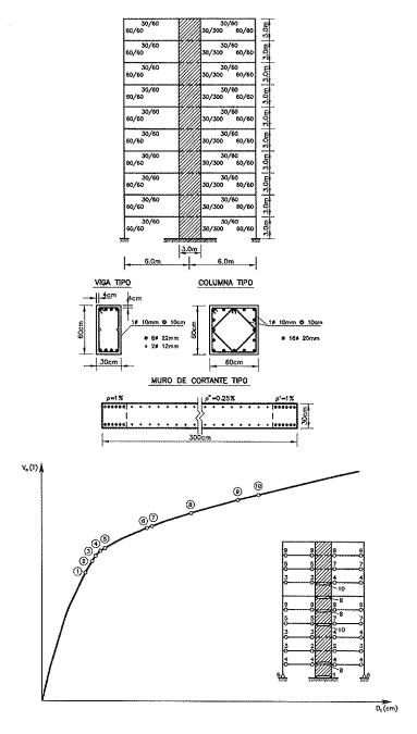
Figura 7. Geometría y curva de capacidad resistente de un pórtico con muro de cortante de diez pisos.
