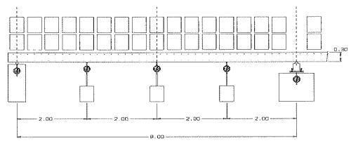
Figura 3. Instrumentación de las vigas.
