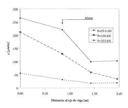
Figura 5: Variación de deformaciones en semi-ancho de losa. Fibra superior.
