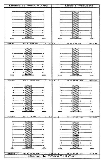
Figura 8. Daño sísmico en un pórtico con muro de cortante de diez pisos, sometido al sismo de Tokachi Oki.
