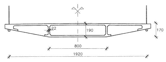
Figura 3. Sección transversal tipo de los 16 puentes estudiados.
