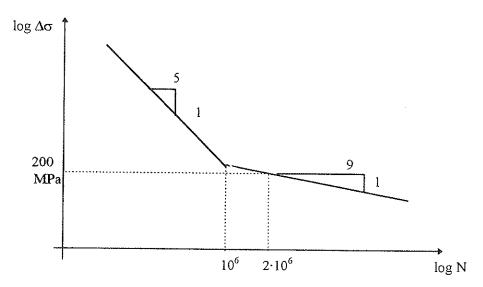
Figura 1. Curva S-N 200 utilizada en el presente trabajo.
