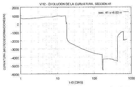
Figura 14. VH2 - Evolución de la curvatura en el tiempo. Sección 41.
