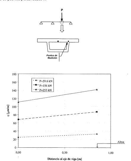
Figura 6: Variación de deformaciones en semi-ancho de losa. Fibra inferior.
