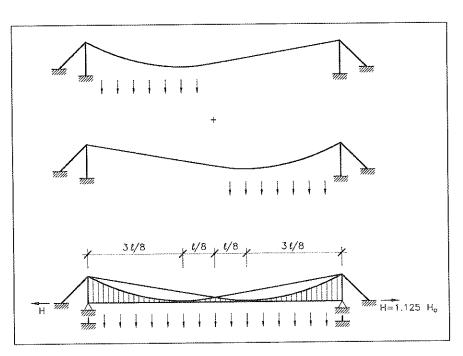
Figura 7. Concepción del sistema dual de cables.
