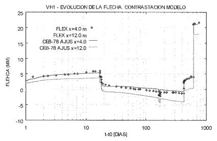
Figura 39. Contrastación del modelo. Flecha en cdv.
