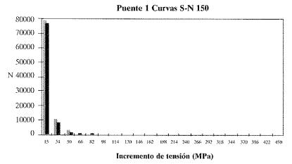
Figura 8. Número máximo y mínimo semanal de incrementos de tensión en cada rango para el puente 1 y la curva S-N 150.
