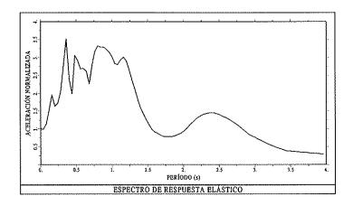
Figura 6. Espectro de respuesta elástico para el sismo de Tokachi Oki de 1968, para 5% del amortiguamiento crítico.
