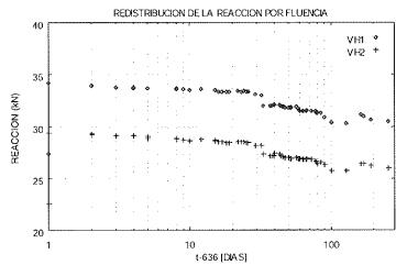
Figura 28. VH2 - Evolución de la reacción en el apoyo central.
