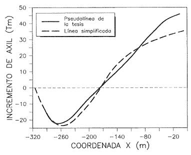
Figura 5. Pseudolínea de influencia del esfuerzo axil en el tirante de retención del puente de referencia frente a línea simplificada para el mismo puente.
