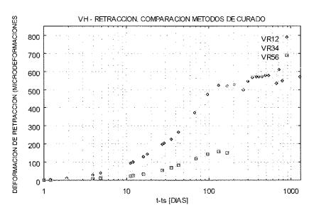
Figura 32. Deformación de retracción. Comparación de los distintos métodos de curado.
