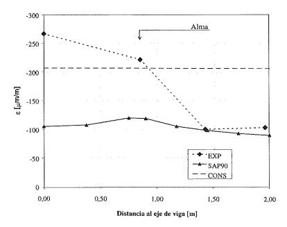
Figura 8: Comparación de deformaciones experimentales y numéricas en semi-ancho de losa, fibra superior, para carga máxima.
