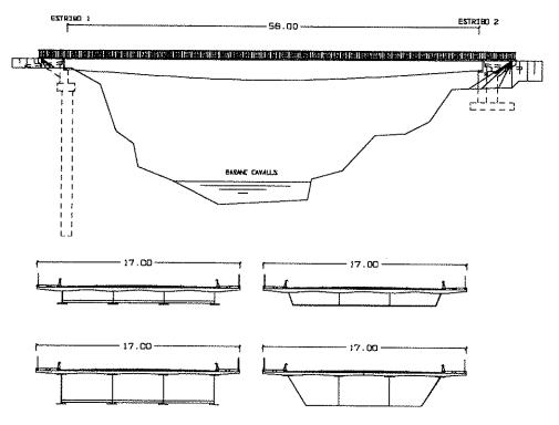
Figura 4. Solución n.º 2. Viga mixta de canto variable.
