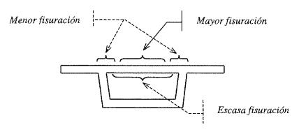
Figura 11: Estado de fisuración previo del modelo.
