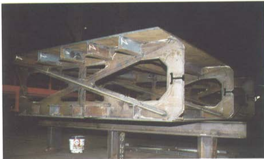
Figura 22. Fabricación de pilas. Figure 22. Pier production.
