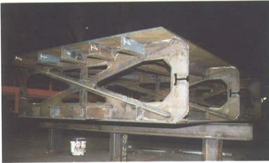
Figura 22. Fabricación de pilas.
