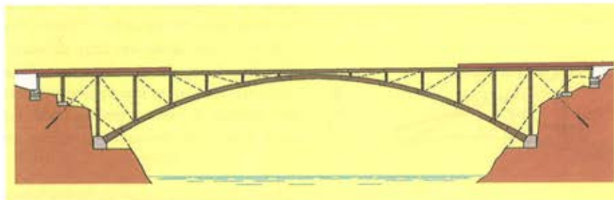
Figura 13. Colocación de forjado. Figure 13. Positioning the deck slabs.
