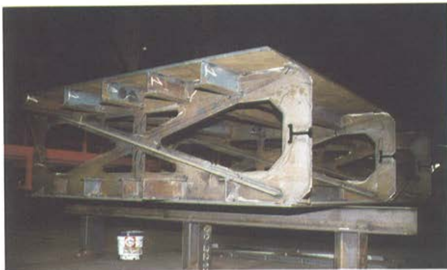
Figura 22. Fabricación de pilas. Figure 22. Pier production.
