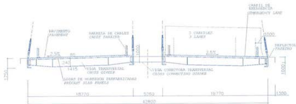
Figura 12. Sección transversal típica del tablero. Figure 1. Typical cross section of deck.
