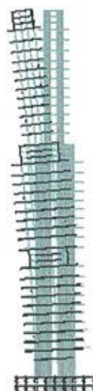
Primer modo de vibración (Período = 4.065 seg) 1 st mode (Period = 4,065 sec)
