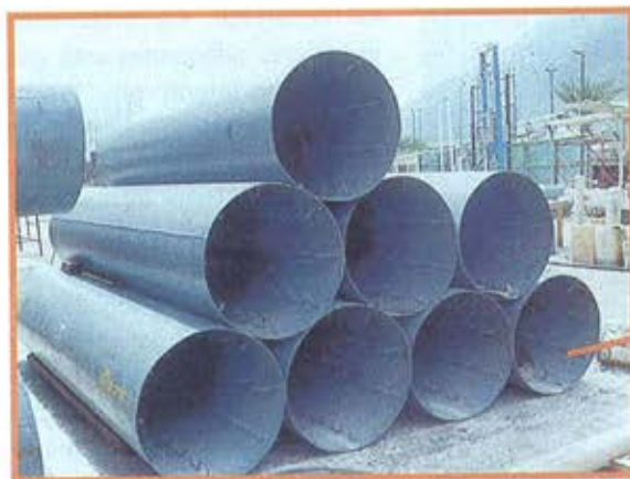
Figura 8.- Tirantes homogeneizados. Tubos metálicos exteriores. Figure 8.- Homogenized stays. External steel pipes.
