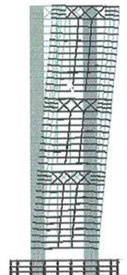
Segundo modo de vibración (Período = 3.028 seg) 2 nd mode (Period = 3,028 sec)
