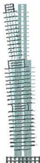
Primer modo de vibración (Período = 4,065 seg) 1 st mode (Period = 4,065 sec)
