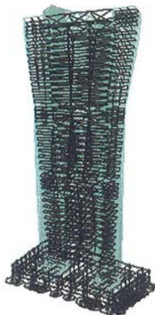
Quinto modo de vibración (Período = 0,969 seg) Fifth mode (Period = 0,969 sec)
