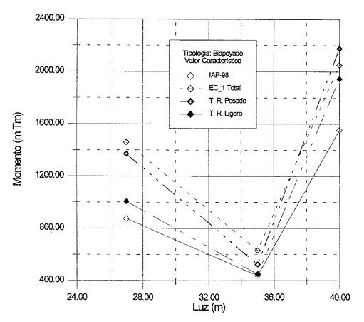
Figura 15. Valor característico de la solicitación de tráfico en función de la luz. Puentes biapoyados.
