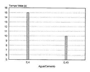
Figura 4. Consistometrías de optimización del hormigón en masa testigo.
