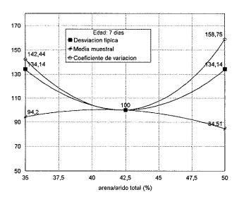
Figura 13. Estadísticos de tensión de rotura en % sobre los obtenidos para dosificación optimizada.
