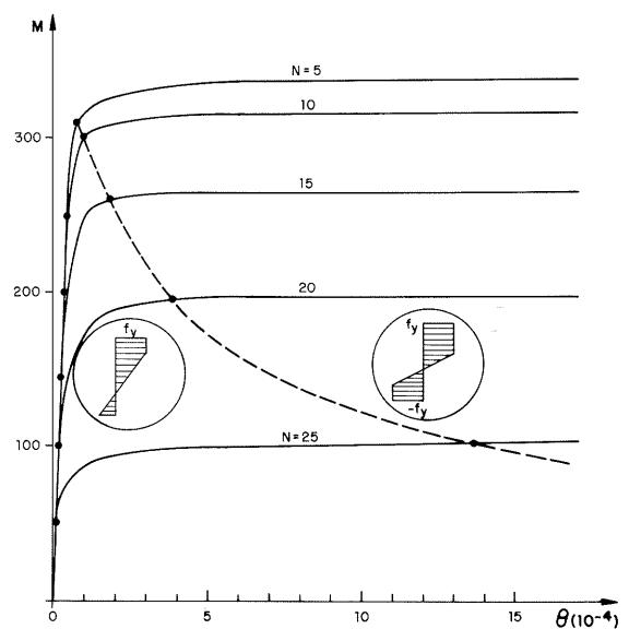
Figura 4. Diagramas momento-curvatura para una sección anular.
