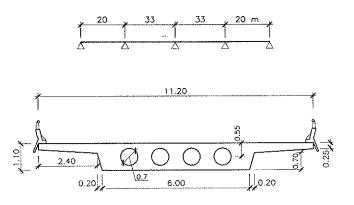
Figura 5. Tipología longitudinal y sección transversal del puente de 33 m de luz principal.
