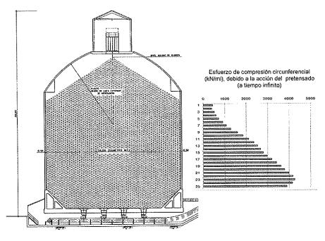
Figura 6. Diagrama de esfuerzo de tracción circunferencial en paredes de silo, producida por el empuje del material con silo totalmente lleno y diagrama de compresión circunferencial, debida a la acción del pretensado.
