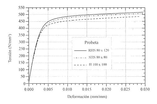
Figura 2. Curva tensión-deformación para las probetas ensayadas.
