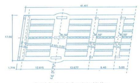
Figura 9. Semiplanta de aligeramientos del tablero. Figure 9. Voided slab semiplan.
