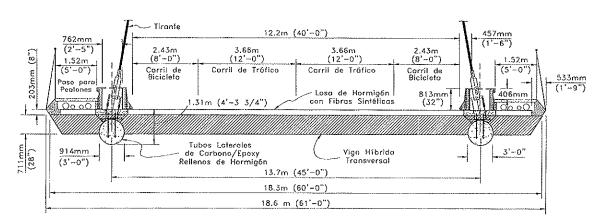
Figura 5. Sección transversal del puente I5/Gilman (1'=0.3048m; 1"=0.0254m).
