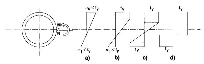
Figura 3. Comportamiento elastoplástico de la sección.
