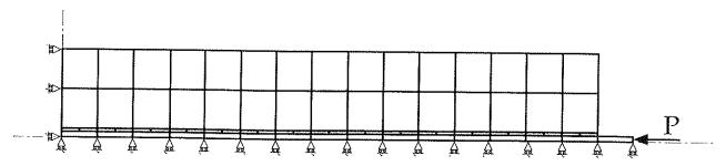
Figura 16. Condiciones de contorno en el cálculo por elementos finitos.
