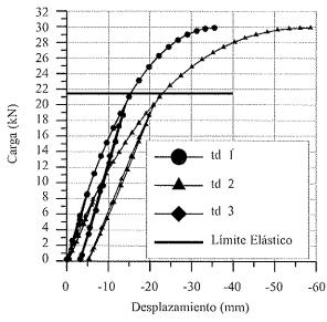
Figura 8. Curvas carga-desplazamiento en los transductores de la viga biapoyada SHS 80 x 80.
