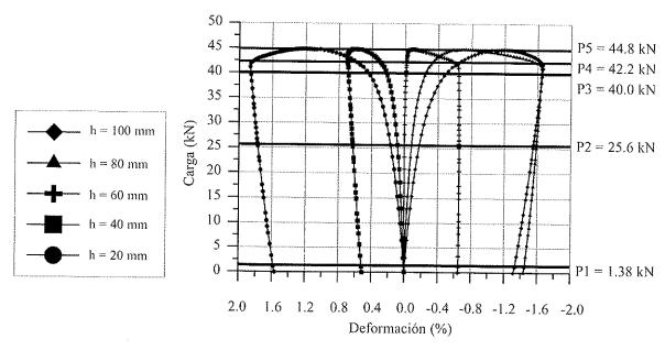
Figura 14. Curvas carga-deformación obtenidas para las cinco galgas de la segunda viga RHS  $80 \times 120$ .
