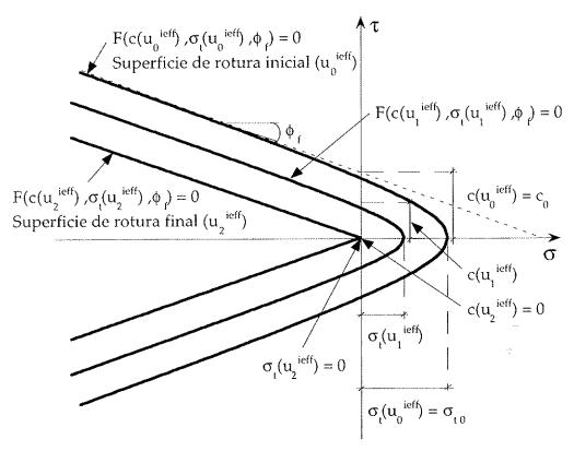
Figura 11. Superficie de rotura y su evolución.
