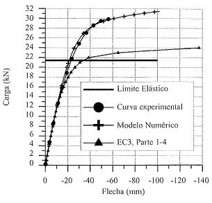
Figura 9. Curvas carga-flecha para la viga biapoyada SHS 80 x 80.
