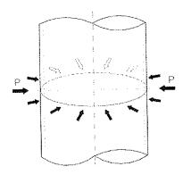
PRESION RADIAL PRODUCIDA POR UN TENDON CIRCULAR Momento flector producido por el tesado de un tendón, en disposición circular:
