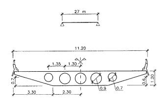
Figura 1. Tipología longitudinal y sección transversal del puente de 27 m de luz.
