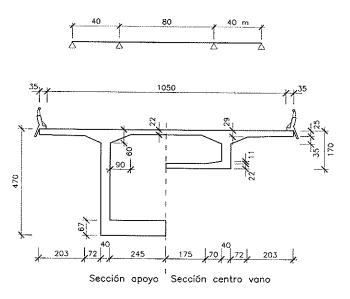
Figura 7. Tipología longitudinal y sección transversal del puente de 80 m de luz principal.
