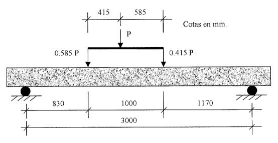
Figura 1. Disposición del ensayo.
