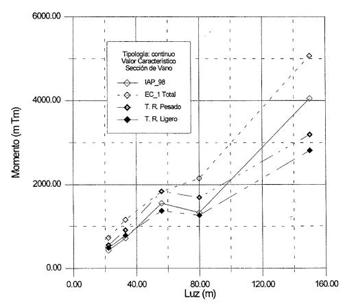
Figura 13. Valor característico de la solicitación de tráfico en función de la luz principal. Sección de vano de los puentes continuos.
