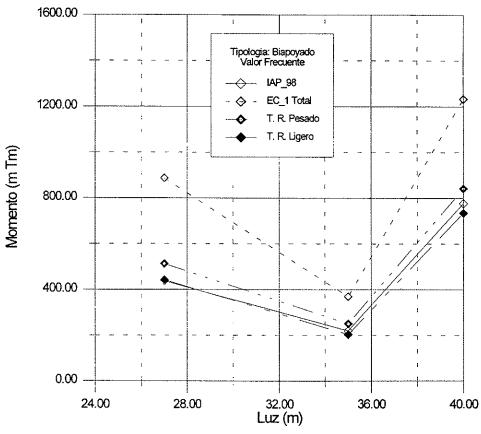
Figura 16. Valor frecuente de la solicitación de tráfico en función de la luz. Puentes biapoyados.
