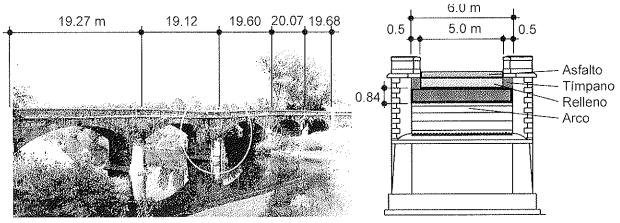
Figura 1. Vista y sección transversal del puente analizado.
