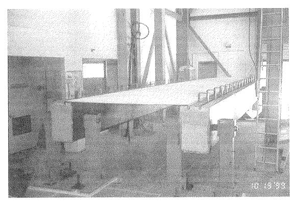
Figura 15. Construcción del ensamblaje a base de vigas híbridas.
