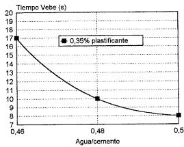
Figura 6. Consistometrías para optimización del esqueleto granular y de relación agua/cemento.
