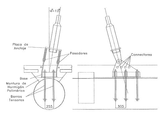
Figura 8. Detalle del anclaje del tirante.
