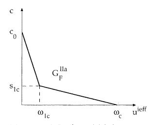
Figura 10. Funciones de ablandamiento bilineal: (a) resistencia de la intercara en la dirección normal al alambre, (b) cohesión entre el alambre y el hormigón.
