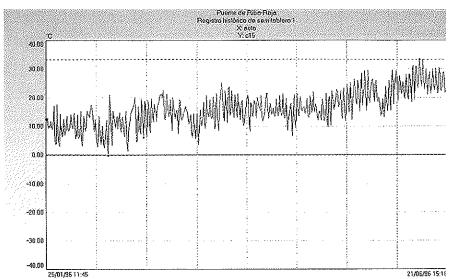
Figura 10. Temperatura ambiente y gradiente en tablero durante la construcción del voladizo de P1.
