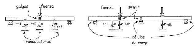
Figura 5. Esquema de instrumentación de las vigas ensayadas.
