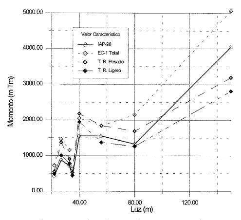
Figura 9. Valor característico de la solicitación de tráfico en función de la luz principal. Sección de vano de todos los puentes.
