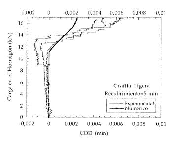
Figura 18a. Curvas experimentales y predicción numérica de la carga transferida al hormigón frente a la apertura de las grietas longitudinales, para probetas con recubrimiento de 5 mm y alambre de grafila ligera.
