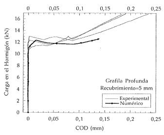
Figura 18c. Curvas experimentales y predicción numérica de la carga transferida al hormigón frente a la apertura de las grietas longitudinales, para probetas con recubrimiento de 5 mm y alambre de grafila profunda.
