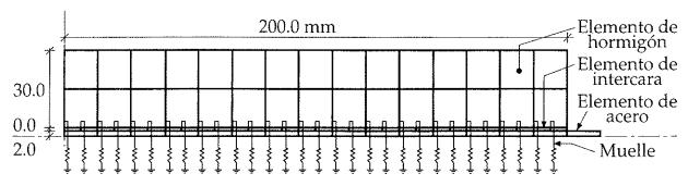
Figura 15. Malla de elementos finitos empleada en los cálculos.
