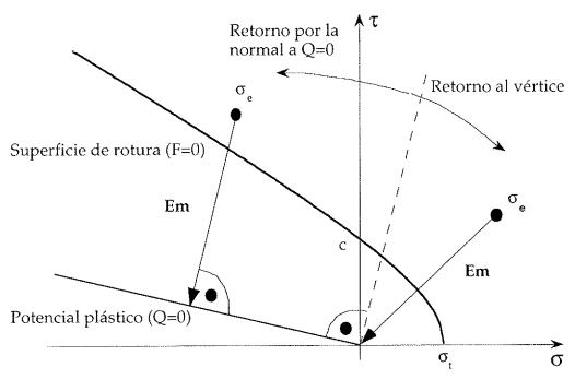
Figura 12. Dirección del corrector inelástico para retornar a la superficie de rotura.
