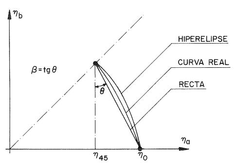
Figura 2: Excentricidad equivalente. Métodos de la recta y de la hiperelipse
