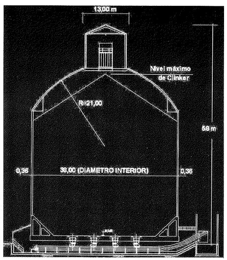
Figura 2. Sección transversal. Dimensiones fundamentales.
