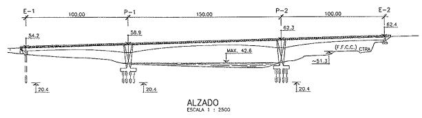
Figura 2. Alzado del puente.
