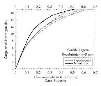
Figura 19a. Curvas experimentales y predicción numérica de la carga transferida al hormigón frente al deslizamiento del alambre en la cara superior de la probeta, para probetas con recubrimiento de 5 mm y alambre de grafila ligera.
