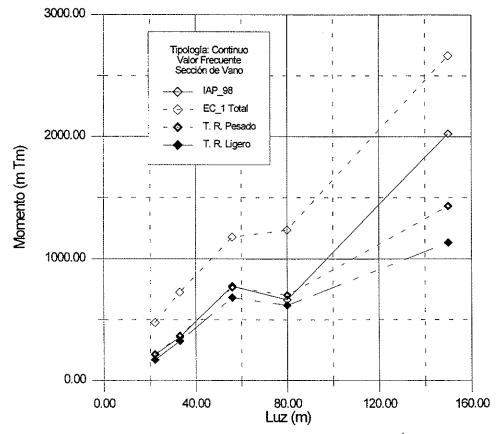
Figura 14. Valor frecuente de la solicitación de tráfico en función de la luz principal. Sección de vano de los puentes continuos.
