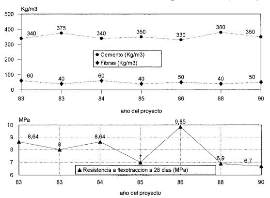
Figura 1. Dosificaciones de cemento y fibras trefiladas y de extremos conformados y tensiones de rotura por flexotracción en pavimentos para tráfico de aeronaves en aeropuertos europeos (10).
