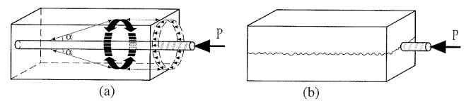
Figura 1. Agrietamiento longitudinal de una pieza de hormigón pretensado al realizar la transferencia de la fuerza de pretensado:
