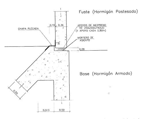
Figura 4. Detalle de apoyo del fuste del silo sobre la base. La chapa plegada constituye un faldón metálico que impide la entrada del material ensilado al espacio existente entre el fuste y la base.
