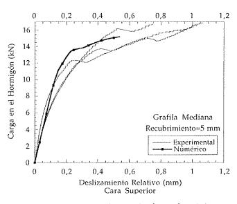
Figura 19b. Curvas experimentales y predicción numérica de la carga transferida al hormigón frente al deslizamiento del alambre en la cara superior de la probeta, para probetas con recubrimiento de 5 mm y alambre de grafila mediana.
