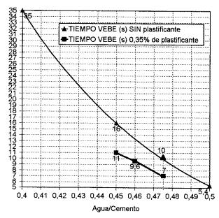
Figura 5. Consistometrías para optimización de agua/cemento.
