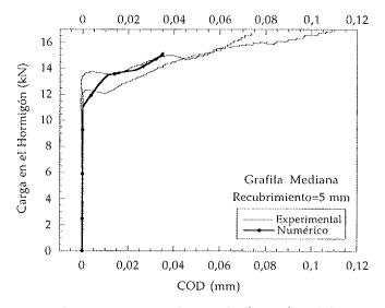
Figura 18b. Curvas experimentales y predicción numérica de la carga transferida al hormigón frente a la apertura de las grietas longitudinales, para probetas con recubrimiento de 5 mm y alambre de grafila mediana.
