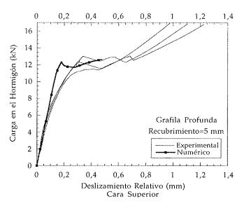
Figura 19c. Curvas experimentales y predicción numérica de la carga transferida al hormigón frente al deslizamiento del alambre en la cara superior de la probeta, para probetas con recubrimiento de 5 mm y alambre de grafila profunda.
