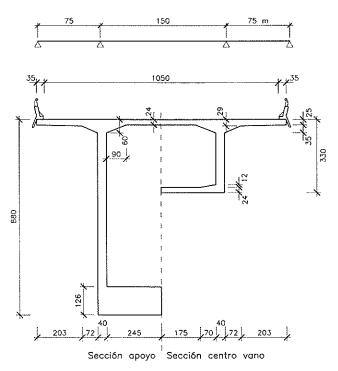
Figura 8. Tipología longitudinal y sección transversal del puente de 150 m de luz principal.
