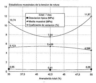
Figura 12. Variación con la relación de arena/árido total de los estadísticos muestrales de la tensión de rotura por flexotracción de hormigones con 350 Kg/m³ de cemento V/35 y 60 Kg/m³ de fibras ZC 60/.80.
