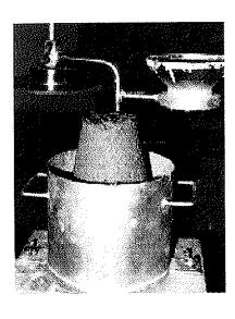
Figura 2. Consistómetro Vebe y cono de hormigón de cemento I/55A con fibras Dramix ZC 60/0.8
