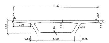
Figura 3. Tipología longitudinal y sección transversal del puente de 40 m de luz.
