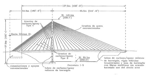
Figura 4. Alzado del puente.
