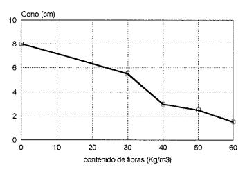
Figura 15. Variación con el contenido de fibras del asiento de cono Abrams de hormigones no optimizados.
