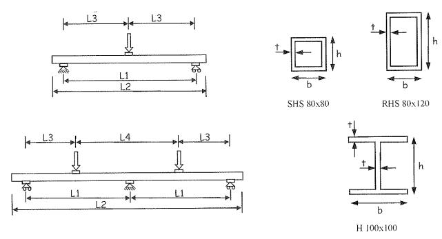
Figura 1. Secciones longitudinales y transversales de las vigas de acero inoxidable ensayadas.
