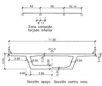
Figura 6. Tipología longitudinal y sección transversal del puente de 56 m de luz principal.
