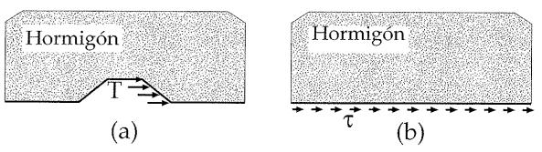
Figura 8. Homogeneización de las tensiones en la intercara del alambre grafilado y el hormigón [20]: (a) geometría real, (b) geometría idealizada.
