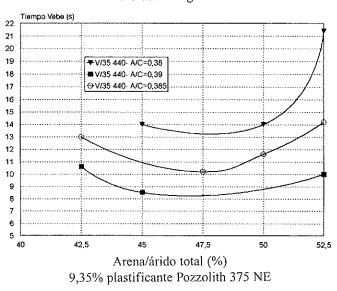
Figura 9. Consistometrías para optimización de esqueleto granular de hormigones con 440 Kg/m³ y 60 Kg/m³ de fibras.
