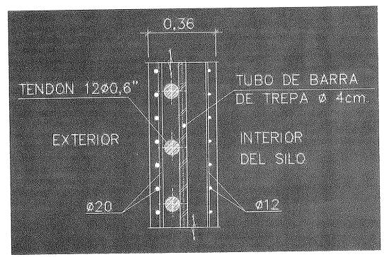
Figura 5. Pared de fuste principal. Sección.
