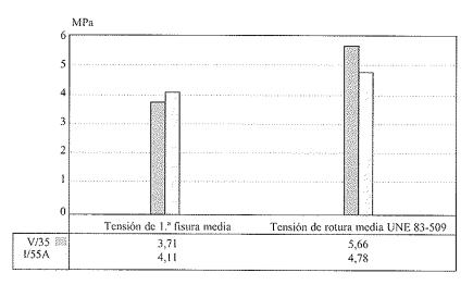
Figura 11. Comparación de tensiones de rotura de un hormigón de cemento V/35 optimizado con las de uno de I/55A de dosificación igual a la del primero.
