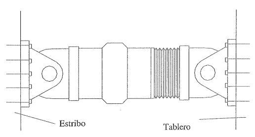
Figura 9. Amortiguador.
