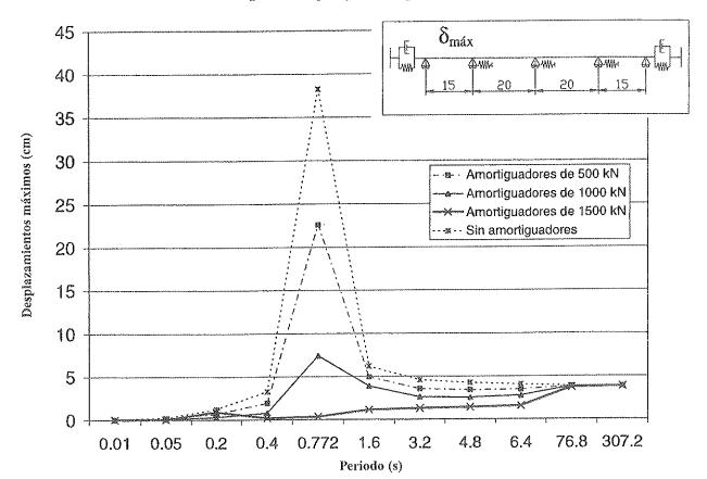
Figura 13. Puente viga: desplazamientos máximos del tablero.
