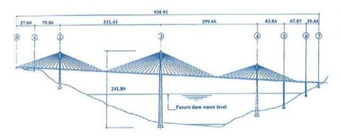
Figura 32. Alzado longitudinal del puente de Mezcala (México). Figure 32. Longitudinal layout of Mezcala bridge.
