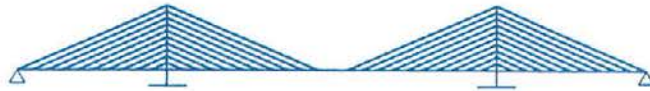
Figura 10. Modelo de tres vanos con atirantamiento en arpa. Figure 10. Three span scheme with cables in harp.
