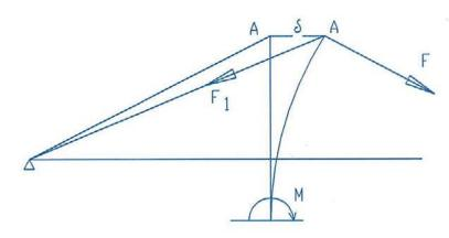
Figura 2. Movimiento de la torre de un puente de tres vanos ante las fuerzas de los tirantes. Figure 2. Tower displacement due to stayed forces in a three span cable stayed bridge.
