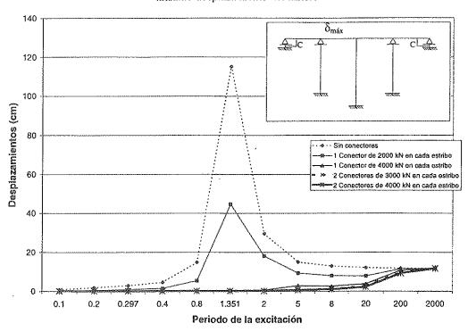
Figura 17. Máximo desplazamiento del tablero.
