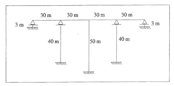
Figura 3. Puente de varios vanos sobre pilas altas.
