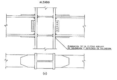
Figura 5.5. Propuestas de la AISC para el diseño y reparación de nudos rígidos en zonas sísmicas.
