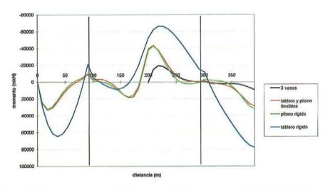
Figura 16. Diagrama de momentos flectores en el tablero para el modelo 2 de vinculación. Figure 16. Bending deck moments diagram for the connection scheme 2.
