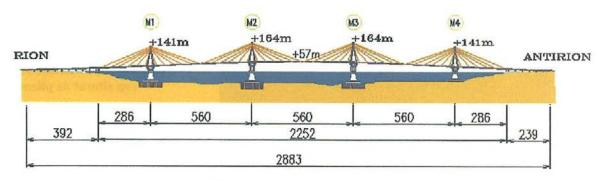
Figura 21. Alzado longitudinal del puente Rion-Antirion. Figure 21. Longitudinal layout of Rion-Antirion bridge.
