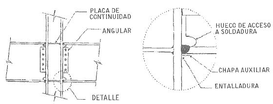
Figura 3.1: Unión típicamente empleada para nudos metálicos rígidos.
