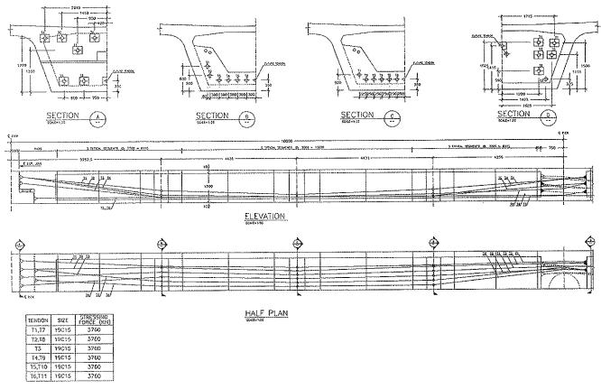
Figura 4. Pretensado longitudinal en vano tipo
