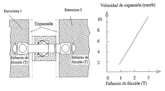
Figura 6. Conector sísmico sometido a cargas lentas.
