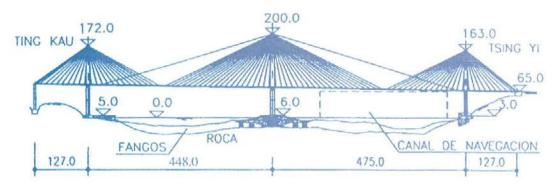
Figura 39. Alzado longitudinal del puente de Ting kau (Hong Kong). Figure 39. Longitudinal layout of Ting Kau bridge.
