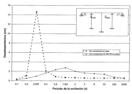
Figura 20. Desplazamiento máximo de la pila de 15 m.
