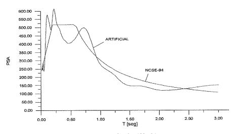
Figura 6. ERE (PSA) - NCSE-94 y espectro compatible artificial.
