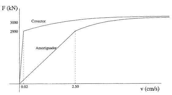
Figura 10. Ley F - v de los amortiguadores y conectores de 3000 kN de capacidad.
