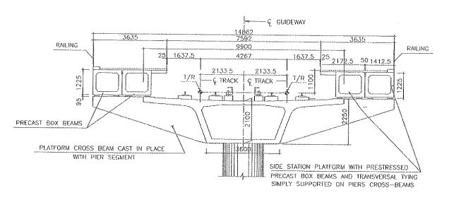
Figura 12. Sección tipo en estación con andenes laterales.
