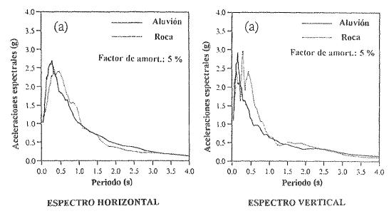
Figura 2.1: Espectros de aceleración de Northridge.
