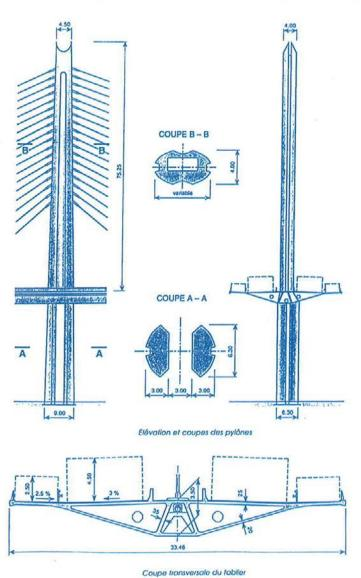
Figura 18. Pila-pilono y sección del tablero del puente sobre el Lago de Ginebra. Figure 18. Pier-pylon and deck cross section of lake Geneve bridge.
