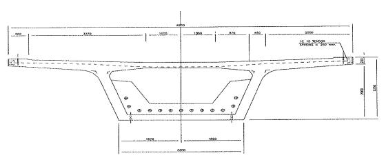
Figura 5. Sección de dovela de vía doble con desviador
