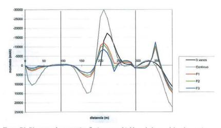
Figura 54. Diagrama de momentos flectores en el tablero de los modelos de puente continuo con dos tirantes inferiores por vano.
