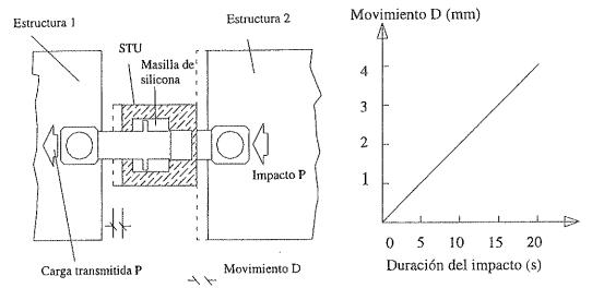
Figura 7. Conector sísmico sometido a una carga rápida.
