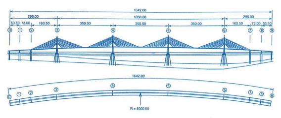
Figura 17. Alzado longitudinal del puente sobre el Lago de Ginebra. Figure 17. Longitudinal layout of lake Geneve bridge.
