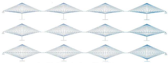
Figura 52. Modelos de puente continuo con 18 tirantes inferiores por vano. Figure 52. Structrual schemes of continuous bridges with 18 bottom stays in span.
