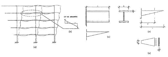
Figura 5.1. Pórtico de nudos rígidos sometido a una acción sísmica.
