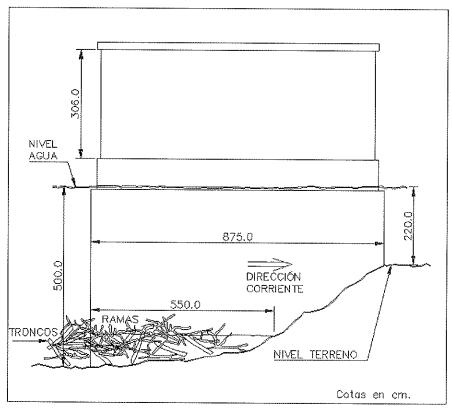
Figura 5. Croquis de la píla n.º 2 obtenido en la inspección subacuática.
