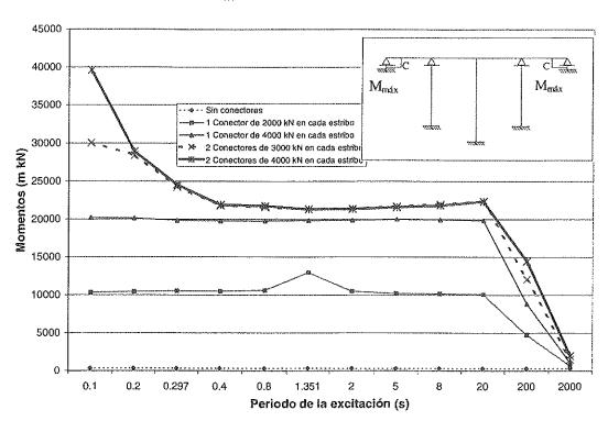
Figura 19. Momento máximo en la base de los estribos.
