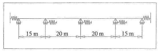
Figura 2. Puente de varios vanos con aparatos de apoyo de neopreno zunchado.
