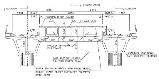
Figura 11. Sección tipo en estación con andén central.
