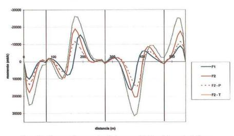
Figura 30. Diagrama de momentos flectores en el tablero del puente de 4 vanos con vanos laterales descompensados.
