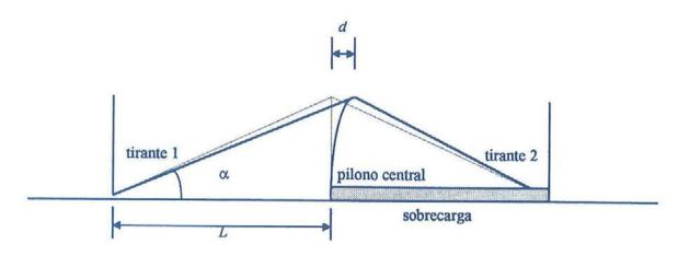
Figura 34. Funcionamiento del atirantamiento tipo 1. Figure 34. Structural response of staying type 1.
