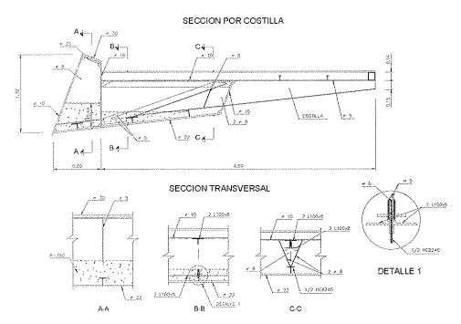
Figura 10. Sección transversal de la pasarela.
