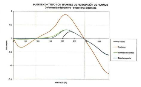
Figura 36. Diagrama de flechas verticales en el tablero con utilización de tirantes adicionales de rigidización.
