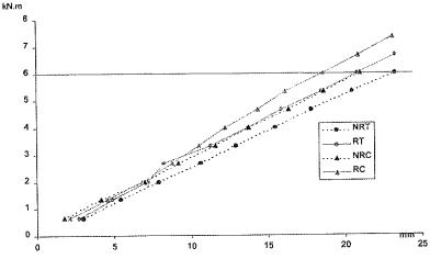
Figura 2. Momentos /flechas de vigueta para cargas instantáneas hasta el Mserv.
