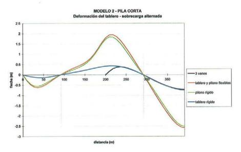
Figura 15. Diagrama de flechas verticales en el tablero para el modelo 2 de vinculación. Figure 15. Vertical deck deflections for the connection scheme 2.
