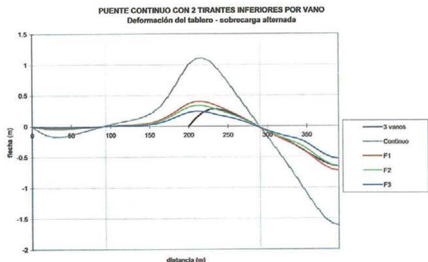
Figura 53. Diagrama de flechas verticales en el tablero de los modelos de puente continuo con dos tirantes inferiores por vano.
