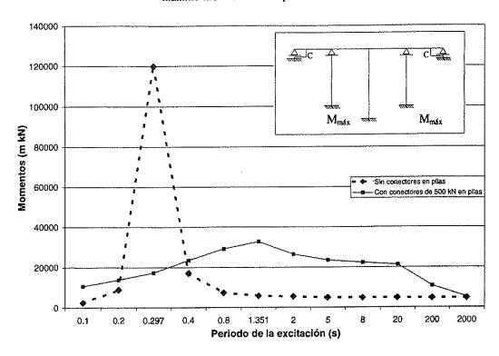
Figura 21. Momento máximo en la base de las pilas de 15 m.
