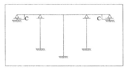
Figura 15b. Estructura con la pila central empotrada al tablero y con conectores de distintas capacidades en los estribos.
