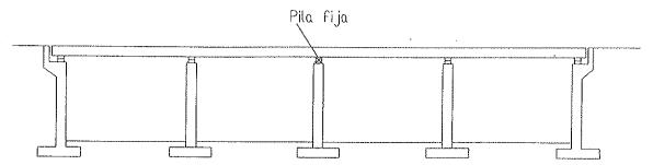
Figura 8a. Puente de varios vanos sin conectores.
