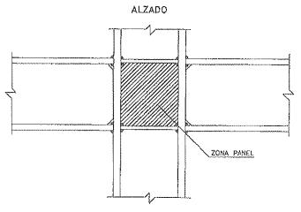
Figura 3.3: Placas de continuidad en el alma de la columna.
