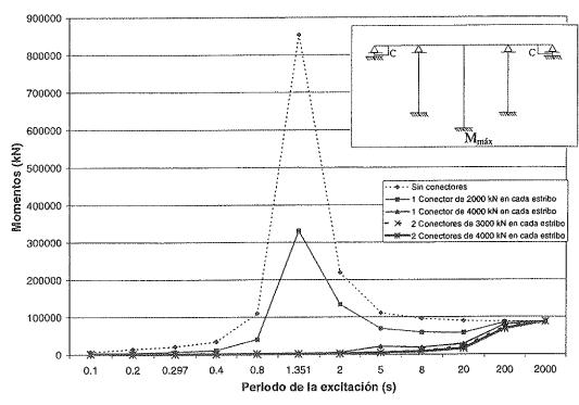
Figura 18. Momento máximo en la base de la pila central.
