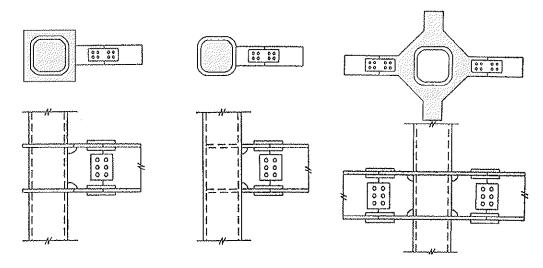
Figura 3.4: Uniones rígidas construidas en Japón.
