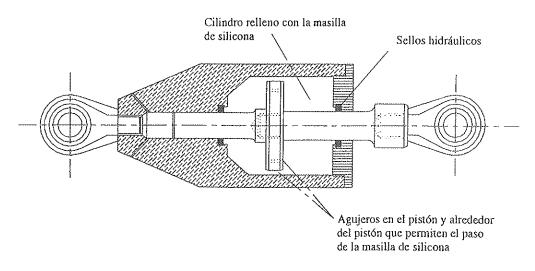
Figura 5. Conector sísmico.
