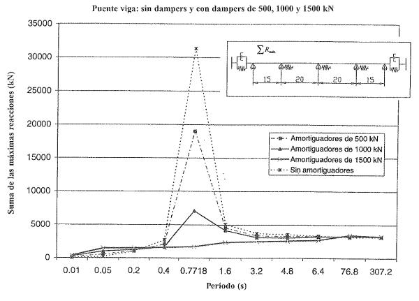
Figura 14. Puente viga: suma de las máximas reacciones.
