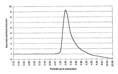
Figura 1. Amplificación de la aceleración en una estructura de un grado de libertad.
