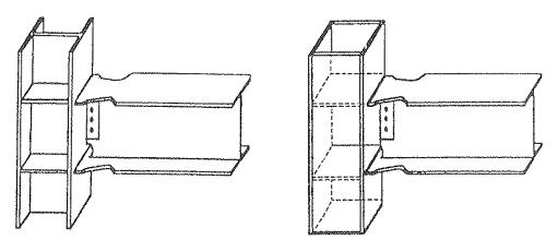
Figura 5.2. Uniones viga-columna dúctiles.
