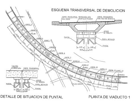
Figura 3. Esquema de demolición del viaducto 1.
