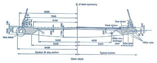
Figura 43. Sección transversal del tablero del Puente de Poole (Inglaterra).
