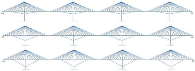
Figura 50. Modelos de puente continuo con 2 tirantes inferiores por vano. Figure 50. Structural schemes of continuous bridges with two bottom stays in span.
