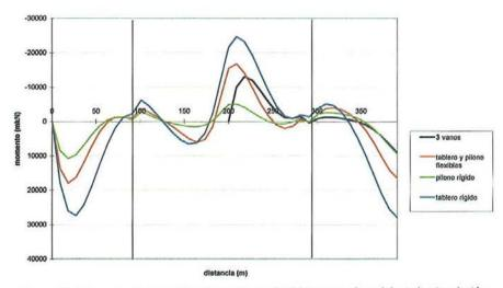
Figura 14. Diagrama de momentos flectores en el tablero para el modelo 1 de vinculación. Figure 14. Bending deck moments diagram for the connection scheme 1.
