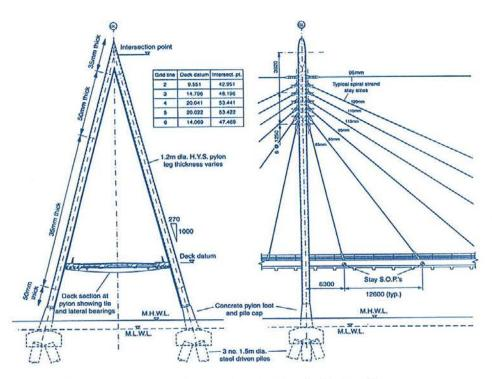
Figura 42. Detalle de la pila pilono del Puente de Poole (Inglaterra). Figure 42. Pier-pylon detail of Poole bridge.
