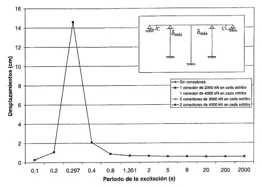
Figura 16. Máximo desplazamiento de las pilas de 15 m.
