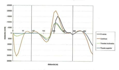
Figura 37. Diagrama de momentos flectores en el tablero con utilización de tirantes adicionales de rigidización.
