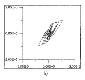
Figura 4. Ejemplo de ciclos de histéresis  $\sigma - \varepsilon$  tipos resultantes para vigas (a) y pilares b)
