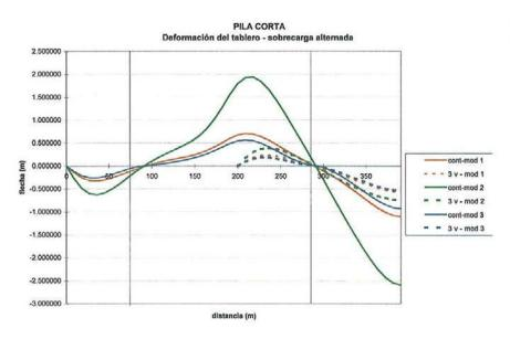
Figura 11. Diagrama de flechas verticales en el tablero para los tres modelos de vinculación. Figure 11. Vertical deck deflections for the three schemes of connection.
