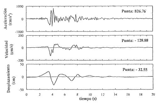
Figura 2.2: Componentes del movimiento del terreno a 15 Km del epicentro de Northridge.
