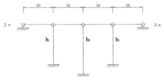
Figura 15a. Estructura base a partir de la cual se han realizado todos los subcasos del caso 2.
