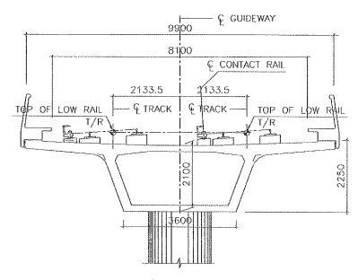
Figura 2. Sección tipo de viaducto de vía doble.
