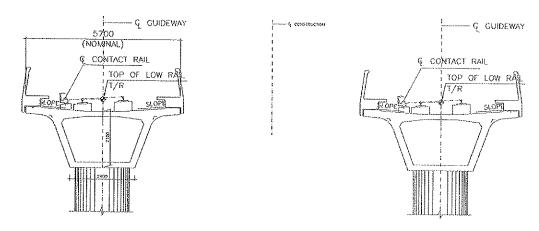
Figura 3. Sección tipo de viaductos de vía sencilla.
