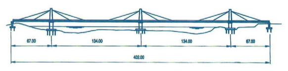
Figura 20. Alzado longitudinal del puente de Kuang Fu. Figure 20. Longitudinal layout of Kuang Fu bridge.
