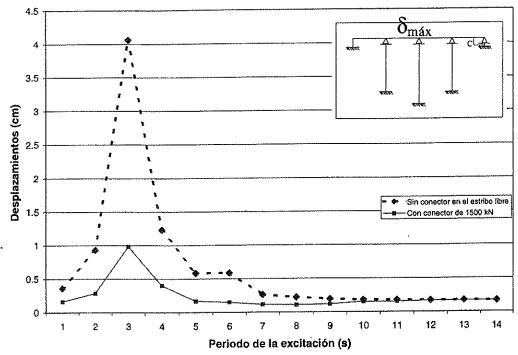
Figura 22. Desplazamiento máximo del tablero.
