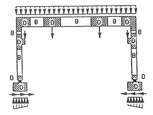
Figura 1: Regiones "B" y "D" en una estructura
