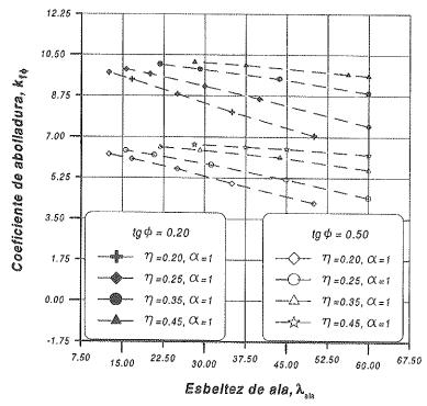
Figura 11. Valores del coeficiente de abolladura de alma en elementos de inercia variable en función de la esbeltez y ancho de ala para diferentes pendientes del ala inferior ( $tq\phi = 0.20, 0.50$ )
