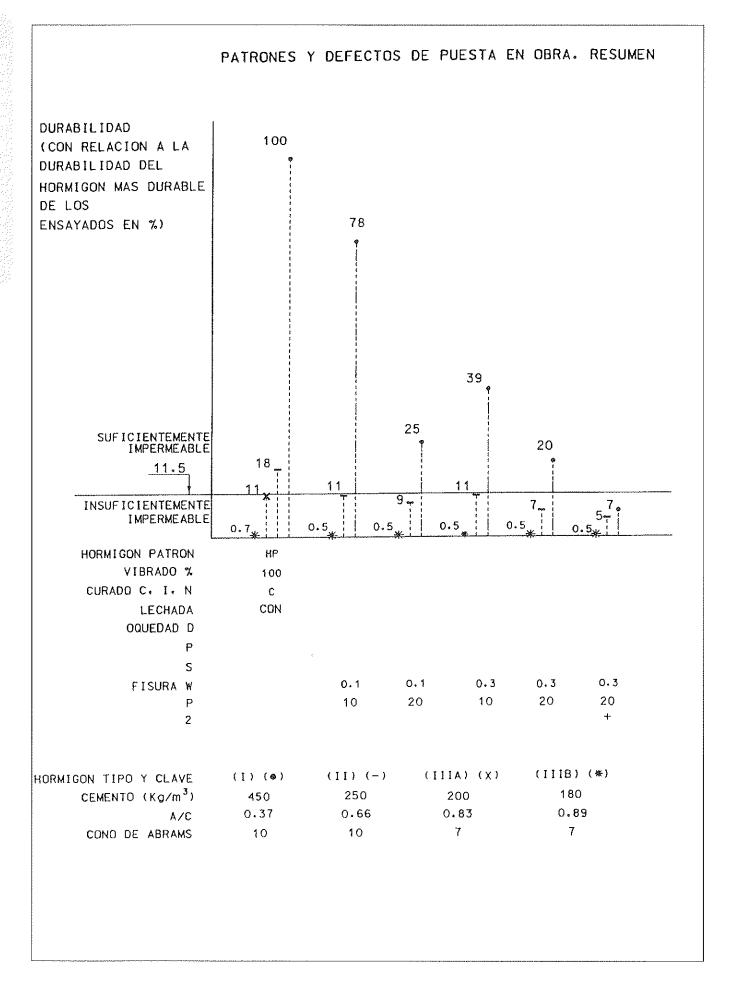
Figura 3 = Figura Resumen 3 de resultados de los ensayos de penetración de agua, bajo presión en términos de Durabilidad.
