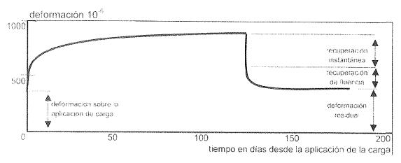
Figura 3. Comportamiento de deformación del hormigón bajo carga constante y en la descarga.
