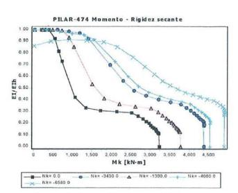
Figura 18. Diagrama momento curvatura de uno de los pilares. Figure 18. Diagram moment curvature of one colum.
