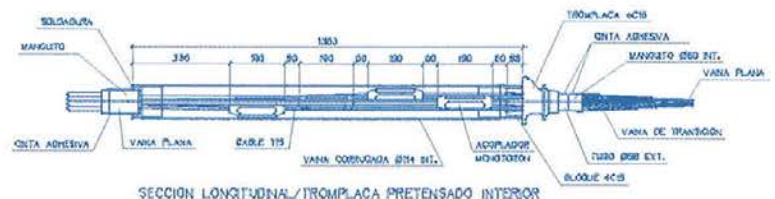
Figura 11. Detalles acoplador mono torón. Figure 11. Details of a coupler for one tendon.
