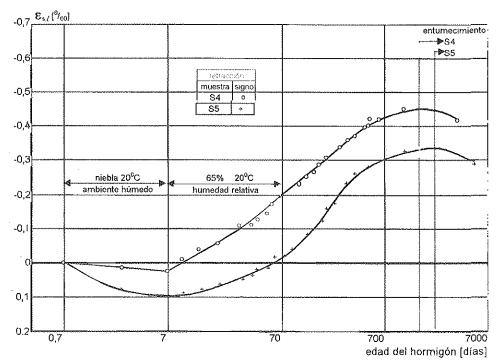
Figura 7. Entumecimiento y retracción del LWAC de alta resistencia. Entumecimiento después de un período de 5-10 años (Hoffmann, 1938b).
