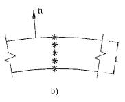
Figura 3. Elemento finito tipo lámina utilizado. a) Nodos y puntos de integración en la superficie. b) Puntos de integración a través del espesor.
