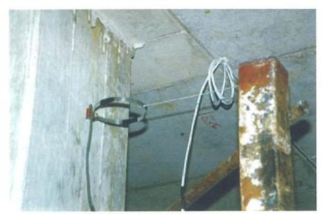
Figura 25. Sonda de temperatura en forjado. Figure 25. Measuring of temperatures into the slab.
