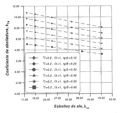
Figura 12. Valor del coeficiente de abolladura del alma en elementos de inercia variable, en función de la esbeltez del ala para diferentes pendiente del ala inferior tgø
