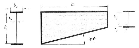
Figura 8. Parámetros geométricos de vigas de inercia variable.
