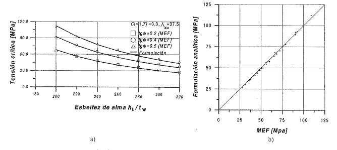
Figuraz 15. Tensión crítica de abolladura de alma de elementos metálicos de inercia variable.
