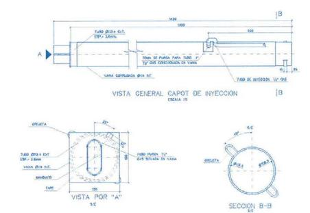
Figura 16. Vista general capot de inyección. Figure 16. Pipe connected to the case.
