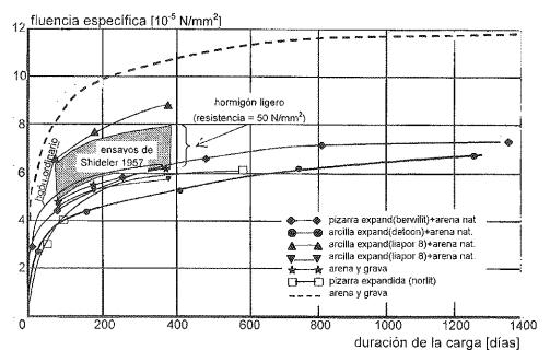
Figura 5. Curvas de fluencia para el LWAC y para el NDC (CEB/FIP, 1977).
