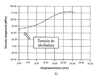
Figura 2. Abolladura del panel de alma de vigas de inercia variable.
