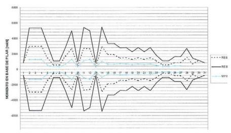
Figura 22. Gráfico comparativo momento solicitante y momento admisible de cimentación Figure 22. Comparación between resistance and actions in foundation.
