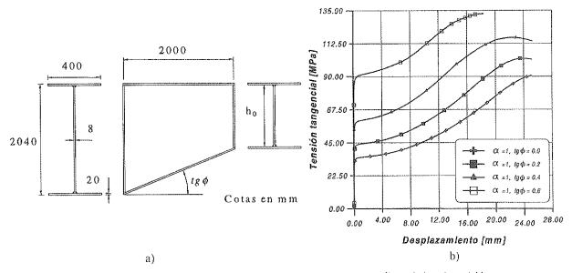
Figura 6. Comportamiento estructural del alma de vigas armadas metálicas de inercia variable.
