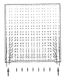
Figura 2: Flujo tensional y distribución de tensiones
