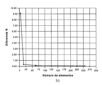
Figura 4. Densidad de malla. a) Mallas consideradas. b) Variación de la diferencia de resultados entre el código Abagus y la teoría clásica.
