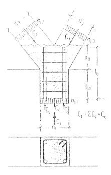
Figura 6: Biela de hormigón con armadura comprimida
