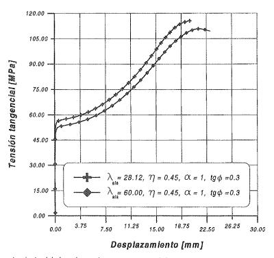
Figura 10. Comportamiento del alma de un elemento estructural de inercia variable sometido a tensiones tangenciales.
