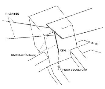
Fig. 6. Esquema estructural del modelo de cálculo.
