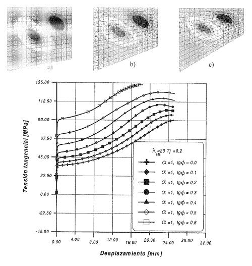
Figura 14. Comportamiento de abolladura de paneles esbeltos de alma de elementos de inercia variable. a)  $tg\phi=0.2$ , b)  $tg\phi=0.4$  y c)  $tg\phi=0.6$
