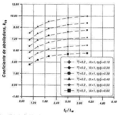
Figura 13. Variación del coeficiente de abolladura de alma en elementos de inercia variable, en función de la relación de espesores  $t_{\rm f}/t_{\rm inv}$  para diferentes pendientes del ala inferior  $tg\phi$ .
