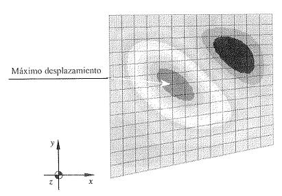
Figura 9. Deformada cualitativa del panel de alma de un elemento de inercia variable, cuando el alma ha abollado.
