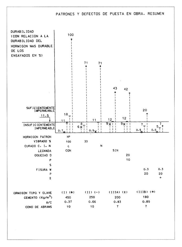
Figura 4 = Figura Resumen 4 de resultados de los ensayos de penetración de agua, bajo presión en términos de Durabilidad.
