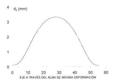
Figura 12. Deformaciones fuera del plano inicial del alma constatadas en el modelo numérico y producidas por la abolladura.
