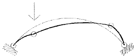
Figura 6 a. Mecanismo de flexión de un arco.
