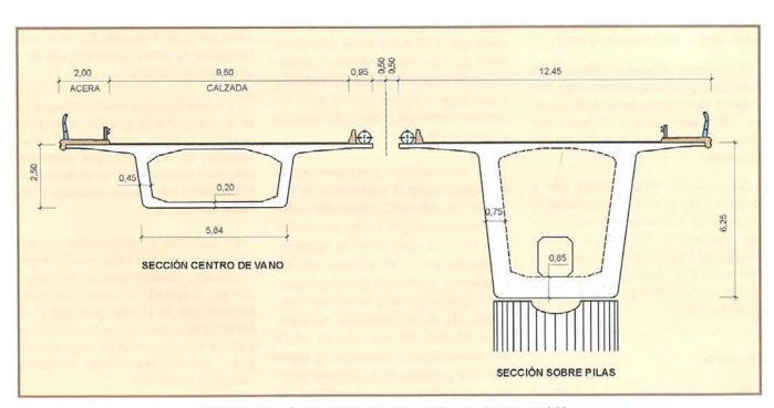
Gráfico 2. Sección transversal del tablero en la zona de canto variable. Graph 2. Cross-section of the variable depth deck.
