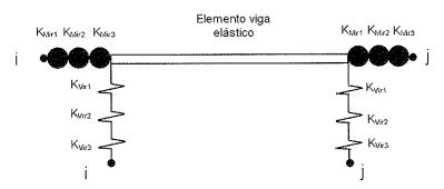
Figura 3. Elemento disipador de cortante.
