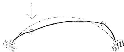
Figura 6 a. Mecanismo de flexión de un arco.
