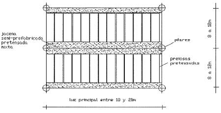
Figura 1: Módulo tipo mediante este sistema en paños libres entre 10-20m y 8-12m.
