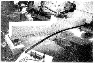
Figura 8. Despegue de la lámina de CFRP.
