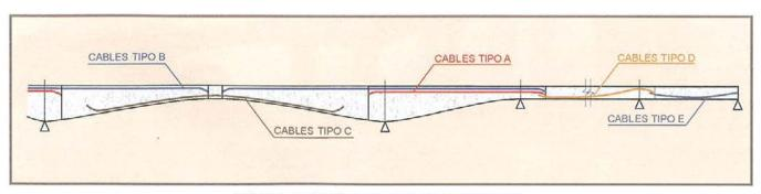
Gráfico 4. Familias de cables de pretensado del tablero. Graph 4. Prestressing cables types of the deck.
