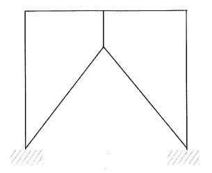
Figura 2. Pórtico arriostrado con elemento disipador vertical.
