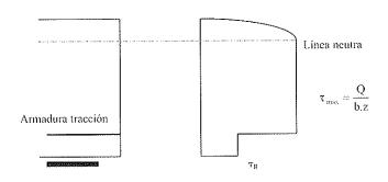
Figura 3: Análisis del esfuerzo rasante.
