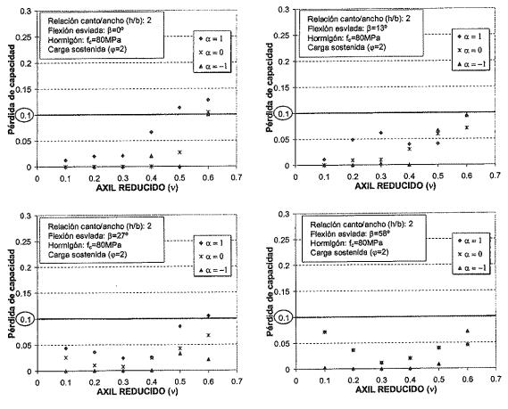
Figura 12. Comparación de la esbeltez límite inferior propuesta en flexión esviada con los resultados de la simulación numérica.
