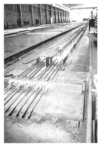
Fotografía 2. Línea de fabricación después de hormigonar extremo pretensado. Fábrica ATEFOR.
