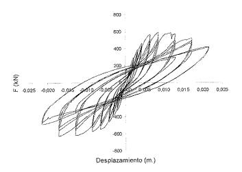
Figura 7. Comportamiento histerético del pórtico reacondicionado.
