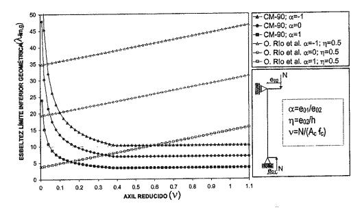
Figura 2. Comparación de la esbeltez límite para cuantía de armadura fija (CM-90[6]) y para quantía de armadura variable (Río et al (1987) [13, 14, 15]).
