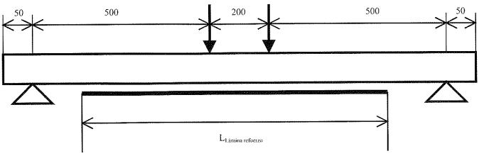
Figura 7: Esquema de carga de las vigas.
