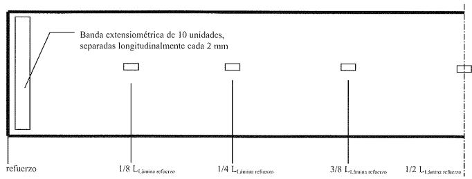
Figura 6: Distribución de la extensometría colocada en la lámina de refuerzo.
