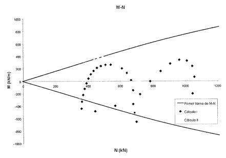
Figura 11. Representación de los pares (*N*,M) correspondientes a distintas secciones del puente, obtenidos mediante cálculo lineal (I) y cálculo no lineal (II), en comparación con el diagrama de interacción. Los puntos situados sobre el diagrama corresponden a las cuatro rótulas formadas.
