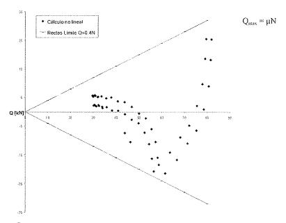
Figura 12 Representación de los pares (Q,N) correspondientes a distintas secciones del puente, obtenidos mediante cálculo nolineal. Las rectas representan la condición de fallo por deslizamiento al superar el valor límite del rozamiento ( $\mu = 0,4$ ).
