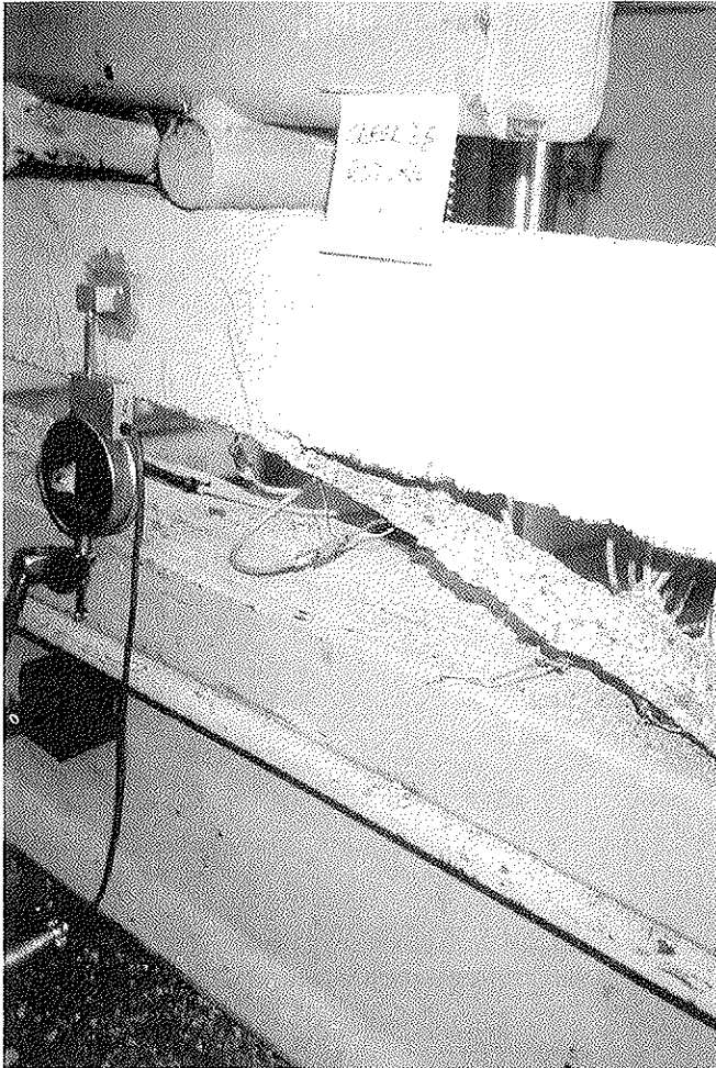
Fotografía 6: Viga probeta en la prensa de ensayos.
