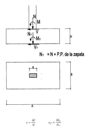
y donde  $V_T$  puede despreciarse si consideramos que V es absorbida por la acción pasiva del terreno en el caso de zapatas cúbicas, hormigonadas –confinadas— en el terreno de la excavación cuando su profundidas con la del hormigón pobre
