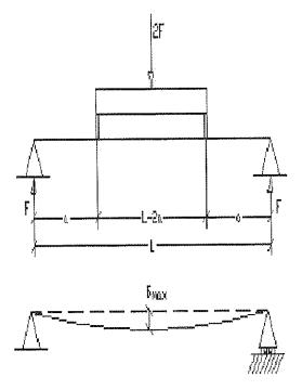
Figura 2. Esquema general de cargas.
