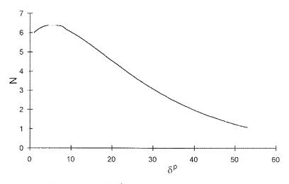
Figura 1. Potencial plástico para el elemento diagonal equivalente.
