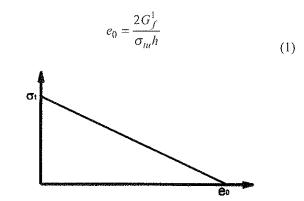
Figura 9. Curva tensión -deformación de fractura, que define el comportamiento del material en una dirección tras el agrietamiento.
