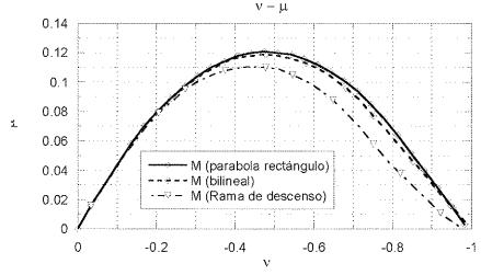
Figura 8 b) Diagramas de interacción adimensionales de una sección rectangular b x h de la fábrica.
