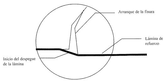
Figura 10: Detalle inicio delaminación.
