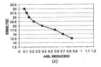
Relación canto/ancho (h/b): 1 Flexión recta:  $\beta$ =0° Hormigón:  $f_c$ =30MPa Carga instantánea ( $\phi$ =0) Relación de excentricidades ( $\alpha$ ): 1
