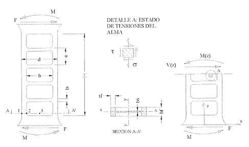
Figura 10. Parámetros del modelo de predicción.
