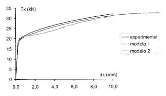
Figura 11. Curva fuerza-desplazamiento, en sus respuestas numérica y experimental: i) modelo 1, adoptando la curva tensión-deformación real del ensayo a tracción como ecuación constitutiva, ii) modelo 2, considerando la reducción de la fluencia del material mecanizado.
