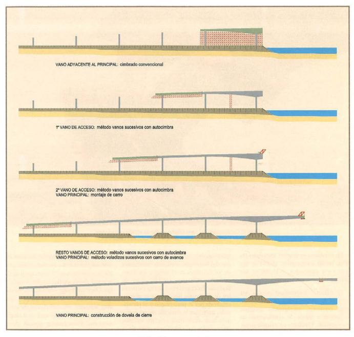
Gráfico 6. Proceso constructivo. Graph 6. Constructive process.
