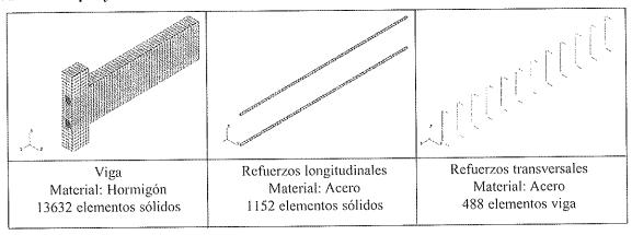
Tabla 8. Grupos y elementos utilizados en el modelo numérico del nudo de hormigón armado reparado
