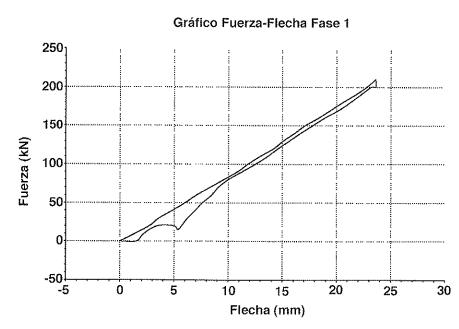
Figura 4: (a) Resultado experimental en la fase 1 del ensayo.
