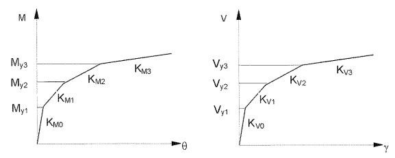
Figura 4. a) Comportamiento de la sección extrema en flexión. b) Comportamiento de la sección extrema en corte.
