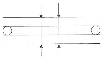
Figura 5: Esquema del sistema de aplicación de la carga de servicio a las vigas.
