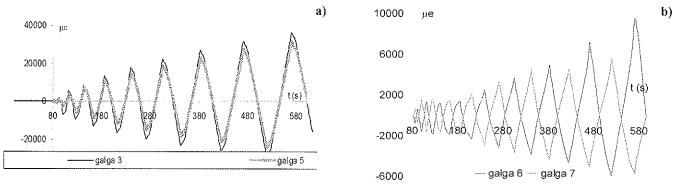
Figura 7. a) Evolución temporal de las medidas en dos de las galgas situadas en el alma de D1, b) evolución temporal de las medidas en las galgas situadas en las alas de D1.
