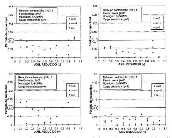
Figura 11. Comparación de la esbeltez límite inferior propuesta en flexión recta con los resultados de la simulación numérica.
