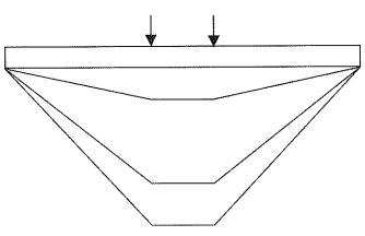
Figura 2: Diagrama de momentos en vigas-probeta.
