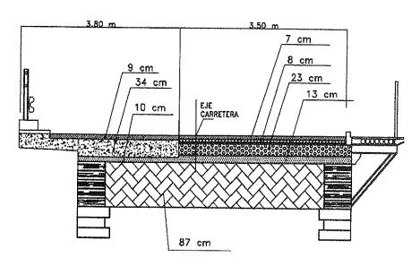
Figura 1. Sección transversal. Situación existente.
