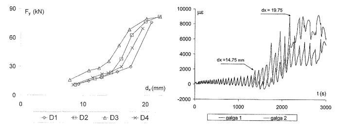
Figura 8. a) Relación entre la fuerza vertical máxima y el desplazamiento en ciclos sucesivos, b) evolución de las medidas de las galgas extensométricas situadas en las alas del dispositivo D2.
