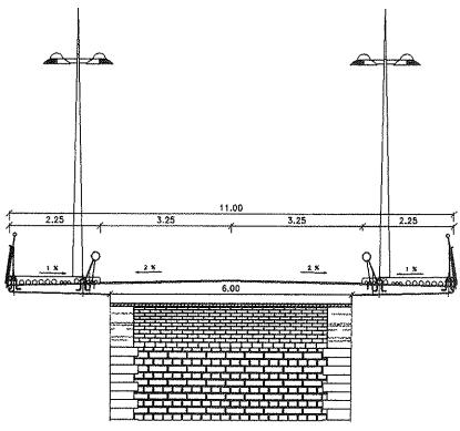
Figura 2. Alzado y Sección Transversal. Solución propuesta.
