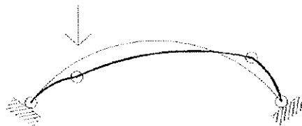
Figura 6 a. Mecanismo de flexión de un arco.
