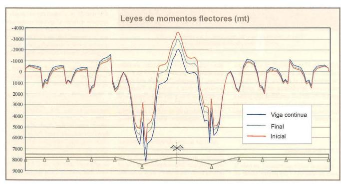
Gráfico 5. Ley de momentos flectores en el tablero originada por el peso propio y el pretensado. Graph 5. Bending deck moments for deade weight and prestressing.
