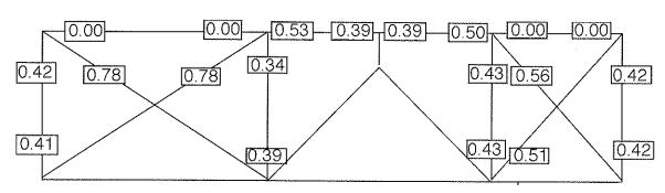
Figura 13. Distribución final del daño en el piso reacondicionado.
