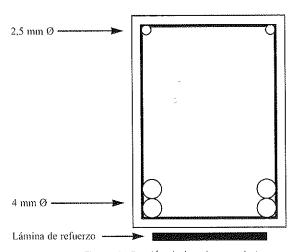
Figura 1: Sección de las vigas-probeta.
