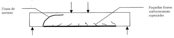
Figura 8: Rotura por cortante.
