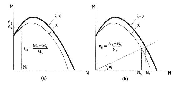
Figura 1. Definición del criterio de error. (a) Criterio de comparación con axil constante (b) Criterio de comparación con excentricidad constante.
