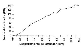
Figura 13. Curva fuerza-desplazamiento del actuador.
