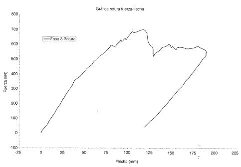
Figura 7. Resultado experimental fase 3, rotura.
