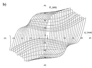
Figura 5. Curvas experimentales fuerza - desplazamiento: a) del disipador D1, b) del disipador D3.
