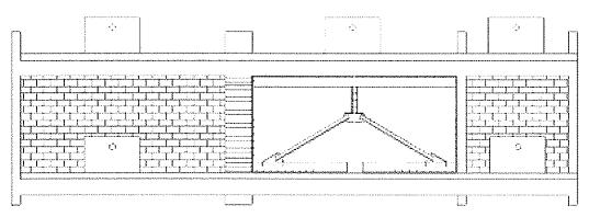
Figura 5. Esquema de reacondicionamiento con disipador vertical.
