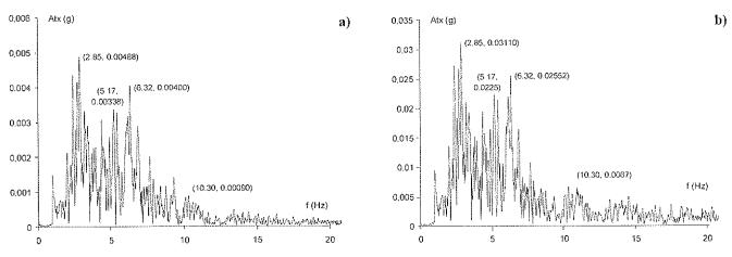
Figura 6. Transformadas de Fourier correspondientes a los registros de aceleración de la mesa vibrante, para distintas escalas de la excitación: a) FE = 0.353, b) FE = 2.238.
