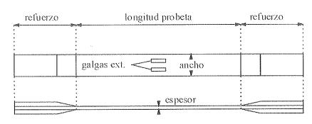
Figura 2. Dimensiones y colocación de galgas extensométricas.
