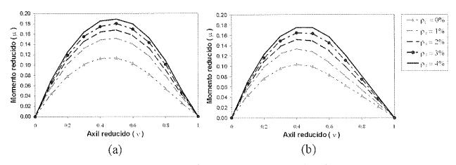
Figura 6: Diagramas de interacción base para diferentes grados de confinamiento: (a) Hormigón de 25MPa (b) Hormigón de 80 MPa
