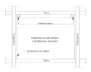
Figura 2. Sistema dual no estándar propuesto a partir del disipador por esfuerzo cortante.
