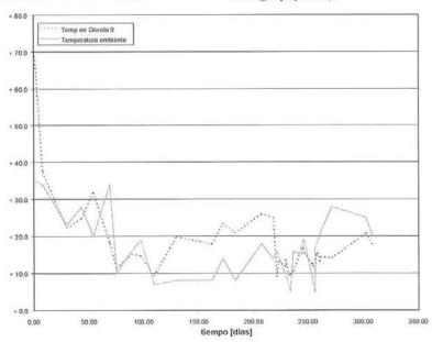
Figura 9. Evolución de la temperatura ambiente y de la temperatura interior de la dovela 9. Figure 9. Evolution of outside temperature and temperature incide segment 9.
