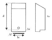
Figura 9. Diagrama de esfuerzo rasante.
