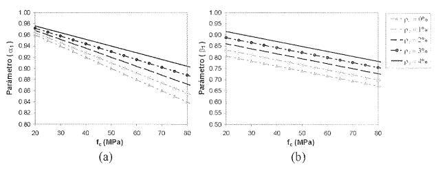
Figura 10: Parámetros del bloque rectangular propuestos para distintos grados de confinamiento: (a) Parámetro  $\alpha_1$  (b)Parámetro  $\beta_1$
