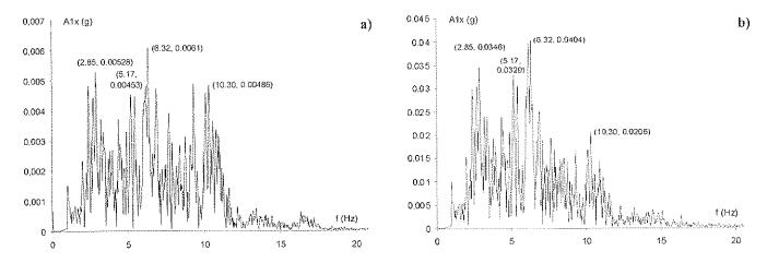
Figura 7. Transformadas de Fourier correspondientes a la aceleración en la parte superior de la estructura, para distintas escalas de la excitación: a) FE = 0.353, b) FE = 2.238.
