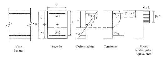
Figura 1: Bioque rectangular equivalente de compresiones en el hormigón.
