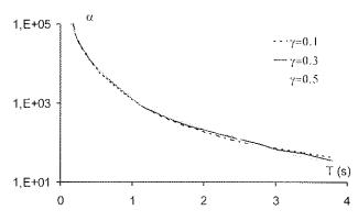
Figura 19. Espectro de aceleración normalizado.
