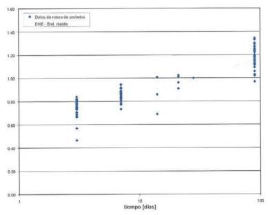
Figura 4. Evolución de la resistencia a compresión con el tiempo. Figure 4. Evolution of compressive strength with time.
