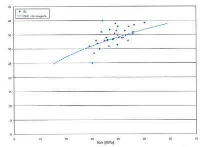
Figura 5. Relación entre módulo tangente y resistencia del hormigón.
