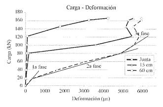
Figura 19. Gráfica carga - deformación viga reforzada con TFC.
