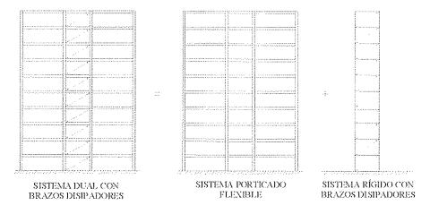
Figura 1. Sistema dual avanzado con disipadores de energía.
