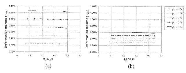
Figura 9: Deformación máxima del hormigón  $\mathcal{E}_{co}$ . (a) Hormigón de 25MPa (b) Hormigón de 80 MPa
