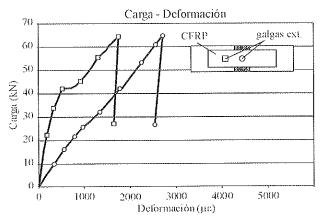
Figura 15. Gráfica carga - deformación probeta reforzada con TFC.
