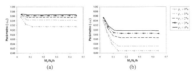
Figura 7: Parámetro  $\alpha_1$  para diferentes grados de confinamiento. (a) Hormigón de 25MPa (b) Hormigón de 80 MPa
