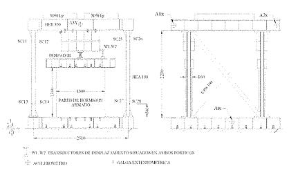
Figura 3. Sistema ensayado: configuración e instrumentación.
