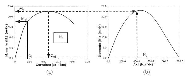
Figura 5: (a) Diagrama momento-curvatura ( $M_c$ -c), (b) Diagrama de interacción base ( $N_c$ ,  $M_c$ ).
