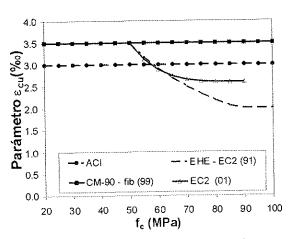
Figura 3: Relación entre la deformación última  $\varepsilon_{cu}$  y la resistencia del hormigón.
