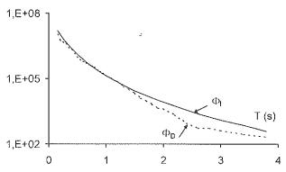
Figura 20. Comparación entre la energía introducida y disipada para distintas relaciones de rigidez del sistema: a) g = 0.1, b) g = 0.5.
