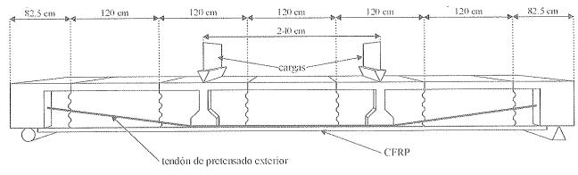
Figura 5. Dimensiones y método de carga en los ensayos de las vigas de dovelas.
