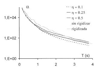
Figura 15. Espectro de aceleración normalizado.
