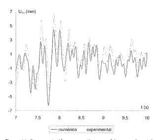
Figura 11. Representación comparativa, numérico-experimental, del desplazamiento relativo (FE = 2.238).
