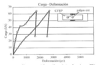
Figura 16. Gráfica carga - deformación probeta reforzada con CFK.
