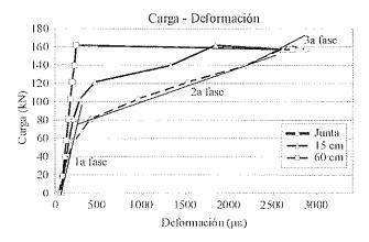
Figura 20. Gráfica carga - deformación viga reforzada con CFK.
