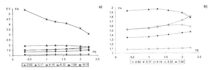
Figura 8. Relación entre el Factor de Amplificación, asociado a una frecuencia, y el Factor de Escala aplicado a la excitación: a) incluida la frecuencia natural del sistema lineal y elástico, b) excluida la frecuencia natural del sistema lineal y elástico.
