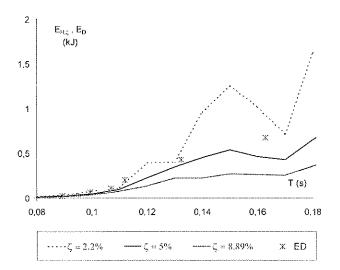
Figura 9. Espectros de energía basados en el pseudoespectro de velocidades, para valores distintos del amortiguamiento estructural, y valores experimentales de energía disipada correspondientes a los ensayos y asociados a los periodos fundamentales efectivos del sistema.
