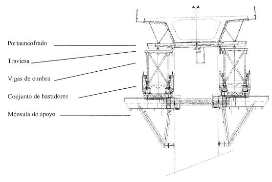
Dibujo nº 2. Sección por pila.
