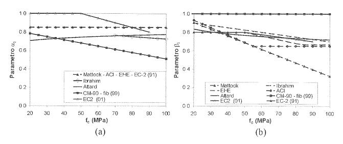
Figura 2: Parámetros correspondientes al bloque rectangular equivalente.
