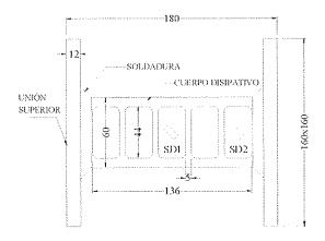
Figura 4. Instrumentación del disipador con galgas extensométricas.
