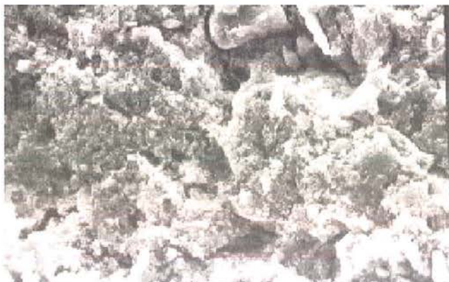
Micrografía SEM 1. Hormigón C 70 calentado a 600°C, degradación de la pasta y aumento de la porosidad, aspecto menos denso. 2000 aumentos.
