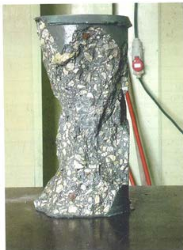
Figura 3.4.2 Probeta cilíndrica 16 x 32 cm después del ensayo a compresión.
