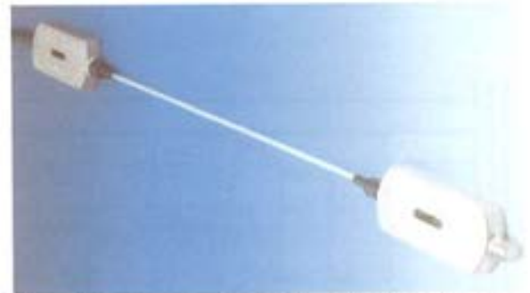
Figura 5.7.3. Extensómetros de fibra óptica de amplia base.
