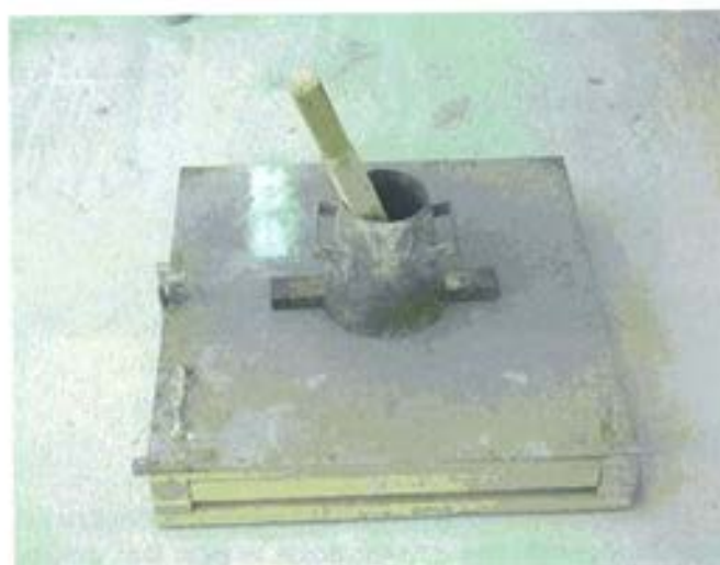
Figura 3.1.1. Tabla DIN y molde troncocónico para la realización del ensayo.
