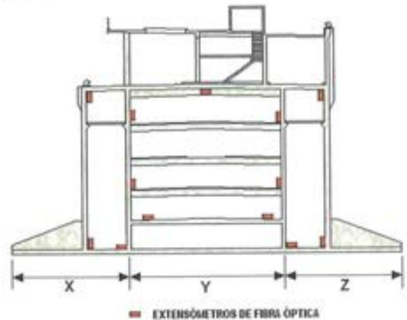
Figura 5.7.2. Sección transversal del dique, indicando la ubicación típica de los extensómetros de fibra óptica en cada sección instrumentada.
