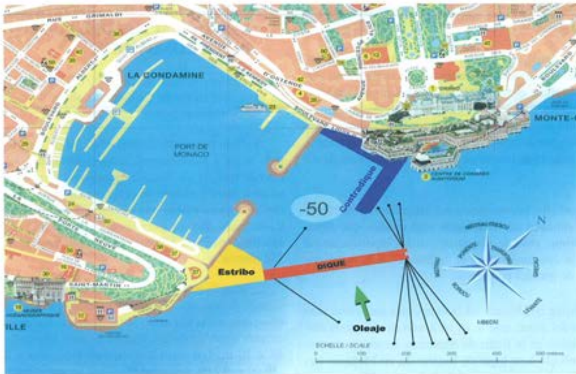
Figura 1.6. Planta del puerto ampliado.
