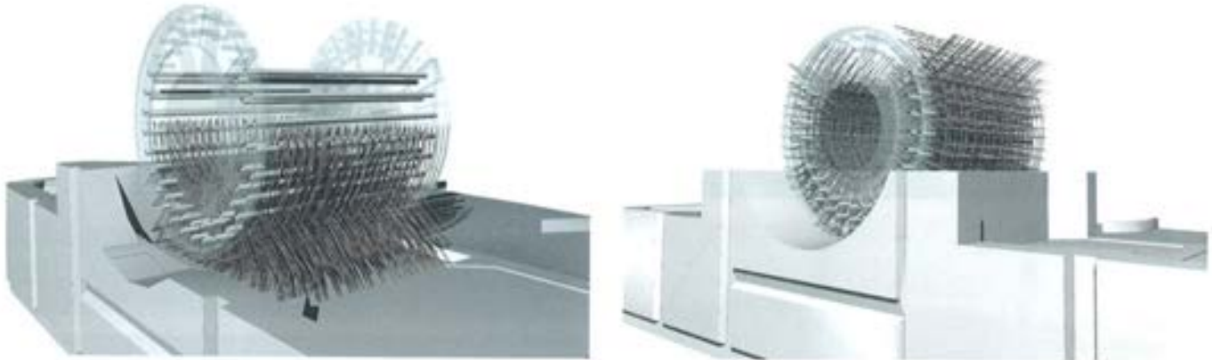
Figura 6.4.5. Fases de hormigonado de la rótula.
