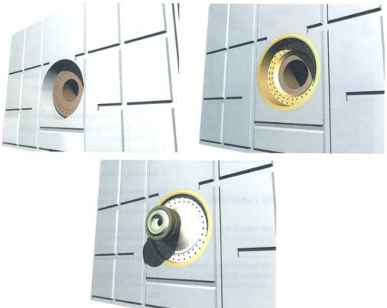
Figura 6.4.6. Fases de montaje de la rótula.
