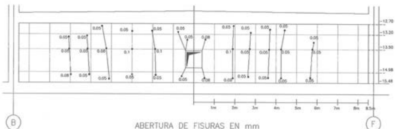
Figura 5.6.2. Fisuras obtenidas en un muro transversal con abertura de paso.
