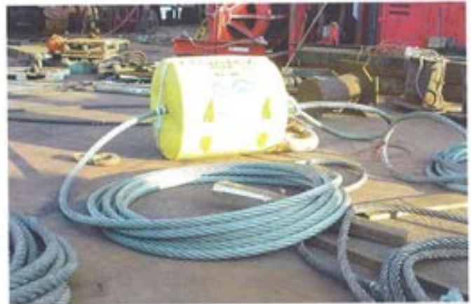
Figura 5.2.13. Detalle de la boya principal para recuperación de las cadenas desde el fondo.
