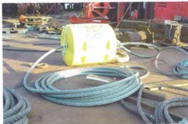
Figura 5.2.13. Detalle de la boya principal para recuperación de las cadenas desde el fondo.
