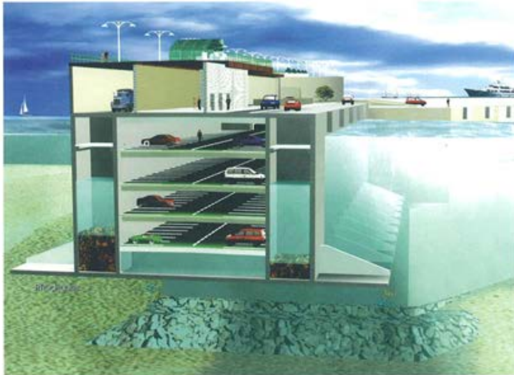
Figura 1.8. Sección transversal en zona de aparcamientos.
