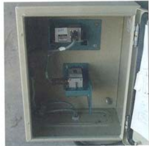
Figura 5.7.6. Servoclinómetro Jewell LSOC (Izquierda) y armario con los dos clinómetros instalados en la sección C (derecha).
