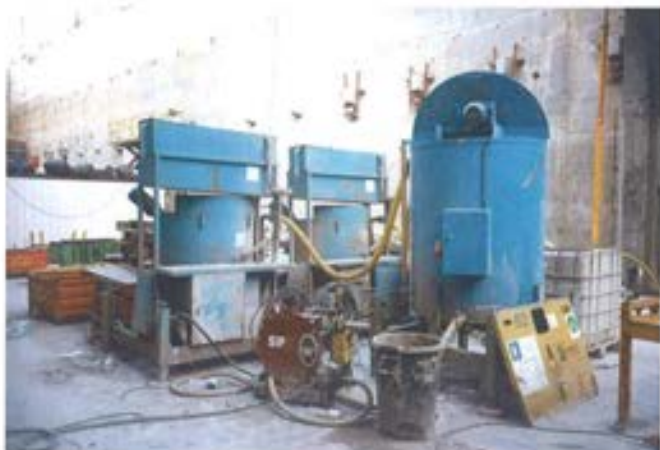
Figura 4.10. Equipo de inyección.
