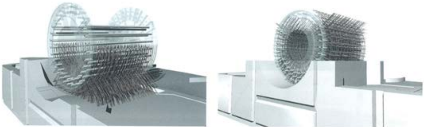
Figura 6.4.5. Fases de hormigonado de la rótula.
