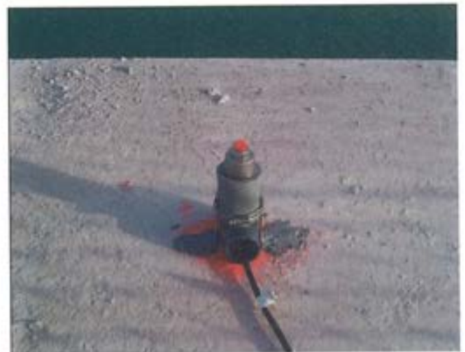
Figura 5.7.8. Sensores de presión hidrodinámica dispuestos en cubierta.
