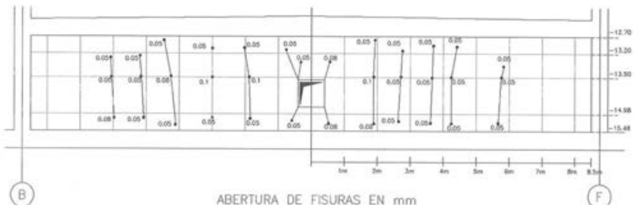
Figura 5.6.2. Fisuras obtenidas en un muro transversal con abertura de paso.
