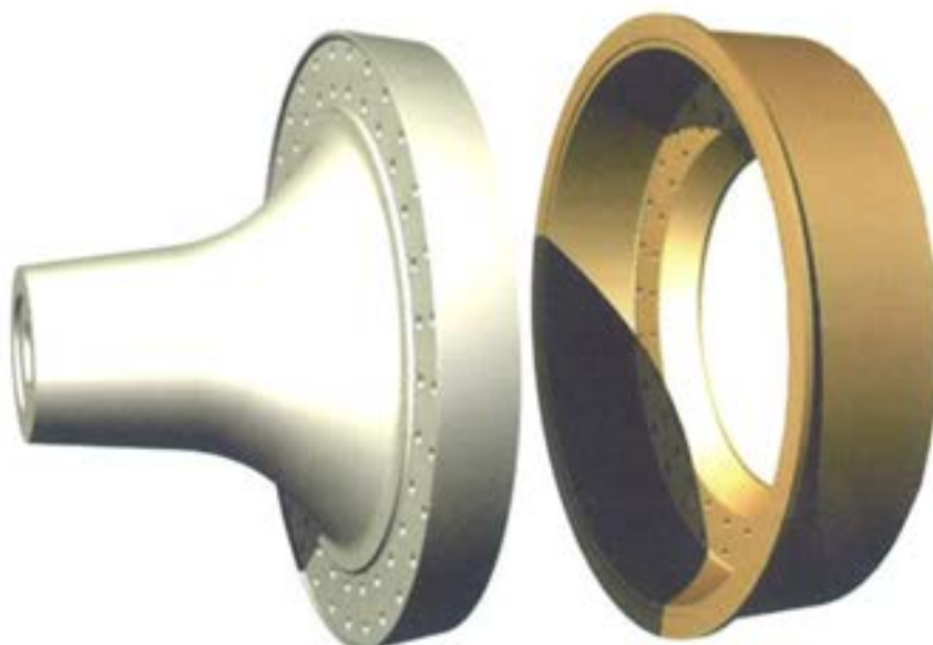
Figura 5.1.7. Perspectiva de la brida.
