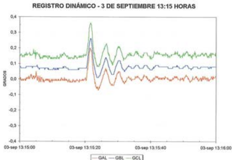
Figura 5.7.15 b). Giros longitudinales durante las operaciones de conexión de la rótula (3/09/02). Detalle del registro dinámico de los giros correspondientes al período de 10 minutos entre las 13.07 y las 13.17 horas.
