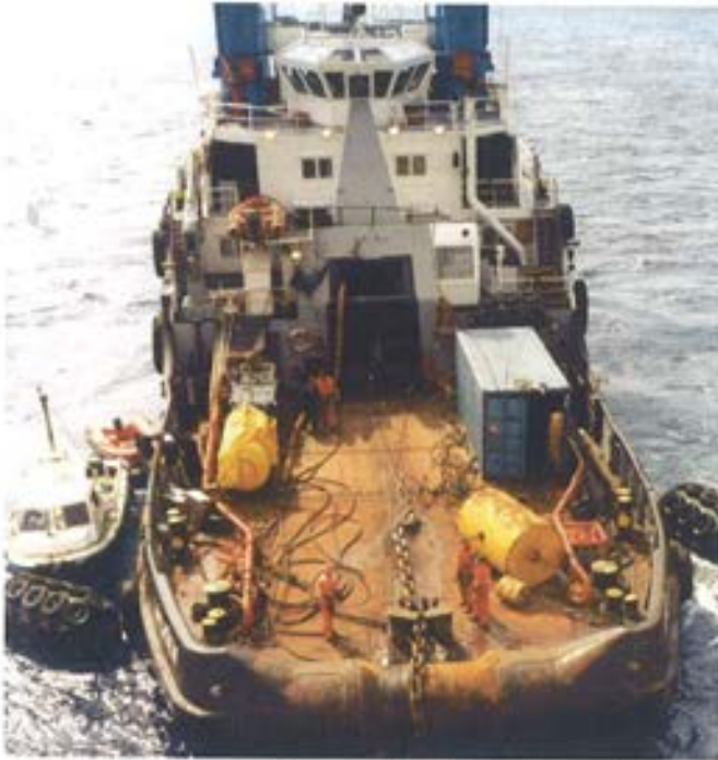
Figura 5.2.16. Vista de la operación de izado de una cadena.
