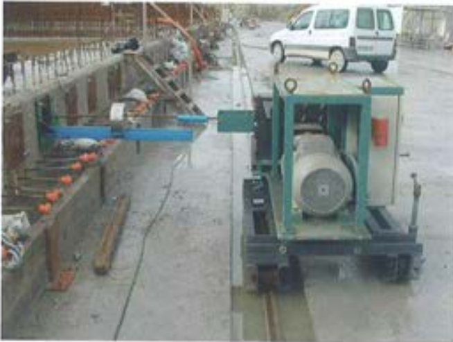
Figura 6.6.3.1. Enfiladora sobre carro de traslación.
