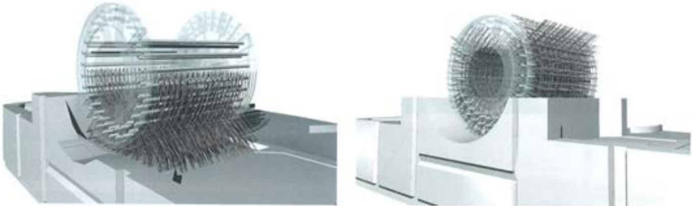
Figura 6.4.5. Fases de hormigonado de la rótula.
