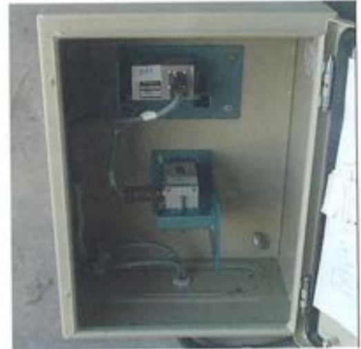
Figura 5.7.6. Servoclinómetro Jewell LSOC (Izquierda) y armario con los dos clinómetros instalados en la sección C (derecha).
