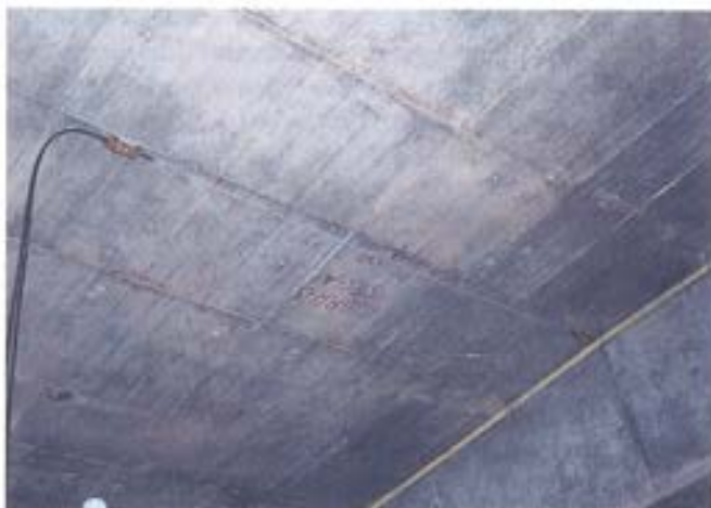
Figura 5.7.5. Sensor de fibra óptica instalado (izquierda) y una vez colocado el semitubo de PVC de protección (derecha).
