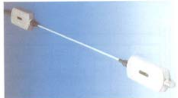
Figura 5.7.3. Extensómetros de fibra óptica de amplia base.
