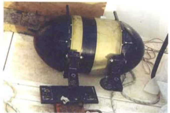
Figura 7.3.4. Cabeza sensora de la ecosonda SEABAT 8101.
