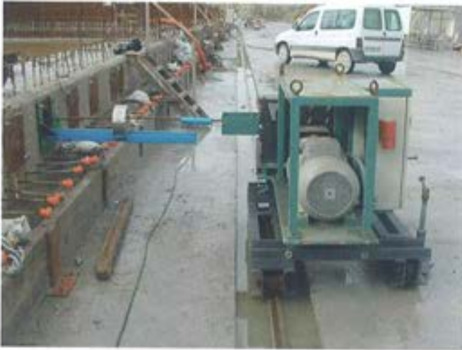
Figura 6.6.3.1. Enfiladora sobre carro de traslación.
