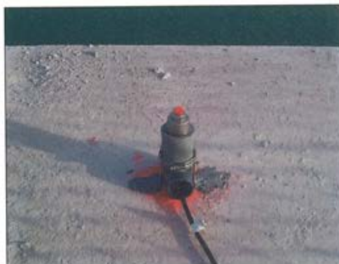
Figura 5.7.8. Sensores de presión hidrodinámica dispuestos en cubierta.
