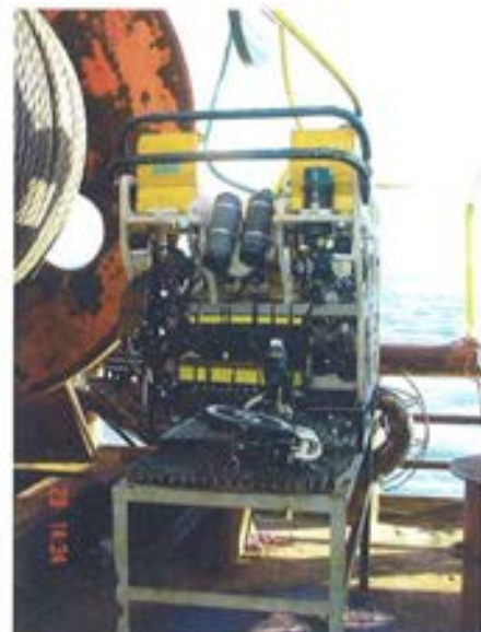
Figura 5.2.10. Vista del robot submarino utilizado para el control de la hincada de los pilotes.
