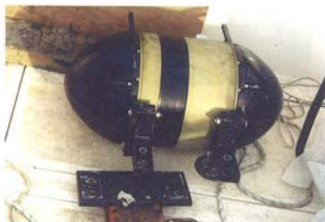
Figura 7.3.4. Cabeza sensora de la ecosonda SEABAT 8101.
