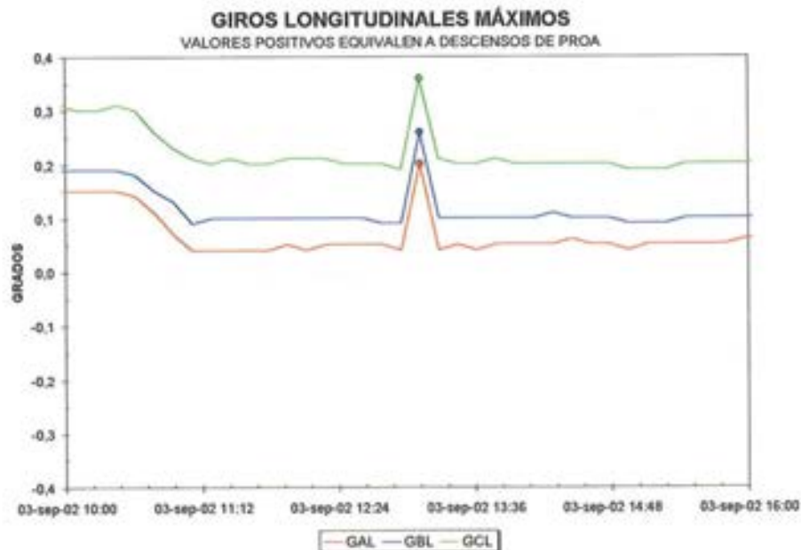
Figura 5.7.15 a). Giros longitudinales durante las operaciones de conexión de la rótula (3/09/02). Máximos registrados cada 10 minutos.
