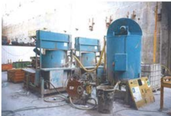
Figura 4.10. Equipo de inyección.
