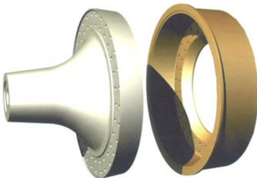
Figura 5.1.7. Perspectiva de la brida.
