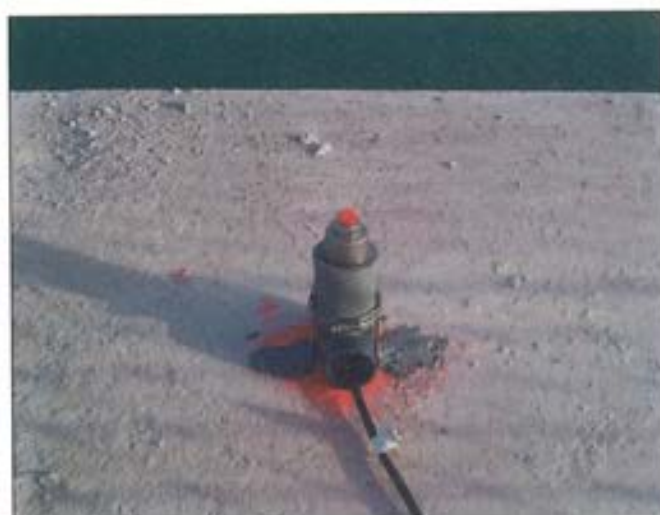
Figura 5.7.8. Sensores de presión hidrodinámica dispuestos en cubierta.
