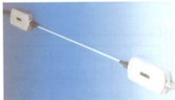
Figura 5.7.3. Extensómetros de fibra óptica de amplia base.
