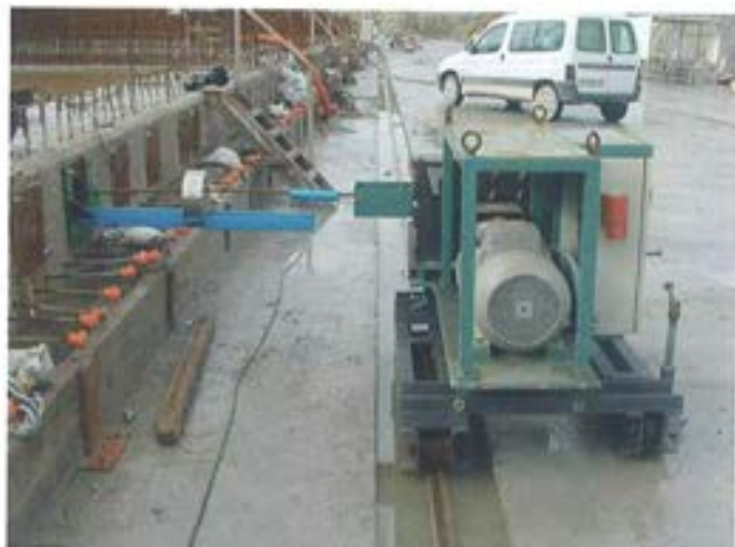
Figura 6.6.3.1. Enfiladora sobre carro de traslación.
