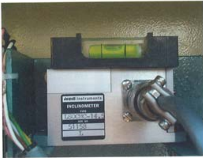
Figura 5.7.6. Servoclinómetro Jewell LSOC (Izquierda) y armario con los dos clinómetros instalados en la sección C (derecha).
