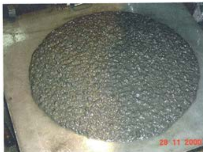
Figura 3.1.2. Formación de la torta de hormigón tras la finalización del ensayo.
