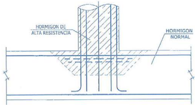
Figura 11. Arranque de soportes.
