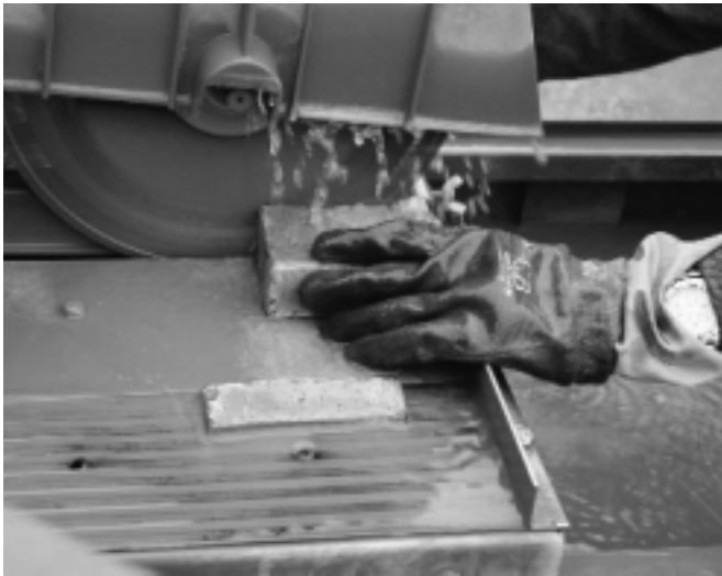
Figura 1. Obtención de los ladrillos a escala 1/4 a partir de ladrillos macizos comerciales.
