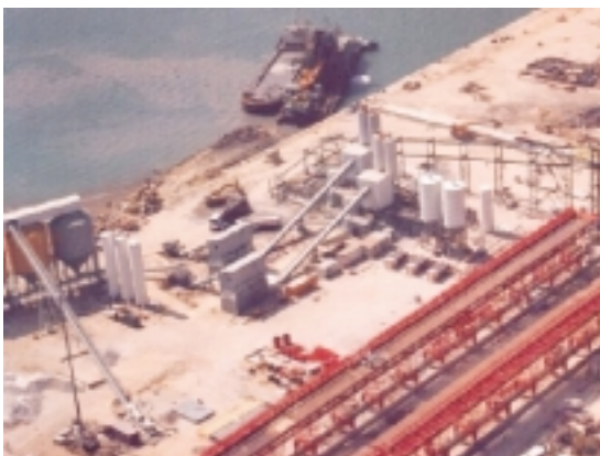
Fig. 29: Planta de hormigón con sistema de enfriamiento y pantalla de control de temperatura. Fig. 29: Concrete-mixing plant with cooling system and temperature-control display.
