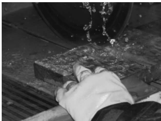
Figura 4. Obtención de las probetas compactas a partir de las mitades de viga ensayadas para medir la energía de fractura.
