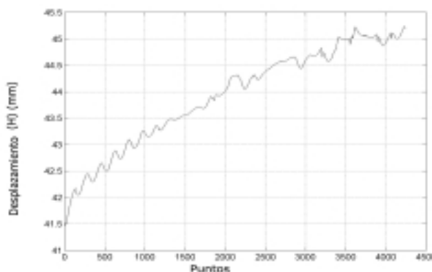
Figura 12. Desplazamiento de fluencia (un punto de datos son 500 segundos).
