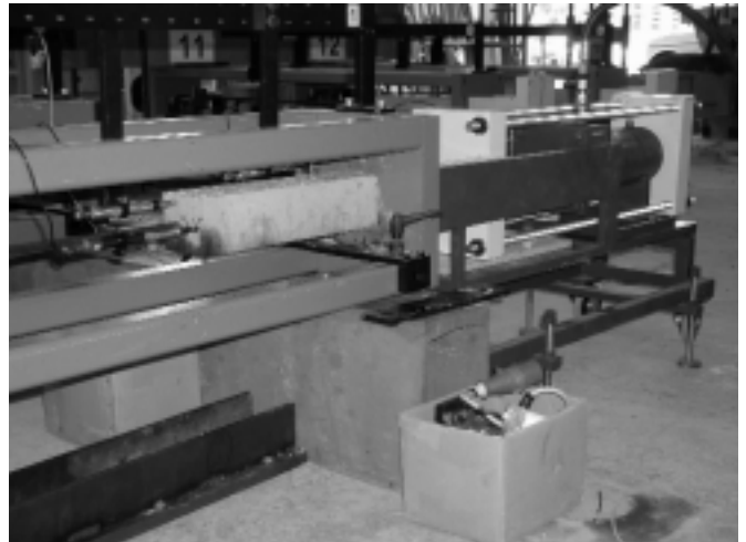
Fotografía 4. Acoplamiento del sistema hidráulico en el extremo de arrancamiento.
