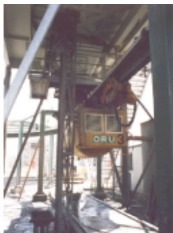
Fig. 14: Detalle de la vagoneta de hormigonado y de la máquina de acabado. Fig. 14: Detail of the concrete skip and finishing machine.
