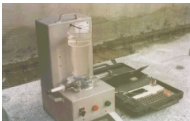
Fig. 23: Analizador de aire ocluido en hormigón fresco y distribución estadística (%) según tamaño de burbujas. Fig. 23: Analyser of entrained air in fresh concrete and statistical distribution (%) by bubble size.
