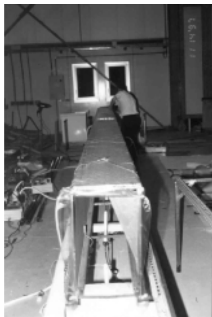
Foto 1. Proceso de curado del encofrado estructural.
