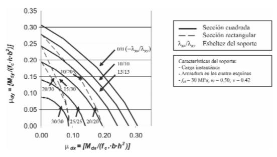
Figura 7. Influencia de la relación de lados en la capacidad resistente del soporte en flexo-compresión esviada.
