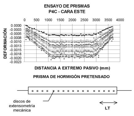
Figura 2. Evolución temporal de las deformaciones longitudinales medidas en el paramento de un elemento pretensado (prisma) con pretensado centrado (4)
