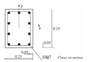
Figura 12. Ejemplo de aplicación. Sección transversal del soporte.
