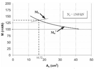
Figura 13. Ejemplo de aplicación. Cálculo de la cuantía de armadura.
