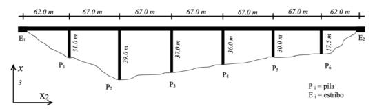
Figura 7. Esquema de la estructura del puente Warth, Austria.
