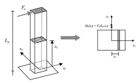
Figura 5. Modelo simplificado de análisis no lineal.
