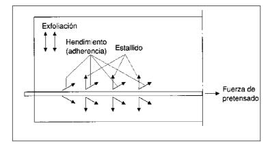
Figura 3. Tensiones transversales de tracción en elementos (3).
