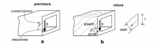
Figura 1. Estados de prerrotura y rotura en torsión.
