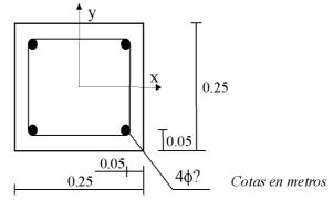
Figura 10. Ejemplo de aplicación. Sección transversal del soporte.
