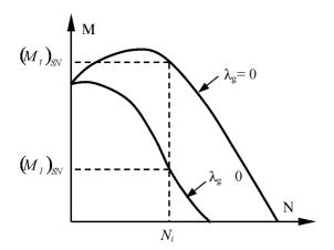
Figura 3. Método de Amplificación de Momentos.
