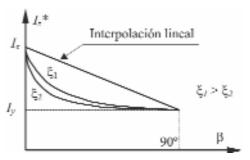
Figura 9. Influencia del coeficiente de interpolación  $\xi$  en la inercia  $I_{\bar{z}}$  de la sección transversal.
