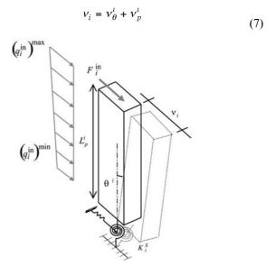
Figura 4. Deformación de la pila i.
