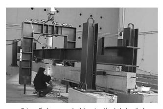
Fotografía 1: ensayo de determinación de la longitud de anclaje en vigas pretensadas de armadura pretesa (4).
