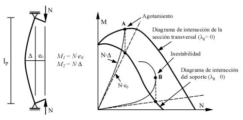
Figura 1. Diagrama de interacción de la sección transversal y del soporte.
