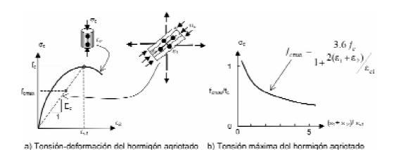
Figura 3. Relaciones tensión-deformación para el hormigón agrietado en compresión.
