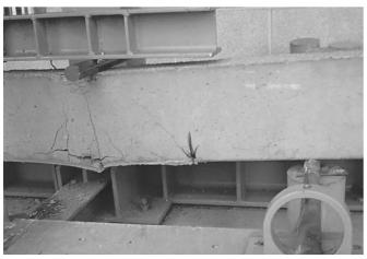
Foto 5. Rotura de la fibra. Rotura tipo 1.
