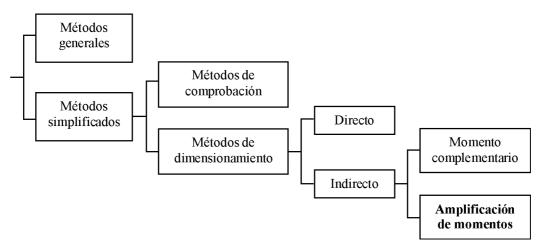
Figura 2. Métodos de cálculo de soportes aislados sometidos a solicitaciones de flexo-compresión recta.
