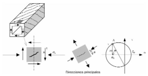
Figura 2. Tensiones tangenciales de torsión junto con tensiones normales.
