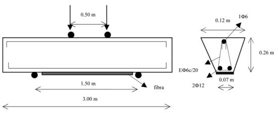
Figura 1. Esqumea de ensayo y sección transversal.
