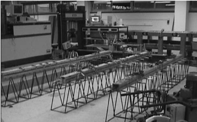
Fotografía 2: vigas pretensadas de pretensado centrado (4).
