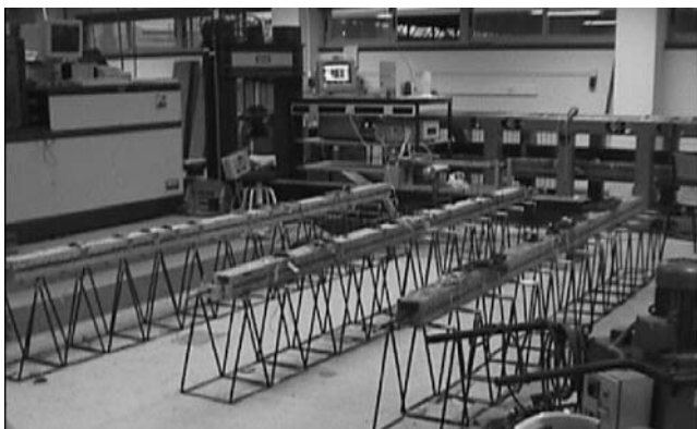
Fotografía 2: vigas pretensadas de pretensado centrado (4).
