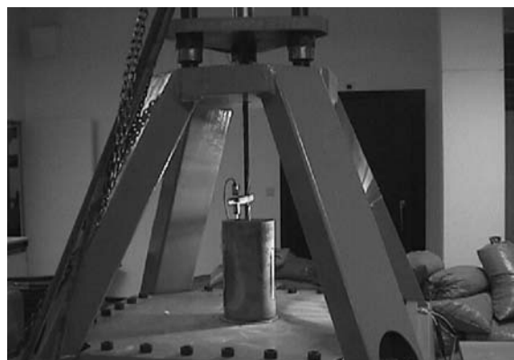
Fotografía 4. Ensayo de una probeta normalizada (4).
