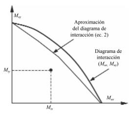
Figura 3. Aproximación del diagrama de interacción (M<sub>ux</sub>, M<sub>uy</sub>).
