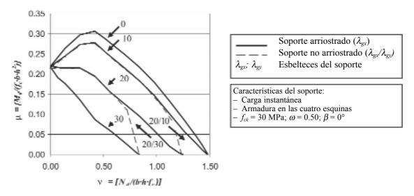
Figura 5. Influencia del arriostramiento transversal en el comportamiento de un soporte sometido a una solicitación de flexo-compresión recta respecto a su eje fuerte.
