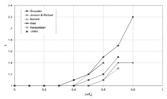
Gráfico 4. Valores del coeficiente  $\eta$  para las diferentes series experimentales analizadas.
