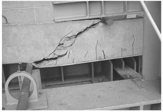
Foto 3. Rotura por cortante desde el extremo de la fibra. Rotura tipo 8.
