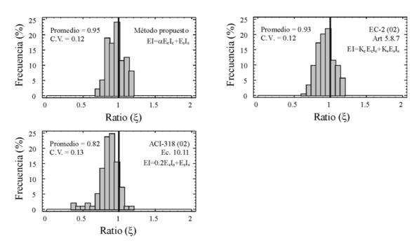
Figura 8. Comparación de distintos métodos simplificados para el análisis de soportes sometidos a cargas instantáneas.
