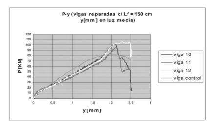
Figura 2. Curvas de vigas prefisuradas y reparadas.
