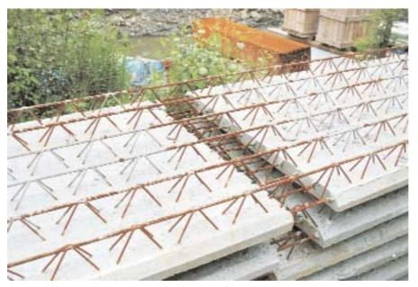
Figura 11. Prelosas. Figure 11. Preslabs.
