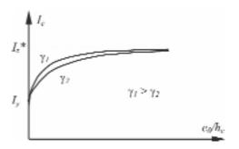
Figura 8. Influencia del coeficiente de interpolación  $\gamma$  en la inercia equivalente  $I_{\rm e}$  del soporte
