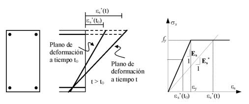
Figura 5. Comportamiento de la sección frente a cargas sostenidas.
