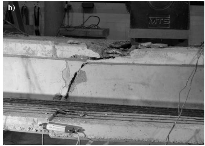
Figura 17. Ensayo V1-PC-70. Fase de prerrotura (a) y rotura (b).
