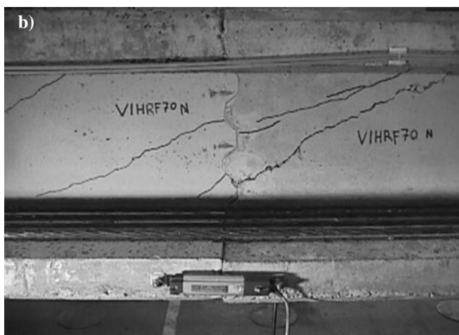
Figura 18. Ensayo V1-SFRC-70. Fase de prerrotura (a) y viga descargada (b).
