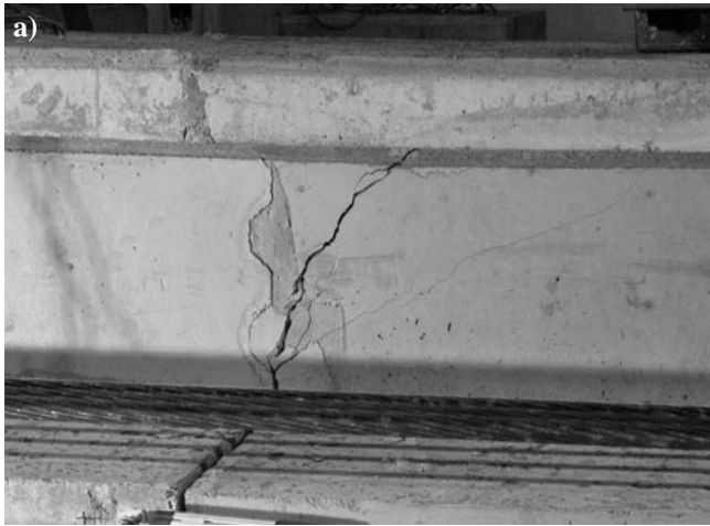
Figura 17. Ensayo V1-PC-70. Fase de prerrotura (a) y rotura (b).
