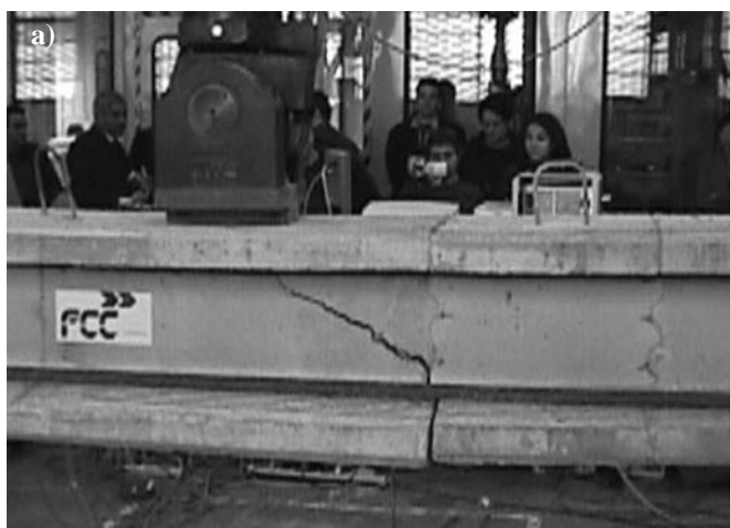
Figura 18. Ensayo V1-SFRC-70. Fase de prerrotura (a) y viga descargada (b).
