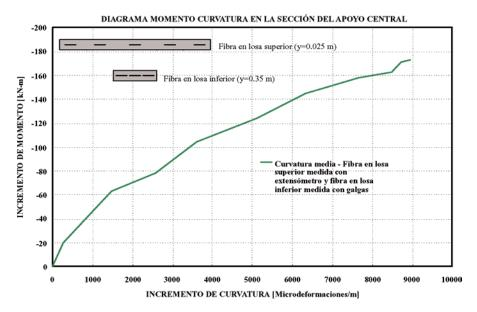
Figura 17. Diagrama momento-curvatura en la sección del apoyo.
