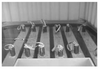
Figura 6. Vigas sumergidas en una disolución de cloruro sódico al 5 %.
