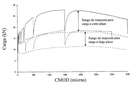
Figura 16. Comportamiento carga-CMOD a largo y corto plazo.
