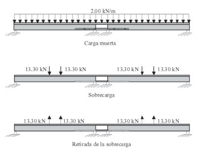
Figura 11. Magnitud de las cargas aplicadas durante el ensayo diferido.
