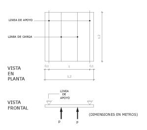
Figura 6. Primer sistema de carga.
