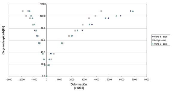
Figura 4.4.4. Diagrama carga-deformación viga VH2.
