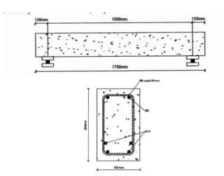
Figura 2. Dimensiones y armaduras de las vigas ensayadas.
