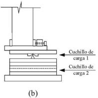
Figura 4. Detalle de la aplicación de la carga axial en extremos del soporte.
