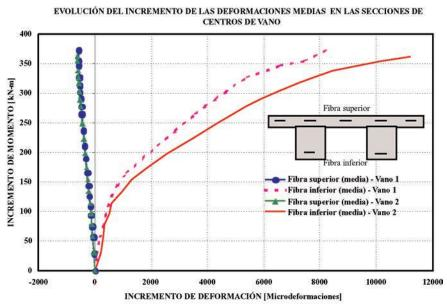
Figura 14. Evolución del incremento de las deformaciones medias en las secciones de los centros de vano.
