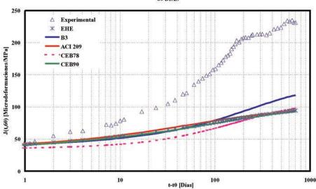
Figura 19. Función de fluencia del hormigón de las losas.
