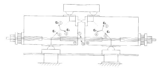
Figura 8. Croquis de posición de las bandas extensométricas del hormigón y acero.
