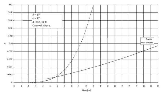
Figura 12. Cuantía de armadura longitudinal necesaria por flexión y por cortante en un muro de contención (β=15°).
