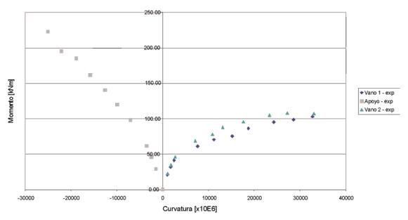
Figura 4.3.3. Diagramas momento-curvatura de secciones de centro de vanos y apoyo de la viga VH2.
