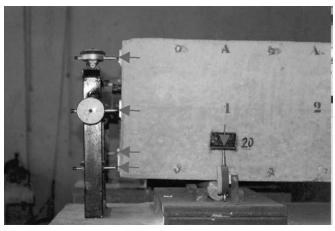
Foto 1. Flexímetros situados en la sección extrema para la obtención del giro de la sección de apoyo extremo.
