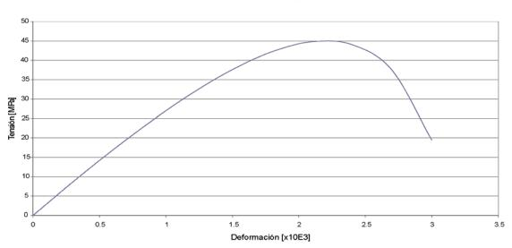
Figura 5.3. Contrastación del modelo teórico FHdc. Ecuación constitutiva del hormigón.
