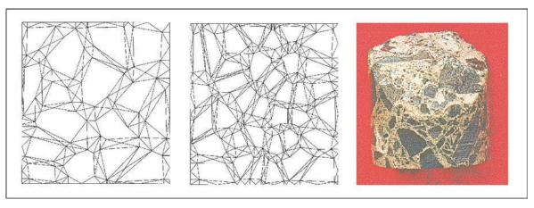
Figura 6.- Disposición de las juntas en la malla adoptada, para el arreglo de 4x4 (izquierda) y el de 6x6 (central). Realidad de la presa, testigo de la misma (derecha).
