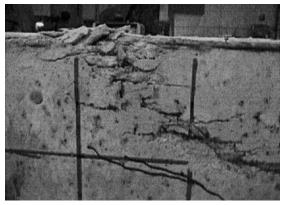
Figura 19.Modo de falla para el caso de una viga de 20 x 30 cm de HRFA.
