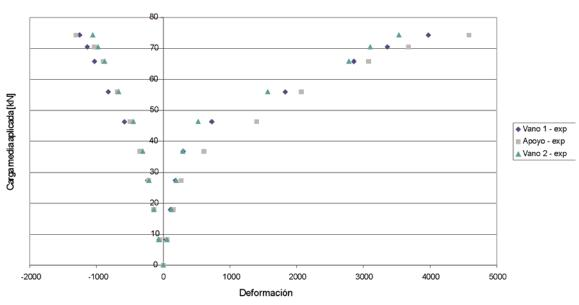
Figura 4.4.2. Diagrama carga-deformación viga VH1.
