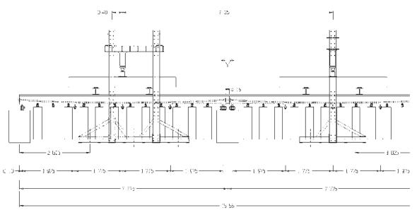
Figura 12. Esquema de posición de los pórticos y gatos que transmiten la carga.
