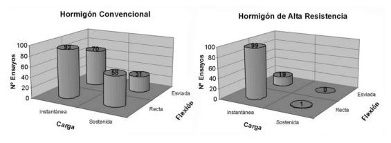
Figura 2. Número de ensayos según el tipo de carga.
