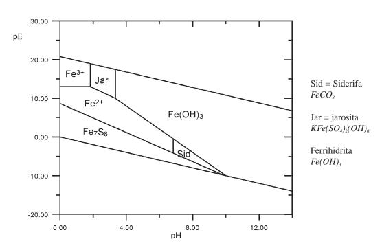
Figura 4.- Campos de estabilidad de las diferentes especies involucradas en la oxidación de la pirrotina (Fe,S<sub>8</sub>), para valores de  $P_{CO_2} = 10^{-2}$ ,  $a_{Fe}^{2+} = 10^{-4}$  y  $a_{SO_2^2} = 10^{-2}$
