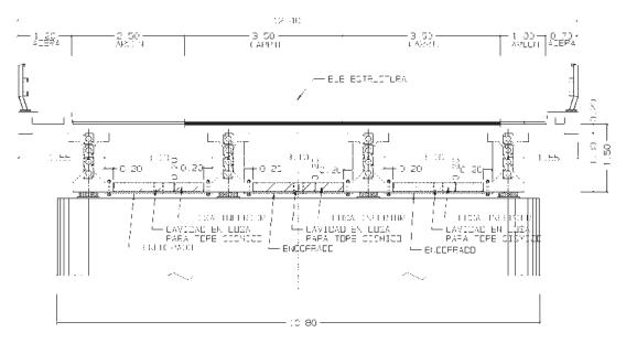
Figura 3. Sección de apoyos del puente sobre el Río Bureo.
