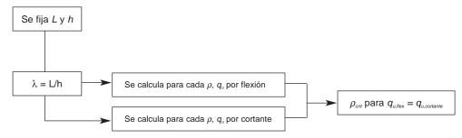
Figura 3. Metodología para caracterizar losas con posibles problemas de rotura prematura por cortante.
