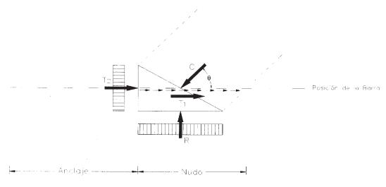
Figura 2. Distribución de esfuerzos en el hormigón.
