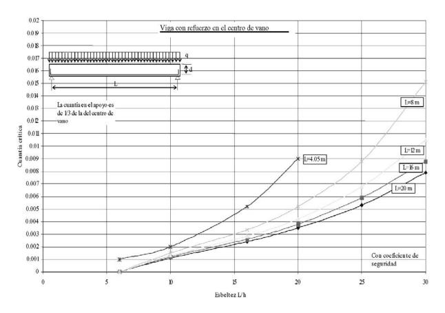
Figura 4. Cuantía crítica en losas simplemente apoyadas en función de la esbeltez y la luz. Armadura constante.
