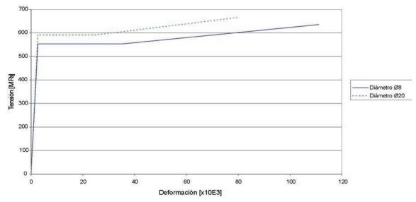
Figura 5.1. Contrastación del modelo teórico FHdc. Ecuación constitutiva de la armadura pasiva.
