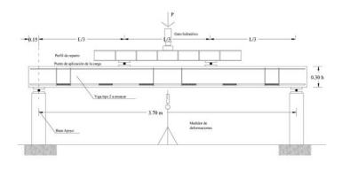
Figura 22. Ensayo y esquema de carga de la viga tipo 2.
