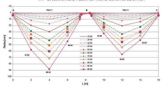
Figura 4.1.1. Evolución de las flechas a lo largo de la viga VH1 durante el ensayo (Se consignan valores nominales de la carga aplicada).
