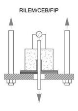
Figura 4. Ensayos de adherencia tipo pull-out.
