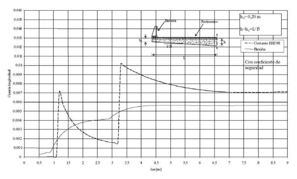
Figura 8. Cuantía longitudinal necesaria por flexión y por cortante sin armadura transversal, según la EHE.
