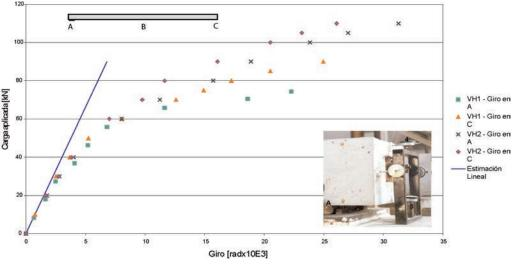
Figura 4.2.1. Evolución del giro en los apoyos extremos de las vigas VH1 y VH2 durante el ensayo.
