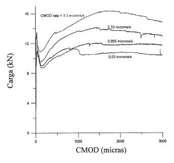
Figura 14. Curvas carga-CMOD para distintas velocidades de carga.
