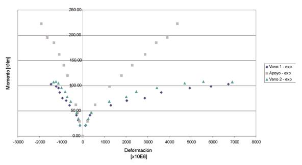
Figura 4.3.4. Diagramas momento-deformación de secciones de centro de vanos y apoyo de la viga VH2.
