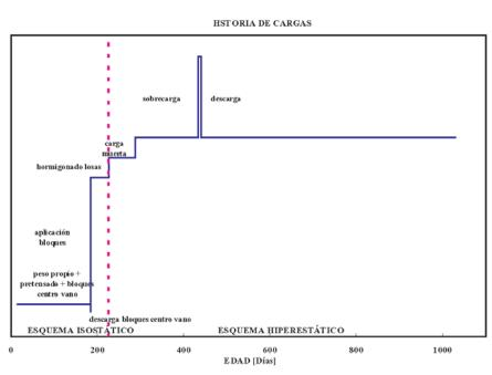
Figura 10. Esquema general de las cargas aplicadas al modelo.
