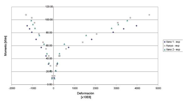
Figura 4.3.2. Diagramas momento-deformación de secciones de centro de vanos y apoyo de la viga VH1.
