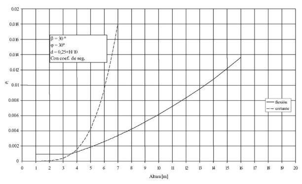
Figura 13. Cuantía de armadura longitudinal necesaria por flexión y por cortante en un muro de contención ( $\beta$ =30°).
