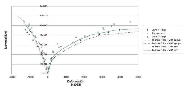
Figura 5.5. Contrastación del modelo teórico FHdc – Viga VH1. Diagrama momento-deformaciones.
