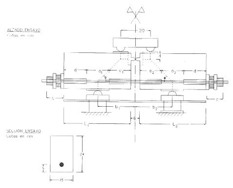
Figura 5. Crorquis de la probeta a ensayar.
