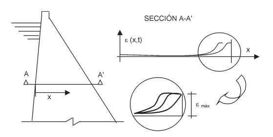
Figura 9.- Distribución no lineal de deformaciones
