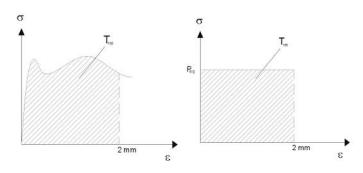
Figura 4 Idealización del comportamiento a flexotracción.
