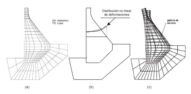
Figura 9.- Malla de EF para bloque 5 de la presa de Graus: a) discretización adoptada, b) distribución no lineal de deformaciones y c) Deformada por las acciones expansivas.
