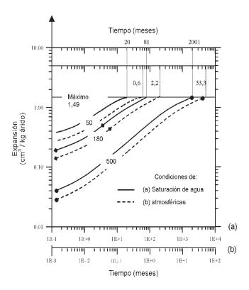
Figura 5.- Modelos de expansión por oxidación de partículas de sulfuro (50, 100 y 500 µm) en condiciones de (a) saturación de agua y (b) atmosféricas.
