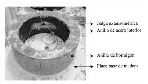
Figura 12. Configuración del ensayo de retracción restringida.
