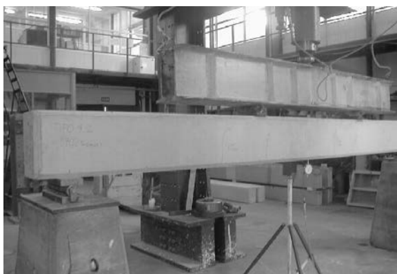
Figura 22. Ensayo y esquema de carga de la viga tipo 2.
