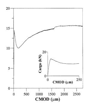
Figura 2. Curva carga-flecha (izquierda) y carga-apertura de fisura (derecha) para un hormigón H30 con 40 kg/m³ de fibras de 60 mm de longitud y 0,75 mm de diámetro.
