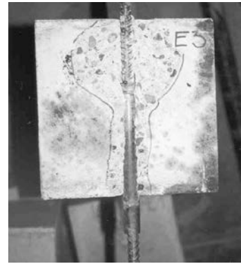
Figura 12. Fisuración del recubrimiento. Alzado lateral (probeta E3).
