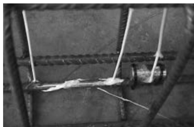
Figura 3. Detalle de los 3 tipos de sensor de fibra óptica para detección de corrosión colocados en la armadura: helicoidal sobre barra (en el centro), radial (a la izquierda) y helicoidal sobre testigo (a la derecha).
