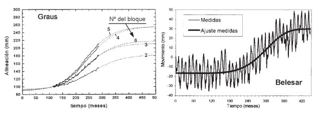
Figura 3. Movimientos de las alineaciones de coronación en diferentes bloques de la presa de Graus y de la presa de Belesar.
