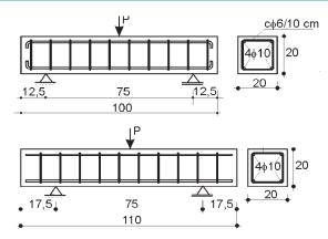
Figura 17 . Geometría y armado de las vigas de pequeña esbeltez.
