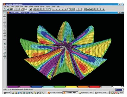
Figura 17. Salida del programa de cálculo en donde se aprecia el estado tensional de la lámina en un estado de carga.
