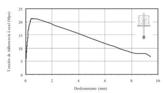
Figura 10. Curva completa adherencia deslizamiento en un ensayo  $con \phi = 12 mm$
