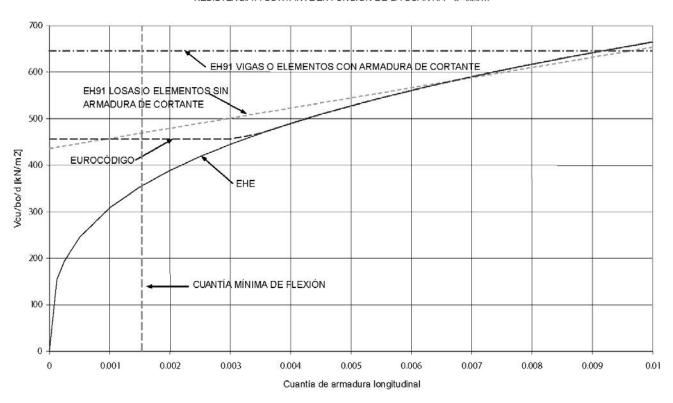
Figura 1 – Comparación modelos de cortante EH-91 y EHE. d=0.25 m.
