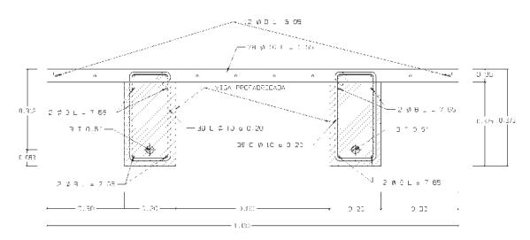
Figura 4. Sección de centro de vano del modelo.
