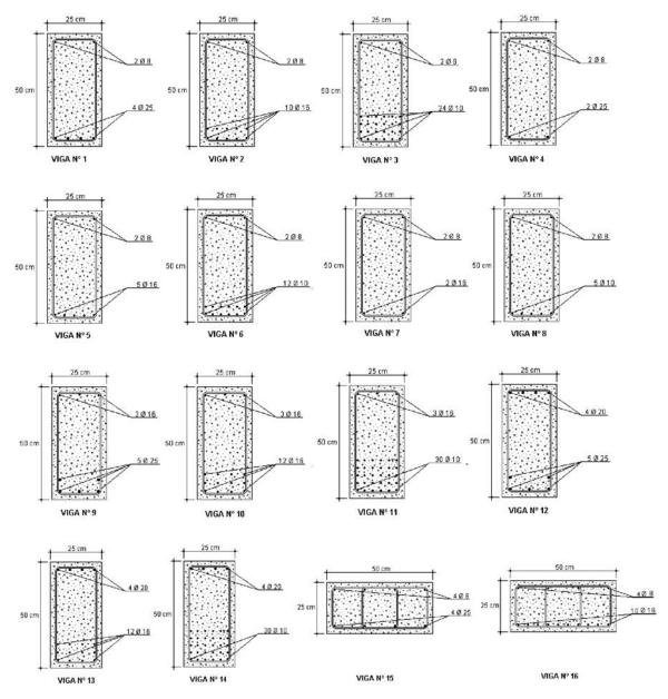
Figura 3. Secciones transversales de las vigas ensayadas
