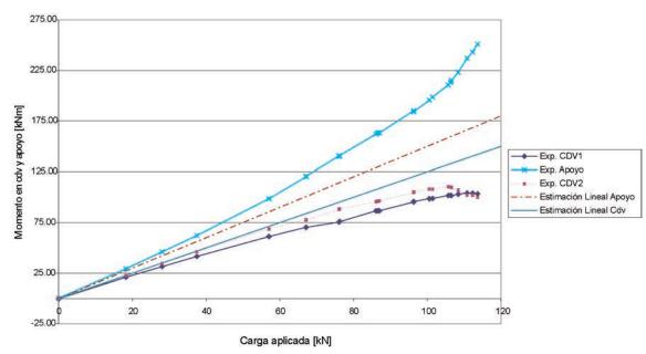
Figura 4.4.3. Diagrama carga-momento viga VH2.
