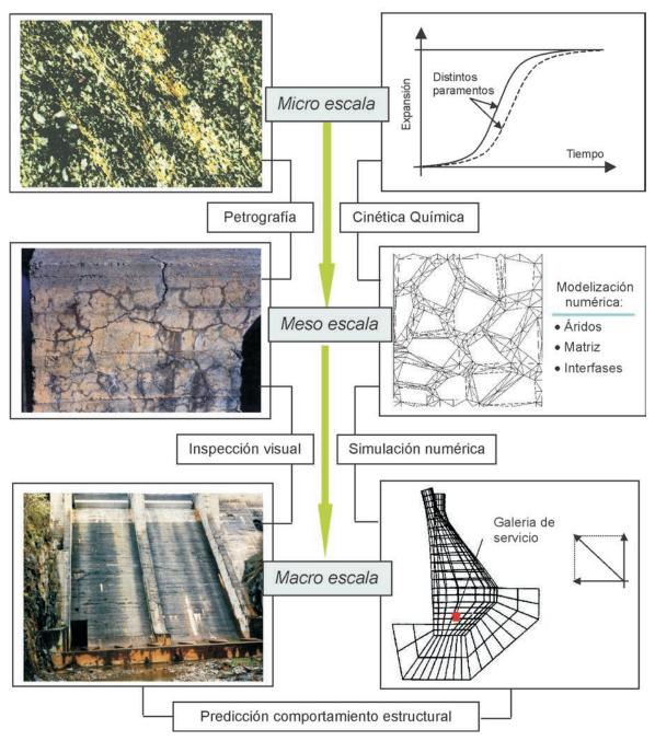
Figura 1.- Esquema del modelo global utilizado en el análisis
