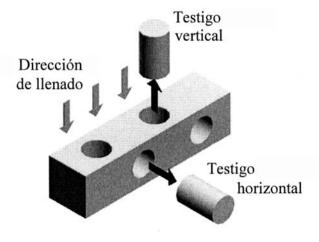
Figura 5. Extracción de testigos.
