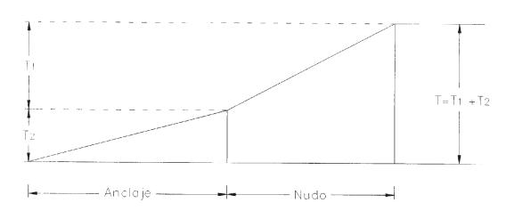
Figura 4. Variación de la fuerza en la armadura en el conjunto Nudo-Anclaje.
