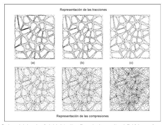
Figura 8.- Tensiones principales en la malla de 6x6: de tracción en fila superior, de compresión en la fila inferior para: a) expansión libre, b) y c) expansión uniforme con incrementos de presiones de confinamiento en los bordes.
