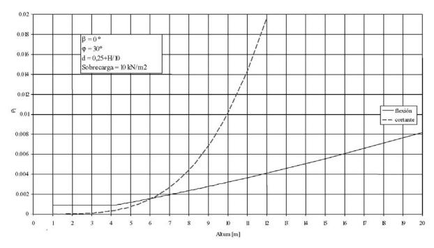
Figura 11. Cuantía de armadura longitudinal necesaria por flexión y por cortante en un muro de contención (β=0).
