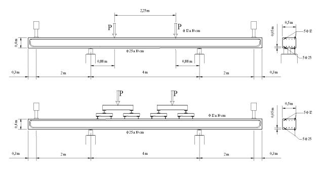
Figura 20. Esquema propuesto para ensayo de cortante hiperestático [10].
