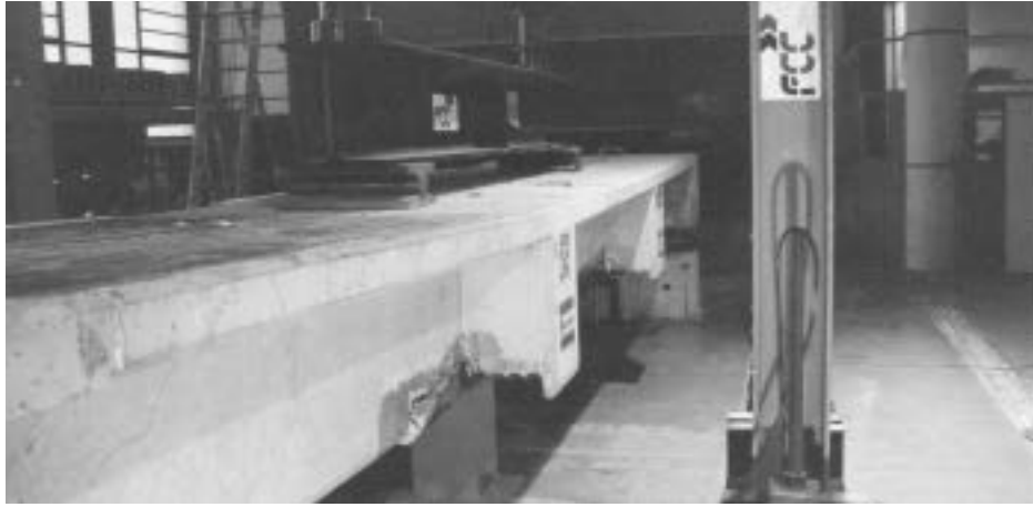
Figura 9. Vista del ensayo realizado sobre un modelo de dos vanos reforzado con fibra de carbono.
