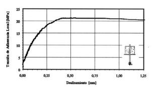
Figura 8. Curva de adherencia local/deslizamiento.
