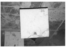
Figura 11. Fisuras radiales en el extremo pasivo (splitting) (probeta D2).
