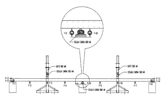
Figura 1. Esquema del ensayo en rotura.
