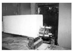
Figura 15. Captadores de desplazamiento.
