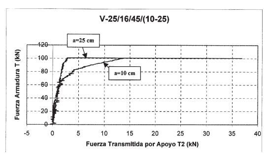
Figura 10. Relación entre el esfuerzo de tracción en la armadura y la fuerza transmitida en el apoyo.
