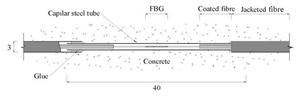
Figura 5. Principio de funcionamiento del sensor de fibra óptica para temperatura.
