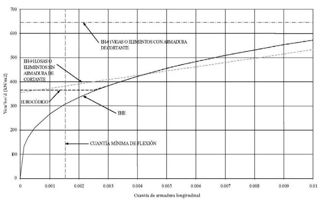
Figura 2 – Comparación modelos de cortante EH-91 y EHE. d=0.50 m.
