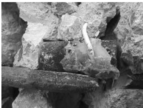
Figura 13. Posición del sensor y estado de las armaduras en una de las vigas ensayadas.
