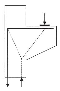
Figura 1. Anclaje en punta de una ménsula corta. Esquema resistente de bielas y tirantes.
