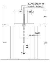
Figura 5. Dispositivo de ensayo.
