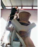
Figura 12. Introducción de las fibras y el aditivo
