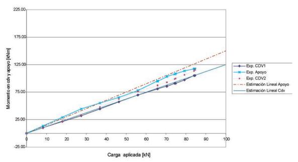
Figura 4.4.1. Diagrama carga-momento viga VH1.
