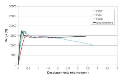
Figura 16. Comparación de desplazamiento entre los resultados experimentales y los del modelo teórico. Segundo sistema de carga con 50 kg/m³ de fibras.
