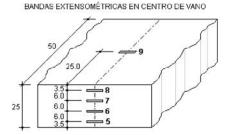
Figura 2 Disposición de bandas extensómetricas
