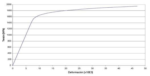
Figura 5.2. Contrastación del modelo teórico FHdc. Ecuación constitutiva de la armadura activa.
