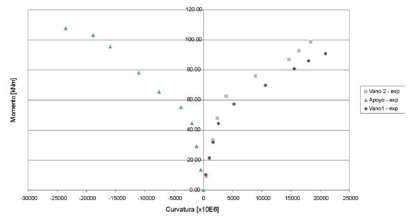
Figura 4.3.1. Diagramas momento-curvatura de secciones de centro de vanos y apoyo de la viga VH1.
