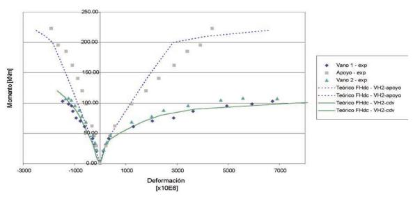
Figura 5.7. Contrastación del modelo teórico FHdc – Viga VH2. Diagrama momento-deformaciones.
