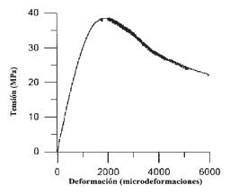
Figura 11. Respuesta tensión-deformación uniaxial en compresión.
