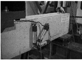
Figura 18. Modo de falla para el caso de una viga de 20 x 30 cm de hormigón sin fibras.
