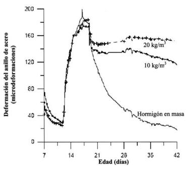
Figura 13. Deformación del anillo de acero interior conforme transcurre el ensayo.
