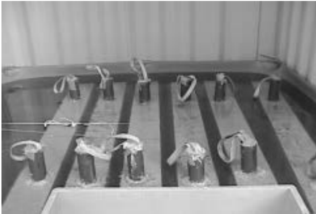
Figura 6. Vigas sumergidas en una disolución de cloruro sódico al 5 %.
