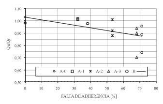
Figura 19. Relación entre Q<sub>u</sub>/Q<sub>r</sub> y falta de adherencia.
