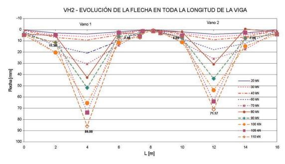
Figura 4.1.2. Evolución de las flechas a lo largo de la viga VH2 durante el ensayo (Se consignan valores nominales de la carga aplicada).
