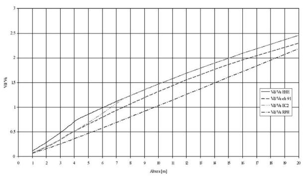
Figura 14. Vd/Vu en función de la altura del muro. Comparación entre distintas normativas (β=0).
