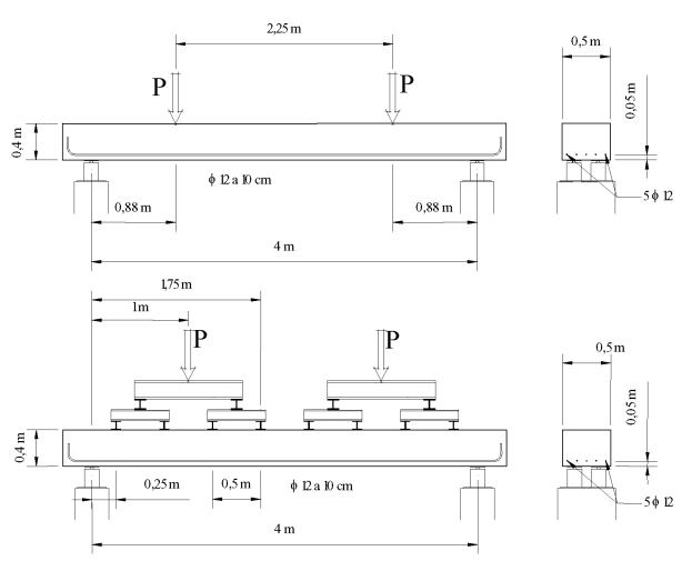
Figura 19. Esquema propuesto para ensayo de cortante isostático [10].
