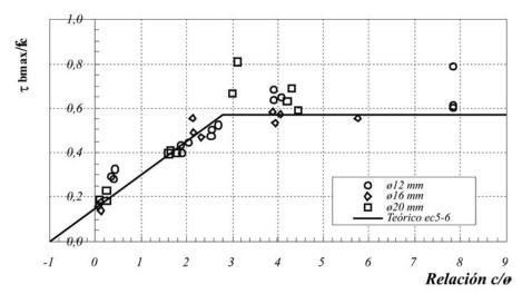
Figura 13. Efecto del espesor del recubrimiento en la máxima tensión de adherencia local.
