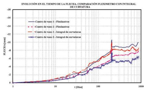
Figura 21. Evolución en el tiempo de la flecha total en las secciones de centros de vano. Flexímetros e integral de curvaturas.
