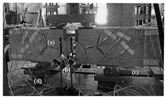
Fotografía 2. a) Bandas extensométricas, b) Captadores de desplazamiento, c) Regla graduada d) Célula de carga en apoyo.
