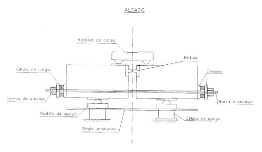
Figura 6. Croquis de sistema de apoyo y carga de la probeta.
