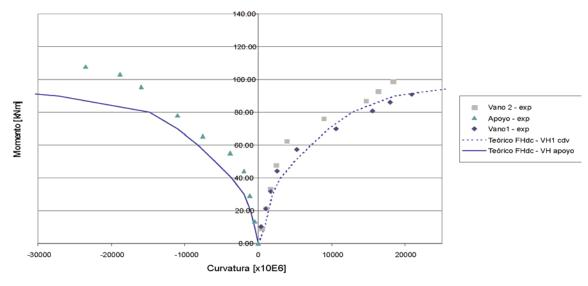
Figura 5.4. Contrastación del modelo teórico FHdc – Viga VH1. Diagrama momento-curvatura.
