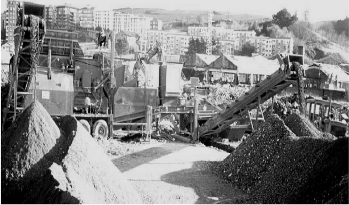
Fotografía 2. Separación de contaminantes y machaqueo.
