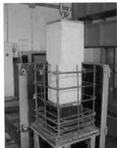
Figura 9. Detalle del pilar en molde y armado.
