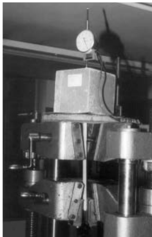
Fig. 1. Disposición del ensayo de arrancamiento.
