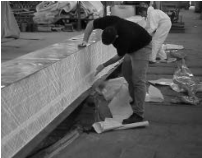
Figura 11: Detalle de la colocación de una banda de GFRP sobre el molde.
