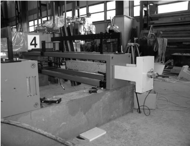
Figura 4. Vista del bastidor de pretensado y del sistema acoplado al extremo de la probeta.
