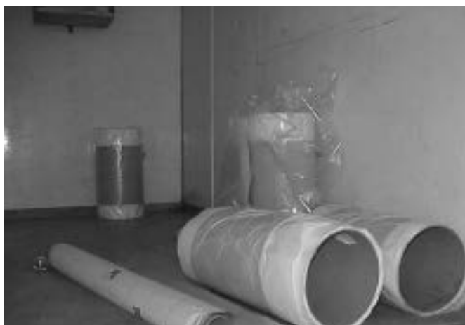
Figura 1: Rollos de GFRP y CFRP en el interior de un camión congelador.
