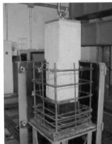
Figura 9. Detalle del pilar en molde y armado.
