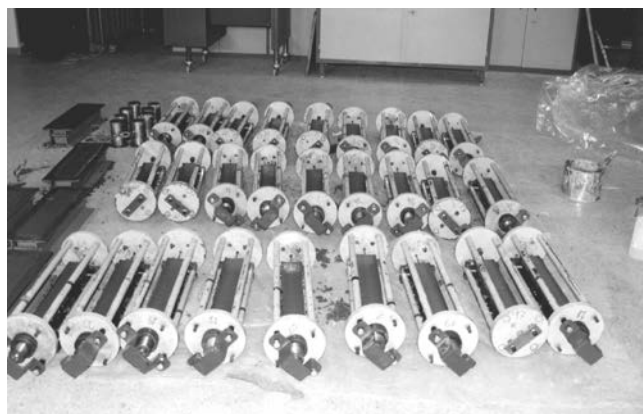
Figura 7. Probetas de hormigón pretensado una vez hormigonadas.
