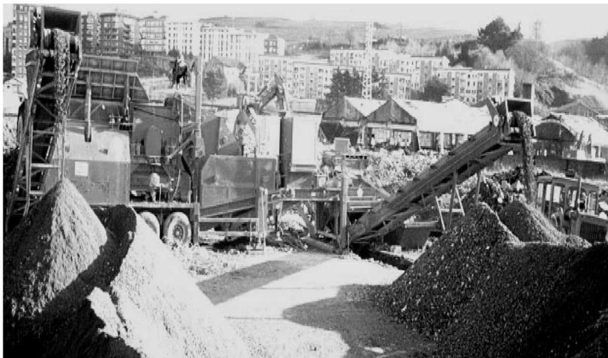
Fotografía 2. Separación de contaminantes y machaqueo.
