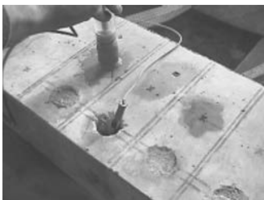
Fotografía 5. Medición de Potencial.
