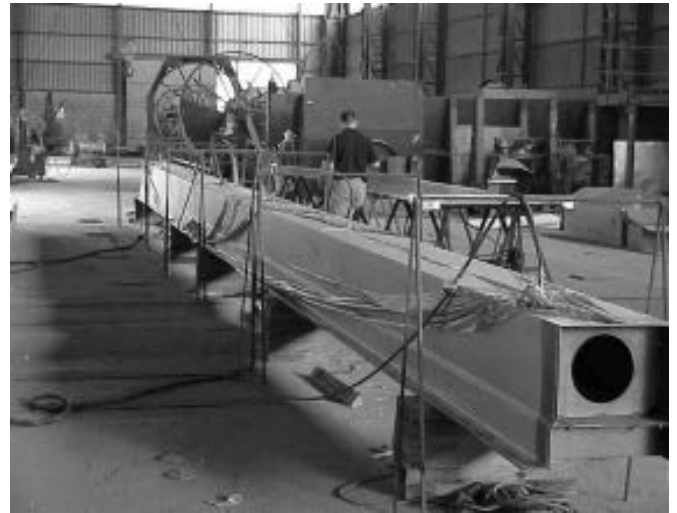
Figura 13: Vista general del compactado al vacío de las capas.
