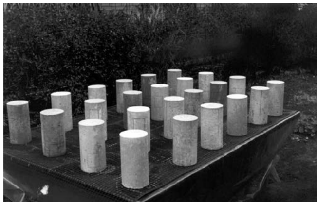
Fotografía 1. Probetas de Hormigón Coloreado expuestas a intemperie.
