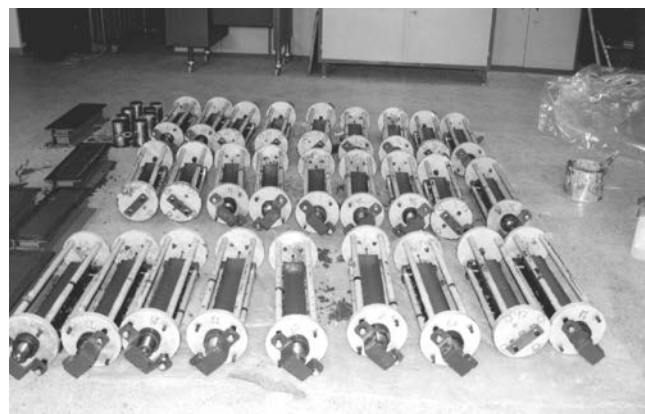
Figura 7. Probetas de hormigón pretensado una vez hormigonadas.
