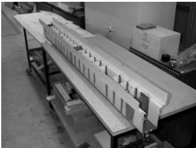
Figura 6: Vista general de una viga a escala reducida (cortesía de la Universidad de Surrey, RU).
