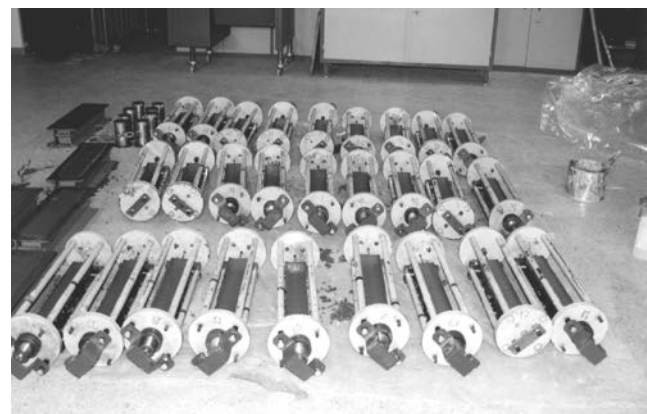
Figura 7. Probetas de hormigón pretensado una vez hormigonadas.
