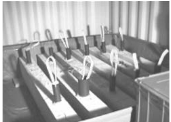
Fotografía 4. Disposición de las vigas y de las cajas con las probetas.
