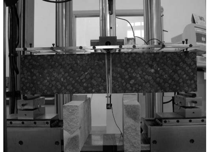
Figura 2. Ensayo para la medida de la energía de fractura en una probeta con las hiladas a 45°.
