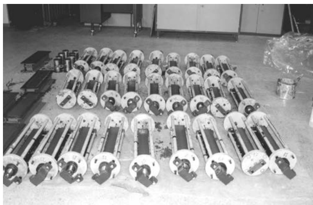
Figura 7. Probetas de hormigón pretensado una vez hormigonadas.
