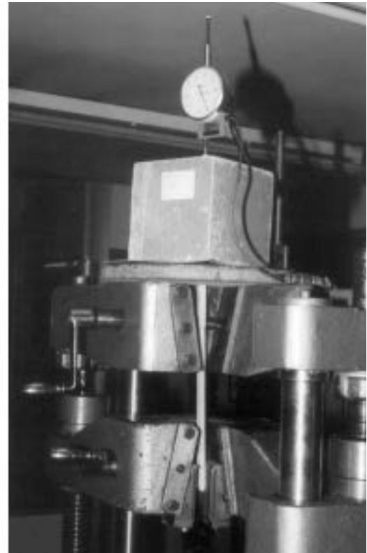
Fig. 1. Disposición del ensayo de arrancamiento.
