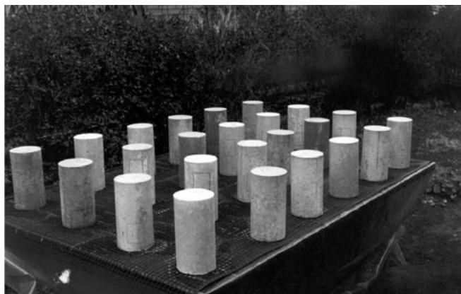
Fotografía 1. Probetas de Hormigón Coloreado expuestas a intemperie.
