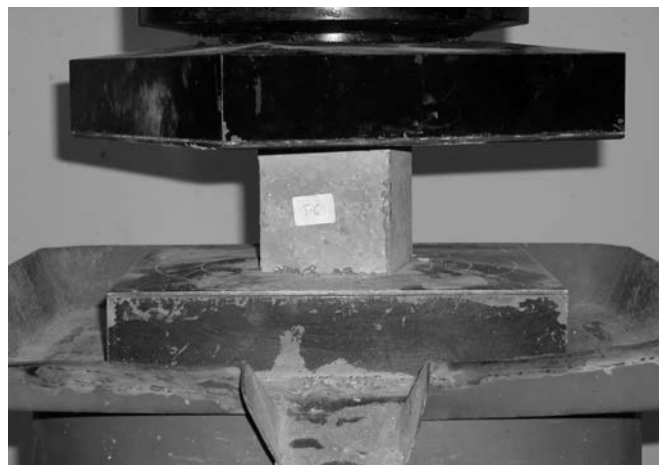
Figura 2. Ensayo a compresión simple en probeta cúbica de 10 cm de arista.
